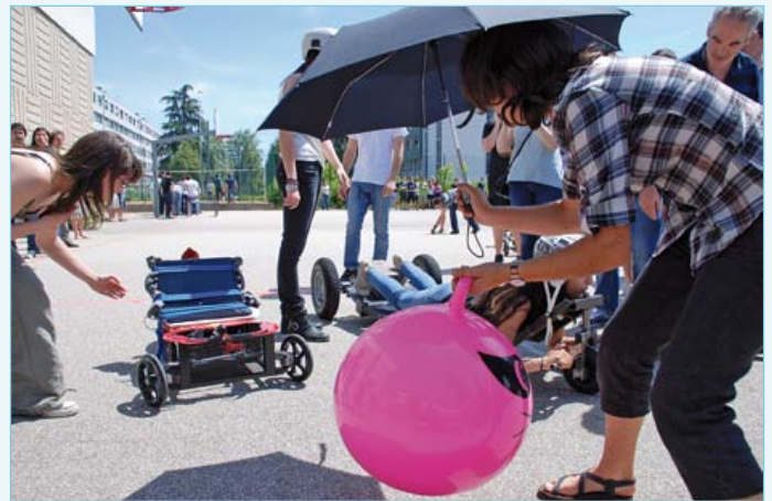
Figure 6 : Scorpio du groupe Eurinsa2. Les mêmes E-Blocks sur la même platine que le groupe 42 sont embarqués, mais ici une webcam permet de suivre le ballon rose! Les données sont traitées par l'ordinateur embarqué puis sont envoyées vers le véhicule par WiFi.
