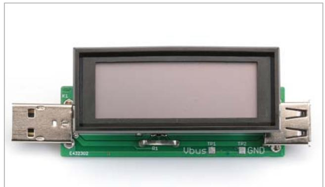
concevoir un circuit détecteur de courant dans la ligne positive, comme un amplificateur opérationnel standard ou un amplificateur de mesure avec quelques résistances. Nous avons opté pour un circuit intégré de type TS101, spécialement prévu pour la détection
