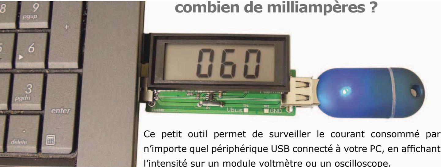
Ce petit outil permet de surveiller le courant consommé par n'importe quel périphérique USB connecté à votre PC, en affichant l'intensité sur un module voltmètre ou un oscilloscope.
