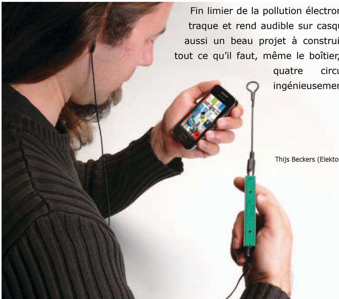
Fin limier de la pollution électromagnétique qu'il traque et rend audible sur casque, le TAPIR est aussi un beau projet à construire, un kit avec tout ce qu'il faut, même le boîtier, qui est fait de quatre circuits imprimés ingénieusement assemblés.
