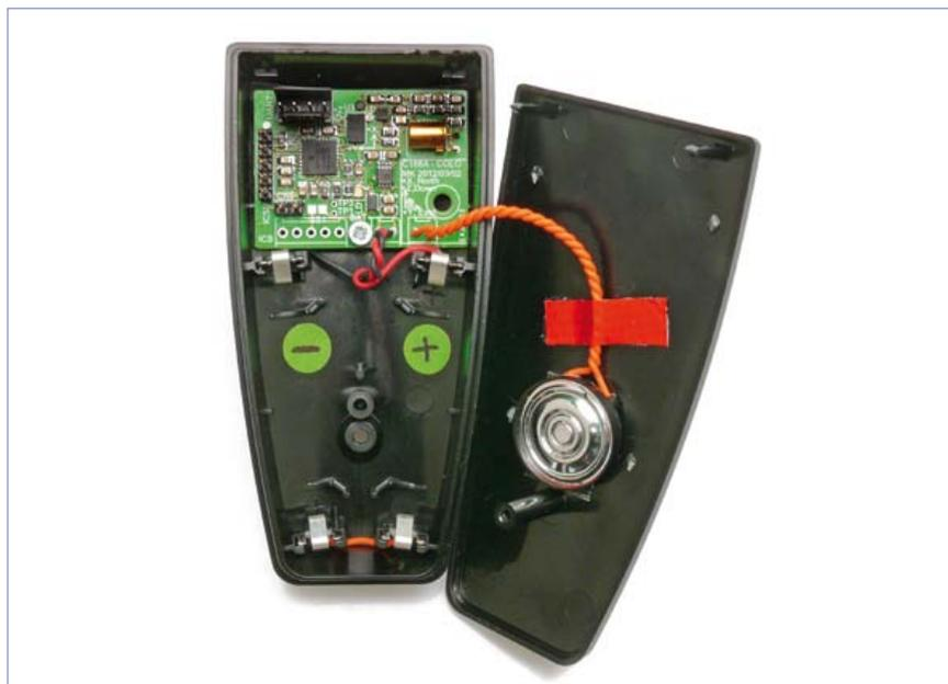
Figure 7. Mon prototype. Le magnétomètre est extrêmement sensible et subit l'influence de l'aimant permanent du haut-parleur. Je les ai éloignés le plus possible l'un de l'autre, sinon la saturation totale du magnétomètre interdirait toute mesure valable. Le champ magnétique permanent de l'aimant du HP reçu par le capteur est malgré tout relativement élevé, mais l'algorithme de compensation permet d'en annuler les effets.
