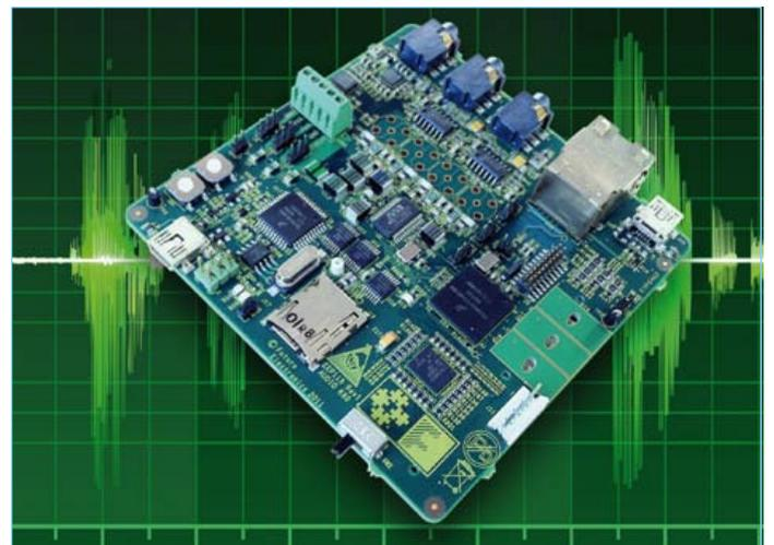
Photo 1. Pour sa carte de streaming audio, *Future Electronics* s'appuie sur Kinetis K60 de *Freescale* avec un cœur ARM Cortex-M4.
