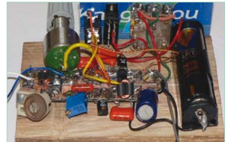
Figure 4. Le prototype assemblé sommairement sur une planchette en bois avec un morceau de carte de crédit qui tient lieu de face avant.
