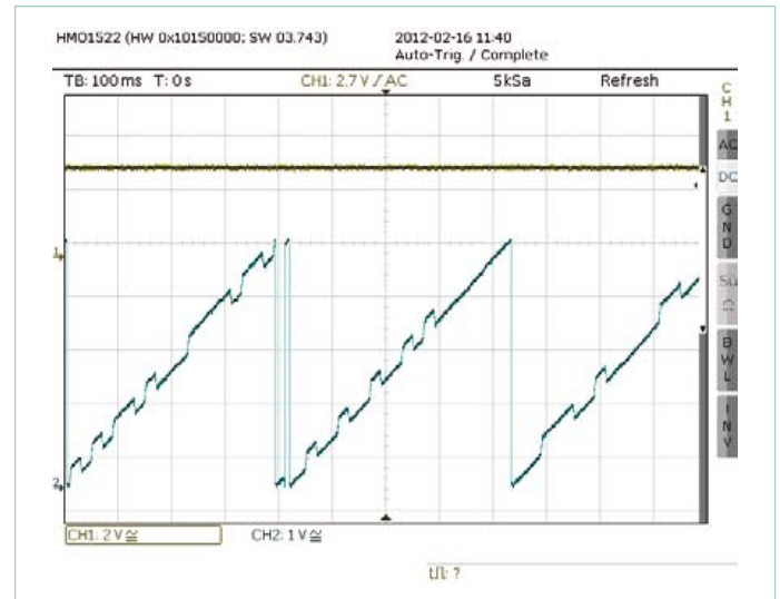
Figure 12. Une pure modulation de phase : amplitude en vert-jaune, phase en bleu.
