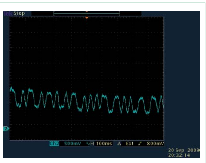
Figure 8. Modulation de phase d'un émetteur de la BBC.
