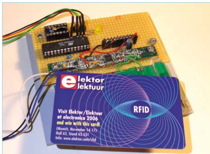
Figure 4. Prototype construit avec un ATmega88 et une platine de lecteur à PN512.
