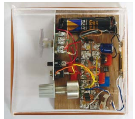
Figure 6. Le proto vu de dessus avec sa plaquette de cuivre gravée (voir aussi figure 2), dans son cadre à air, en position replié.
