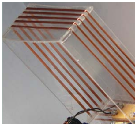
Figure 5. Le cadre sur support en plexi est muni aux quatre coins d'encoches espacées de 5 mm pour guider les enroulements.
