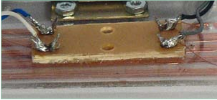
Figure 7. Détail du connecteur du cadre à air.
