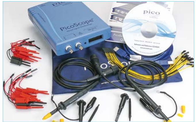
Associez un oscilloscope et un analyseur logique, vous aurez un oscilloscope à signaux mixtes (MSO) qui, sur un même écran, affiche signaux analogiques et logiques. Lorsque nous avons découvert que *Pico Technology* offrait son modèle d'entrée de gamme pour 350 £ (oscilloscope seul), nous leur avons demandé un échantillon pour le labo d'Elektor et satisfaire votre curiosité. Et nous avons pu tester le kit complet, avec une paire de sondes
