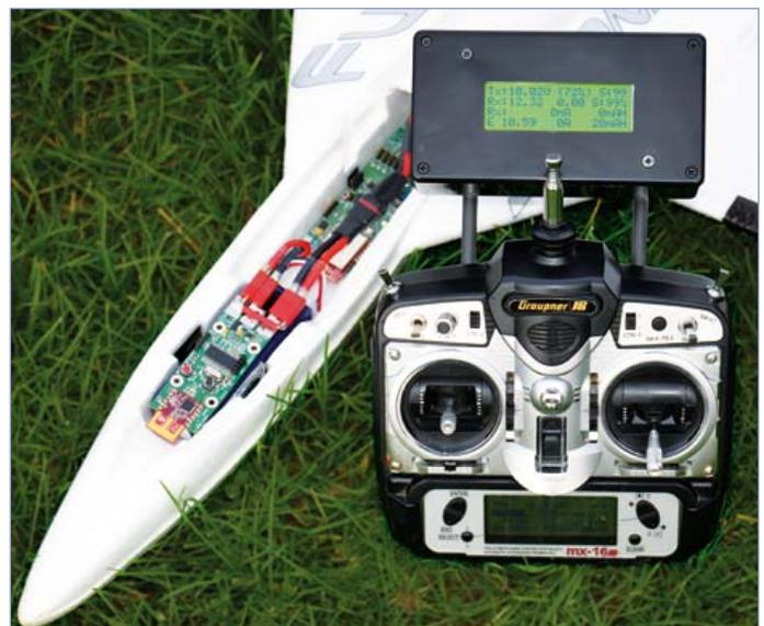
Figure 7. Ce modèle réduit est équipé de la configuration complète : récepteur à huit voies 2,4 GHz et télé mesure de la batterie.
