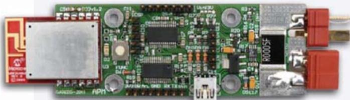
Carte équipée d'un module MRF24J4MB, offrant une portée de 1000 m, et de connecteurs de batterie de type « DEAN ».
