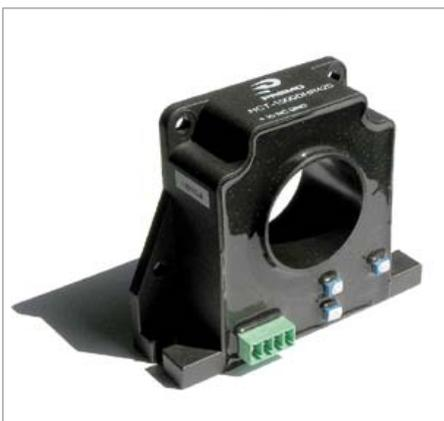
La caractéristique la plus notable de cette famille de capteurs est son courant de sortie, fixé entre 4 et 20 mA. Cette sortie *True RMS* est la façon la plus précise de mesurer les alimentations électriques ; elle est aussi utilisée pour connaître l'état de fonctionnement d'un moteur et de sa charge.
