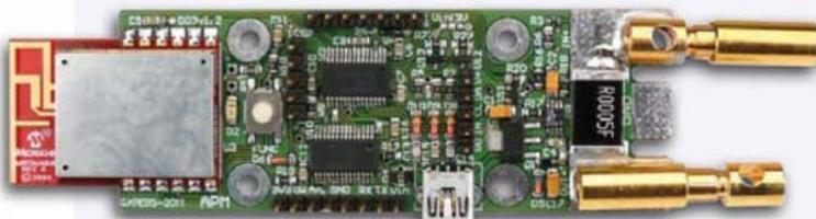
Carte équipée d'un module MRF24J4MB et de connecteurs de magnifiques prises PK 5,5 mm dorées, supportant 170 A en pointe.
