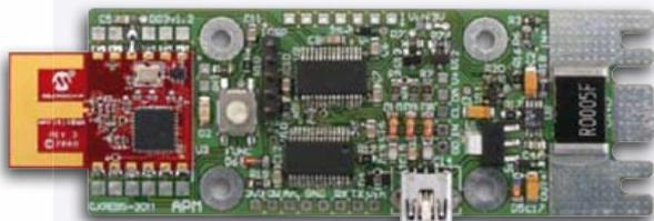
Carte équipée d'un module MRF24J-4MA, offrant une portée de 100 m. Aucune connectique de puissance n'est montée.
