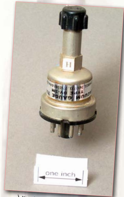
À l'intérieur de cette lampe un filament chauffant et un thermocouple générant une très faible tension dépendant du vide. Un NPT de 0,32 cm se connecte au système de vide.
