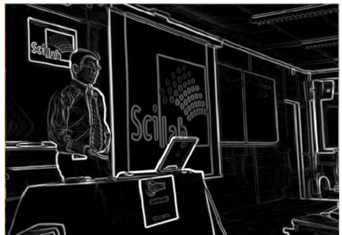
Figure 10. Les contours trouvés par le filtre de Prewitt.
