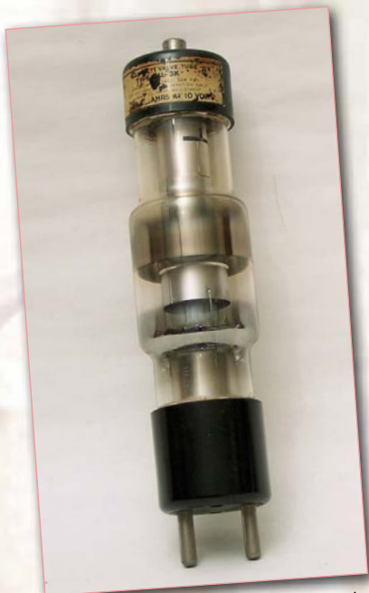
Lampe à rayons X de 1950, mesurant environ 30 cm, à anode et cathode fixe. Les lampes modernes amplifient la puissance en utilisant une grande anode tournant à vitesse élevée.
