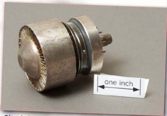
Tétrade émettrice de puissance 4x150. L'anode en métal a des ailettes pour le refroidissement. Très célèbre, « tous les amateurs de radio en ont une ».
