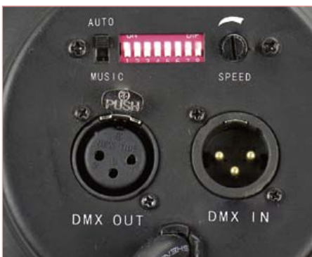
Figure 6. Entrée et sortie DMX à la face postérieure du projecteur à LED RVB. Les interrupteurs DIP servent à paramétrer le canal DMX en mode DMX.
