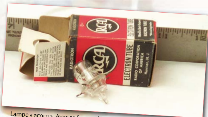
Les tubes des années 30, comme celui sur la gauche, avaient 4, 5, 6 ou 7 broches de différentes tailles. Puis vinrent les supports octaux, les 9 et 7 broches miniatures, le Compactron à 12 broches, et les types subminiatures.
