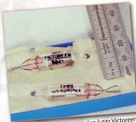
Lampe régulatrice haute tension à gaz Victoreen 5841, régulant à 900 VCC pour une charge de 5 à 100 \mu A.
