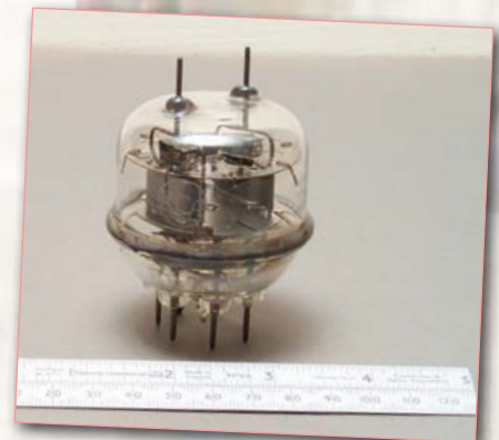
Tétrade de transmission jumelle 832-A. Le bon vieux temps pour les radioamateurs. Ne sont pas neutralisées, à l'inverse des QQE06/40 européennes (voir Rétronique janvier 2009).
