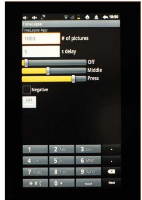
Figure 3. L'interface graphique pour la commande de l'appareil photo sur l'écran de la tablette.
