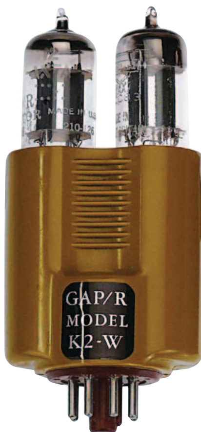
Figure 4. Le Philbrick K2-W est généralement considéré comme étant le premier amplificateur opérationnel.
