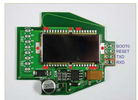
Figure 10. On voit, ici, les broches à souder sur le module Bluetooth. Les autres broches sont superflues.
