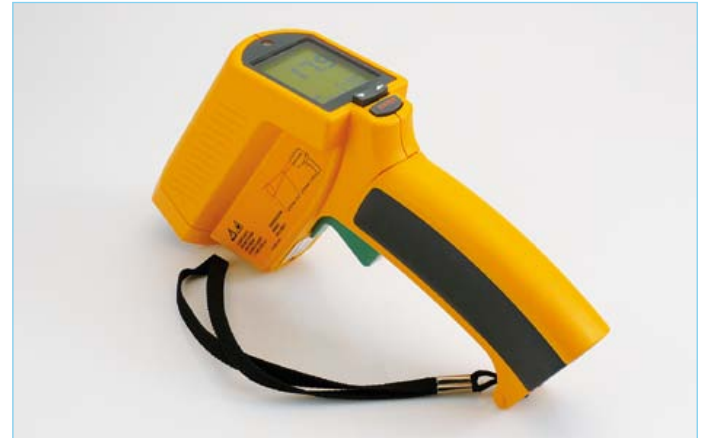
Figure 4. Voici le Fluke 572 qui a servi de référence pour ce test, il a un angle d'ouverture de 50 : 1.
