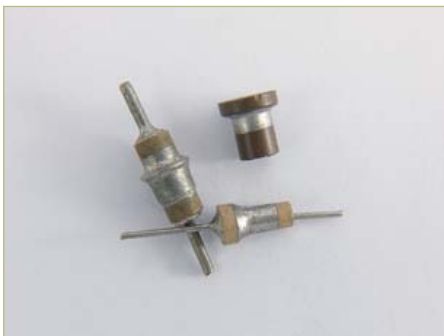
(d) Condensateurs de traversée. Faible inductance parasite. Idéal pour découplage RF. 200 pF, 470 pF, 1 nF .
