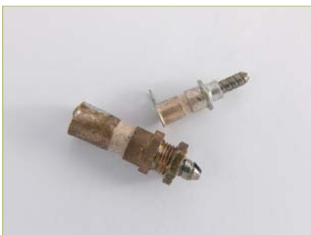
(g) Condensateurs ajustables tubulaires. Rotor à la masse, à moins d'être en série. 0,3 à 3 pF, 1 à 6,5 pF .
