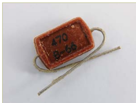
(h) Condensateur au mica argenté. Tension de service 500 V, 1966, sans autres précisions. Sur eBay. 470 pF .
