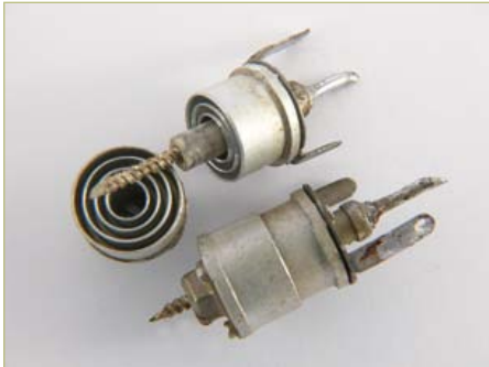
(a) Condensateurs ajustables Philips « cloche », 5-30 pF . Faible perte. Conception ingénieuse pour réponse linéaire sur toute la plage (!). Rotor (pièce mobile) normalement relié à la masse (pourquoi ?).
