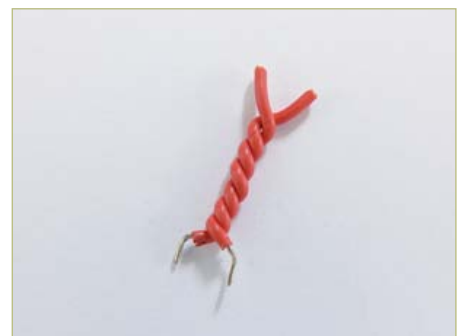
(i) Aussi petit que bon marché, à réaliser soi-même. Torsader les fils augmente la capacité. Coupez une fois atteinte la valeur souhaitée. Utilisable jusqu'à 200 V CC. 0,2 à 1,5 pF, ajustable .
