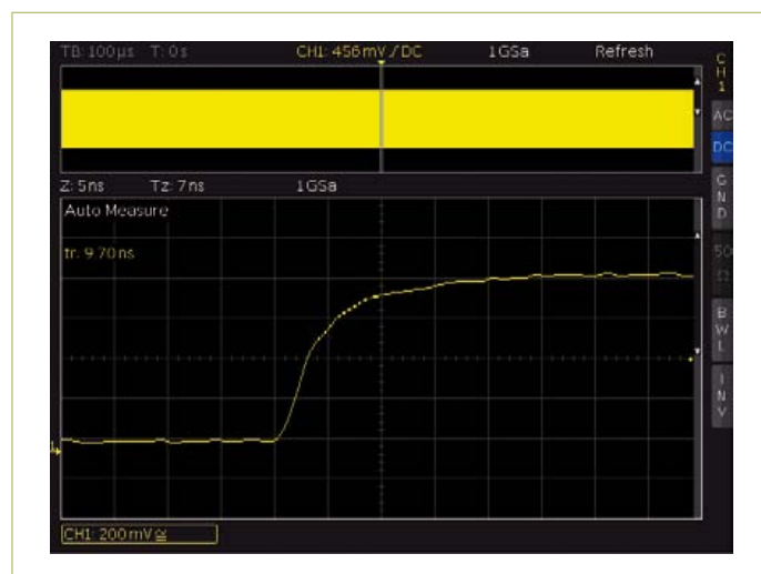
Figure 2. Avec une mémoire d'acquisition d'un million de points, une durée d'enregistrement de 1 ms permet de résoudre des variations très rapides du signal (< 10 ns).
