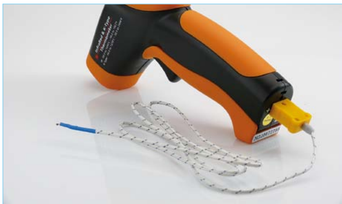
Figure 6. Certains appareils sont accompagnés d'un thermocouple de type K avec lequel on mesure la température par contact de manière à adapter le paramètre d'émissivité pour une mesure en IR correcte.
