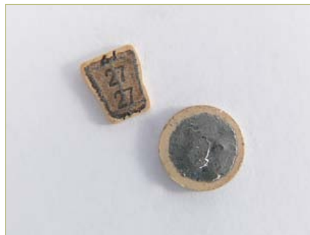
(e) Condensateurs disques et trapézoïdaux. Faible perte, sans inductance parasite. Couplage et découplage sur circuit. Fragiles ! À relier à une piste du circuit et à son plan de masse en cuivre. 27 pF, 820 pF .
