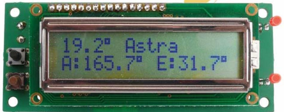
Une personne qui doit réaligner régulièrement une antenne parabolique (par exemple si une caravane ou un bateau en est équipé) se heurte toujours au problème de déterminer la position correspondante du satellite. SatFinder, basé sur un GPS, possède une base de données des satellites de télévision les plus populaires. Il calcule, à partir des données de localisation GPS, tout ce qui est nécessaire pour orienter l'antenne en direction du satellite.
