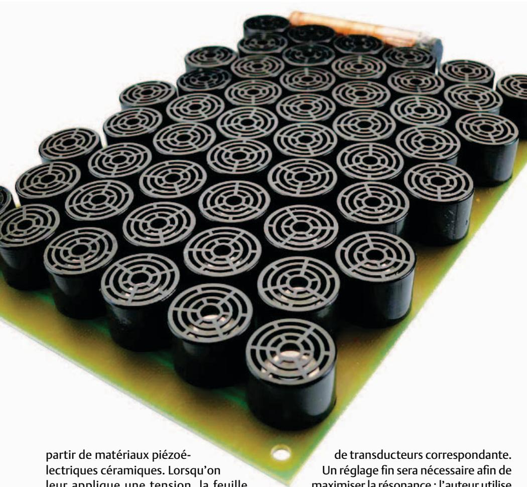
partir de matériaux piézoélectriques céramiques. Lorsqu'on leur applique une tension, la feuille d'un type particulier qu'ils contiennent se déforme, générant une onde ultrasonique de fréquence spécifique. On mesure généralement 105–120 dB (à 30 cm) à la sortie d'un de ces transducteurs lorsqu'il est alimenté par une tension de 10–20  $V_{rms}$  soit 28–56  $V_{pp}$ , ce qui soulève des questions quant à la nécessité d'une tension de cet ordre pour l'alimentation.
