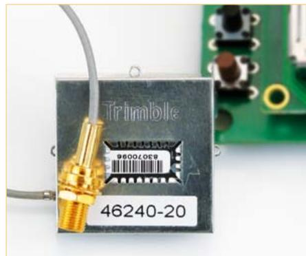
Figure 5. Le module de réception GPS de Trimble utilisé pour le prototype.
