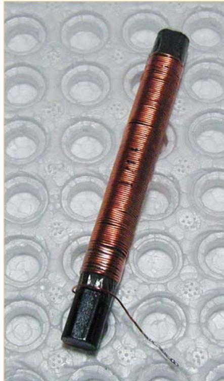
Figure 5. Un barreau de ferrite de radio constitue un très bon noyau pour bobiner une inductance ajustable de 60-160  $\mu$ H permettant d'atteindre la fréquence de résonance des transducteurs (habituellement, 40 kHz).
