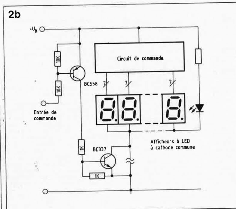
Figure 2. Voici comment effectuer la connexion du gradateur pour affichage à 7 segments à LED: à gauche une version destinées aux afficheurs à anode commune, à droite celle qui convient dans le cas d'afficheurs à cathode commune.
