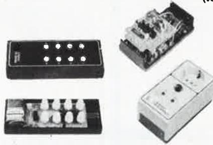
Ce système de télécommande universel à 8 canaux permet de commander à distance les appareils les plus divers: radio, lampe, ventilateur, téléviseur, machine à café, ouvre-porte, etc. Son immunité aux parasites et sa portée d'une quinzaine de mètres en font un système des plus fiables. Il se compose d'un boîtier de télécommande IR à 8 boutons et de 1 à 8 modules récepteurs.
