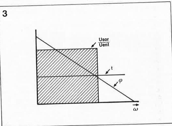
Figure 3. Voici la forme de la caractéristique d'un filtre passe-bas idéal: une pente parfaitement rectiligne et un retard constant sur tout le domaine de fréquence.
