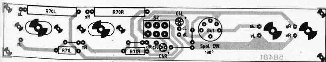
Figure 7. Ci-contre, la sérigraphie de l'implantation des composants de la platine des embases ACE 2000 à l'échelle 1/1,3. En-dessous, un exemplaire terminé de cette platine sans les embases DIN-HP ni Cinch/RCA. On n'implantera évidemment que les embases qui répondent aux caractéristiques de la liaison qui véhicule le signal en provenance du préamplificateur ou de l'amplificateur.
