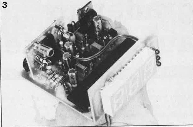
**Figure 3.** Vue plongeante à l'intérieur du montage terminé. Lors de son implantation dans le boîtier, le montage subit une rotation de 180°, pour permettre aux points décimaux de trouver leur position naturelle.
