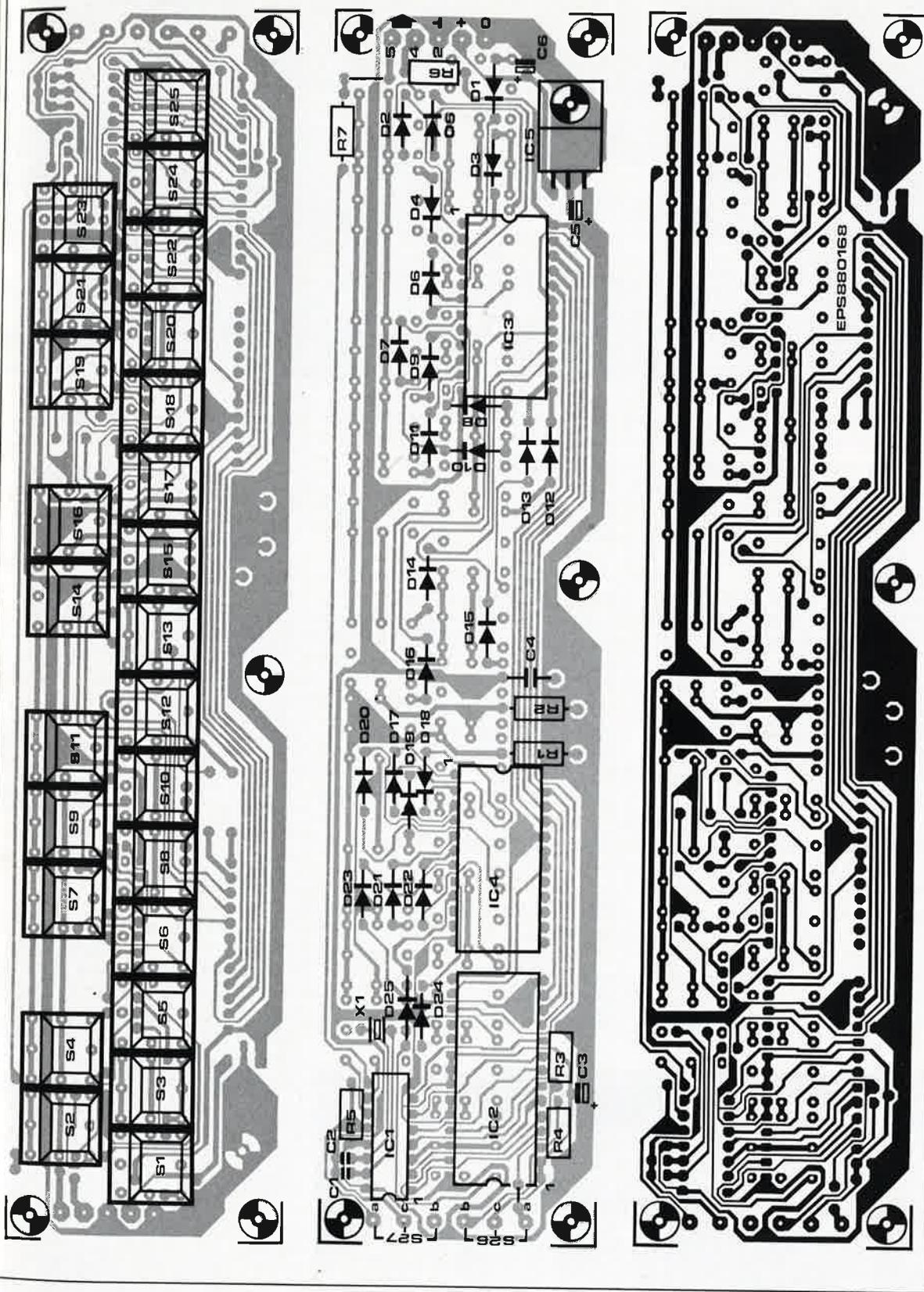
**Figure 5. Voici une bien curieuse platine: les composants électroniques sont montés du côté des pistes de cuivre. La platine ne comporte pas de trous pour ces composants, mais seulement pour les touches qui sont montées de l'autre côté où ne figure d'ailleurs pas le tracé des pistes en noir, contrairement à ce qui est le cas habituellement. Ce ne sont là ni erreurs, ni défauts de fabrication.**
