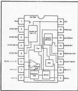
Ce composant intègre toute la circuiterie nécessaire à une coupure temporisée de la tension et un dispositif unique de mise sous tension progressive (lors du démarrage). Il fournit en outre une tension de référence, et possède un amplificateur d'erreur et un modulateur de largeur d'impulsion; on se trouve ainsi en présence de caractéristiques de linéarité et de régulation en charge remarquables.
