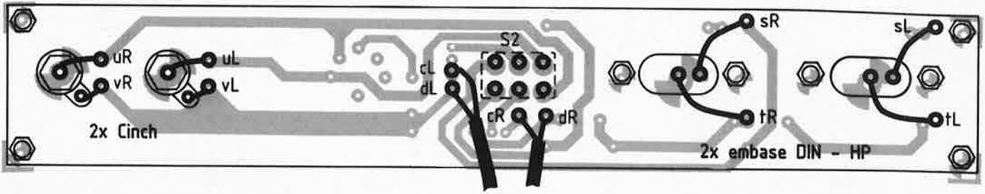
garder un espace de 10 mm entre le côté des pistes de la platine et les rails-guides.
