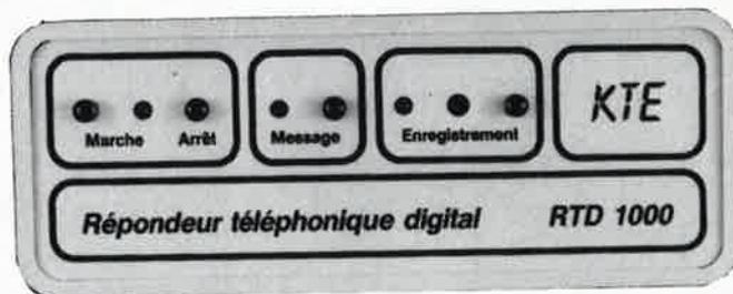
Le répondeur téléphonique numérique de KTE, présenté dans un coffret élégant, fait appel à un circuit intégré de synthèse vocale. Celui-ci est capable de "répéter" un message d'une quinzaine de secondes enregistré au préalable sous forme numérique (ni bande magnétique ni cassette!). La réalisation et la connexion (à un réseau téléphonique privé) de ce répondeur, vendu à un prix très avantageux, sont d'une simplicité extrême.
