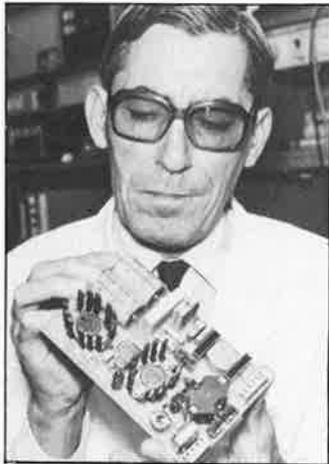
Les trois platines échantillons (250, 150 et 50 W) pèsent respectivement 330, 250 et 100 g, ce qui représente un gain de poids pouvant aller jusqu'à 94% par rapport à un montage avec un transformateur de 50 Hz.
