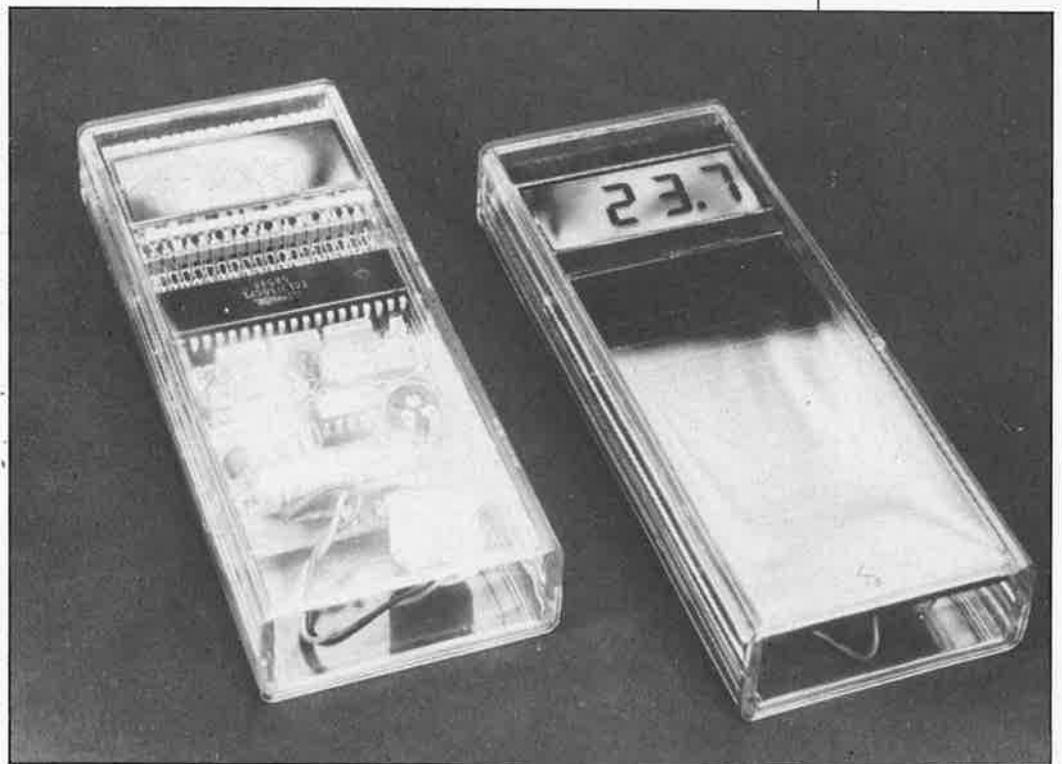
3 °C! Au voisinage de la température ambiante (25 °C), la dérive n'est que d'un quart de degré centigrade. Sa consommation intrinsèque est très faible; le courant qui circule à ce niveau passe pour l'essentiel par la résistance de polarisation de la sortie. A propos de températures, ne perdez pas de vue le fait qu'en-dessous de -10 °C, les cristaux liquides gèlent...
