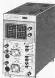
DÉVIATION VERTICALE: Simple trace, temps de montée 35 nano-S.
