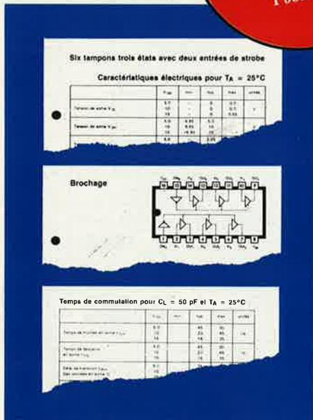
▲ Pour chaque circuit intégré, les caractéristiques limites et les spécifications d'utilisation indispensables à la mise en œuvre (exemple ci-dessus : circuit C-MOS 4503).
