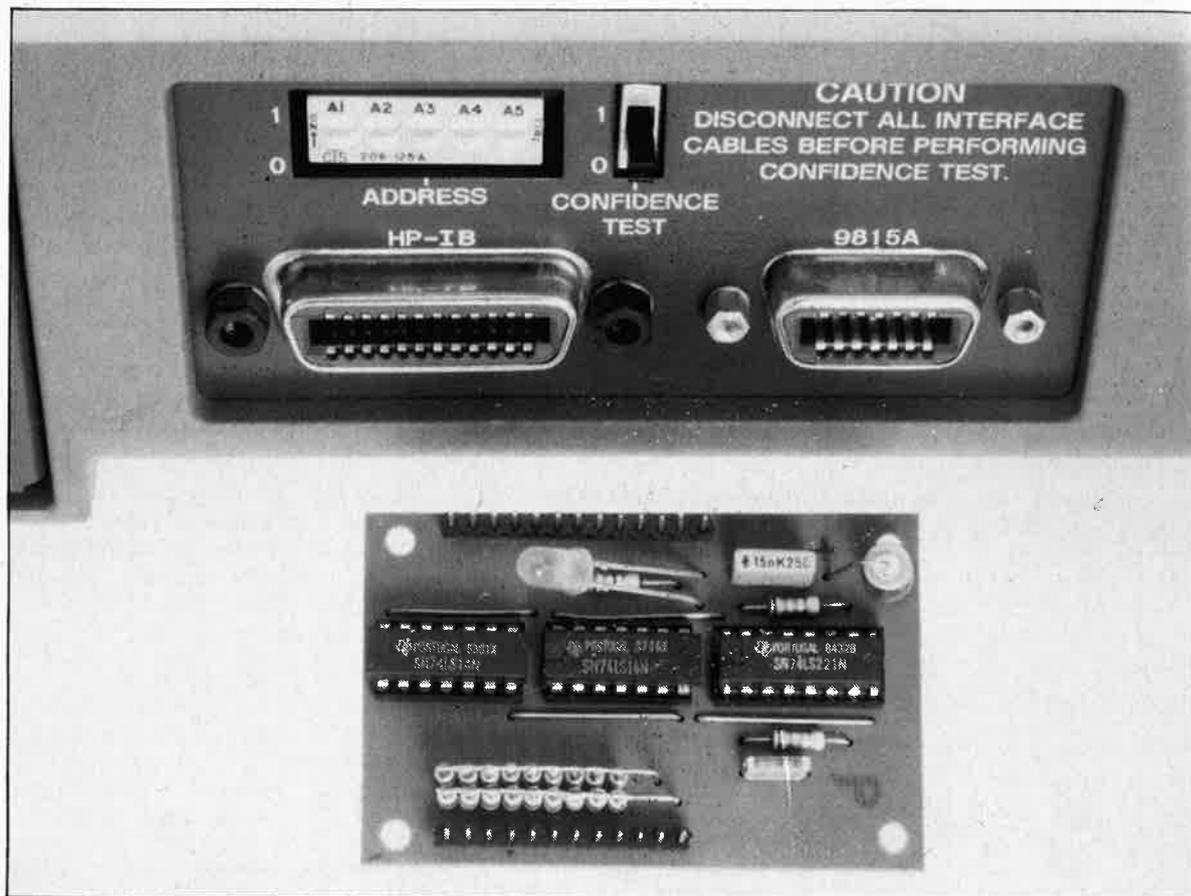
L'utilisation d'un bus IEC ou IEEE 488 comme sortie Centronics pose quelques problèmes de chronologie des signaux d'acquiescement NRFD et NDAC. La solution proposée ici convient à tous les types d'imprimantes avec interface parallèle.
