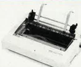
• 120 cps (25 cps en NLD) • Tête 9 aiguilles • Bidirectionnelle optimisée • Matrice 9 x 11 (17 x 17 en NLD) • Entraînement traction ou friction • Buffer 4 Ko • Mode graphique
