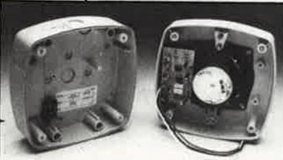
Sirène électronique 2 tons dans
