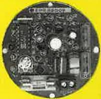
INTERRUPTEUR AUTOMATIQUE A DETECTION INFRA-ROUGES
