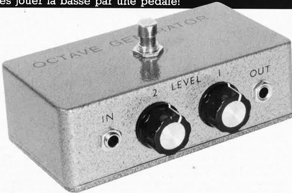
Voici une nouvelle pédale d'effets pour guitaristes: elle transpose le signal vers le grave, d'une ou deux octaves au choix. Comme le montre la photographie, le dosage des signaux de basse peut être réglé à volonté par le musicien, grâce à deux potentiomètres.
