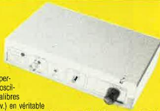
Ce module d'extension permet de transformer tout oscilloscope (équipé des calibres 200 mV/div. et 500 uV/div.) en véritable appareil à mémoire pour visualiser des phénomènes très lents ou non répétitifs.
