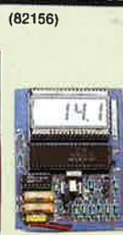
**NOUVELLE VERSION GRANDE AUTONOMIE.** - 55 à + 150 °C. Résolution 0,1 °C (Sans boîtier).
