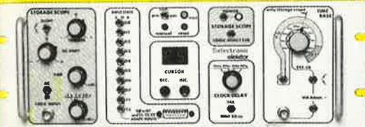
permet de pointer sur l'écran un mot logique de 8 bits - L'extension mémoire permet de mémoriser des signaux analogiques - Compatible TTL, TTL-LS, C-MOS.
