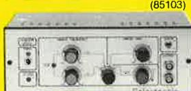
(B5103) Cet appareil est prévu pour fonctionner avec le Générateur B.F. d'ELECTOR (B4111) ou tout autre générateur possédant une entrée VCO acceptant de 0,1 à 10 V. Il permet de contrôler sur un oscilloscope le comportement de filtres, enceintes ou amplificateurs, etc...
