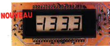
Ce module universel est prévu à l'origine pour équiper l'alimentation de laboratoire - peut remplacer tout galvanomètre continu, analogique de tableau (calibre minimum 200,0 mV) - le calibre voulu se choisit par simple changement d'une résistance - calibres ampèremètres par adjonction d'un shunt (en principe 0,1 ohm) - zéro automatique, polarité automatique - alimentation au choix (régulation incorporée) symétrique ou asymétrique.
