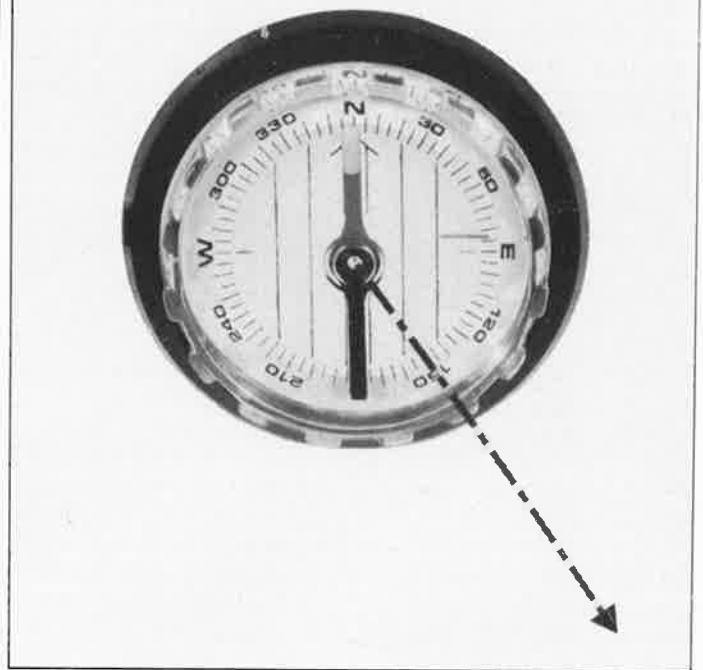
Figure 27. Utilisation d'un compas pour repérer approximativement l'azimut d'une parabole (la position sur la photographie n'est qu'un exemple).
