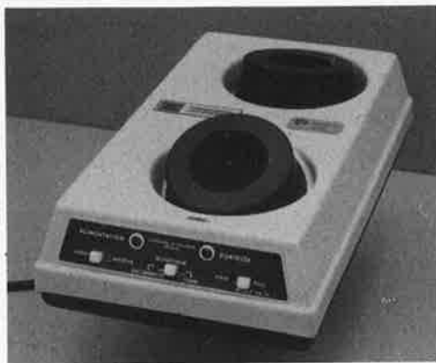
Photo. Exemple de modem de fabrication industrielle. On voit nettement les embouts d'isolation dont il est question dans le texte.
