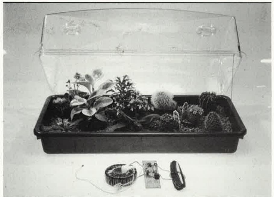
(6,5 V). Le condensateur C3 supprime l'ondulation résiduelle. Le signal pulsé appliqué sur la broche 6 du TDA1024 permet la synchronisation sur le passage par zéro de l'onde secteur. Le réseau de déphasage R3/C4/C1 est nécessaire du fait de la faible amplitude de la tension de service. Le réglage de la température de consigne est fait sur les bro-
