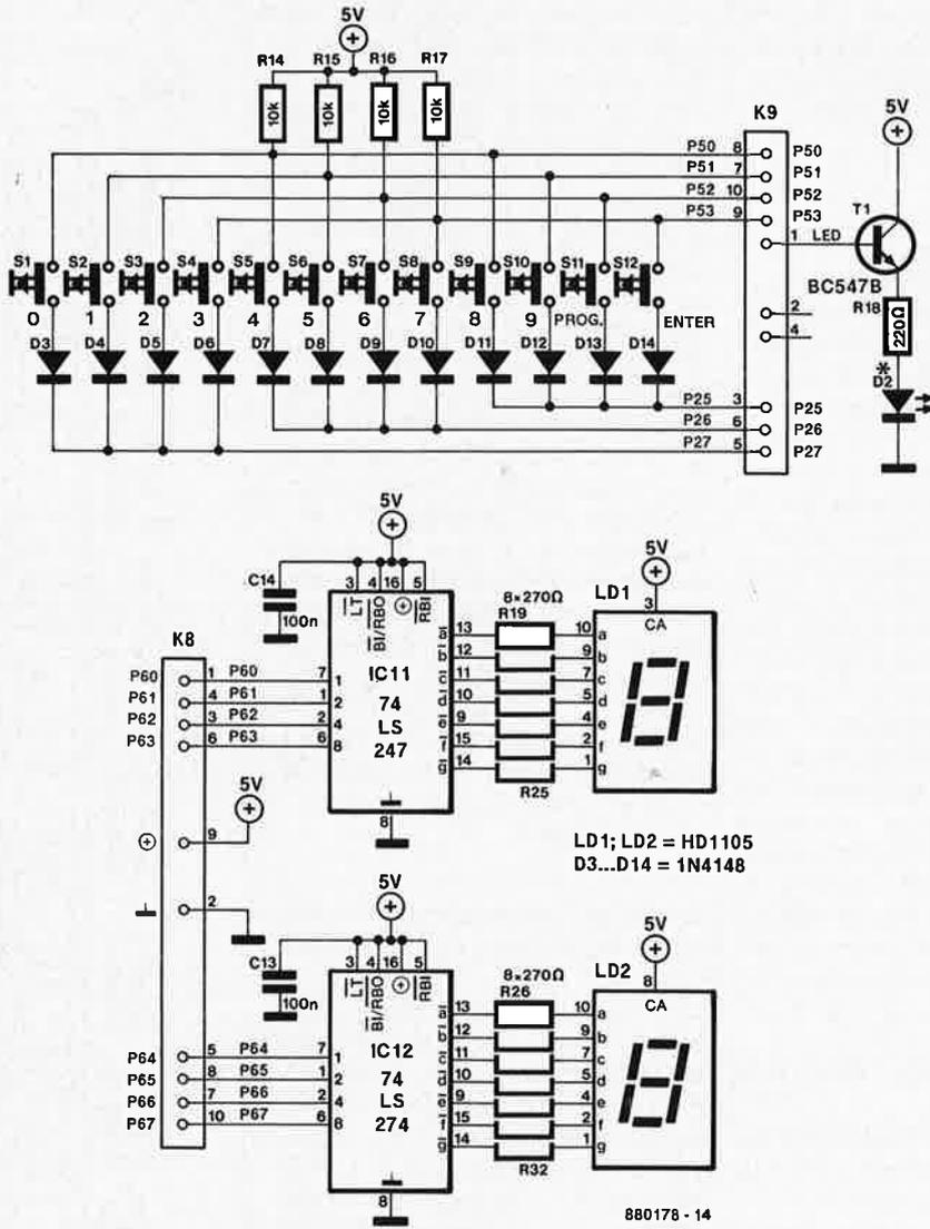
**Figure 4.** En façade du module MIDI Q4 d'ELEKTOR se trouvent deux afficheurs à 7 segments, 12 touches et une LED. Ces composants sont implantés sur une platine séparée conçue pour prendre place derrière la face avant d'un coffret rack 19 pouces extra-plat. Les deux embases pour connecteur à câble plat sont implantés côté cuivre.
