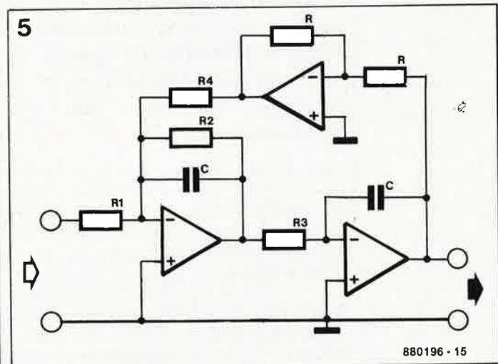
Figure 5. Le domaine privilégié d'utilisation d'un filtre à état variable est celui des circuits qui nécessitent un réglage précis des pôles et des points zéro.
