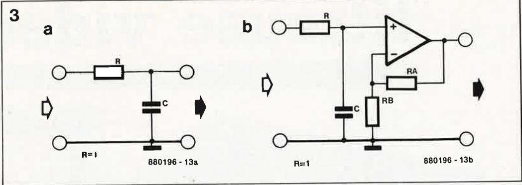
Figure 3. Un simple réseau RC (a) permet de constituer un pôle réel. Par l'adjonction d'un amplificateur opérationnel (b) on dote cette section d'un tampon et on en fait un amplificateur à gain non unitaire.
