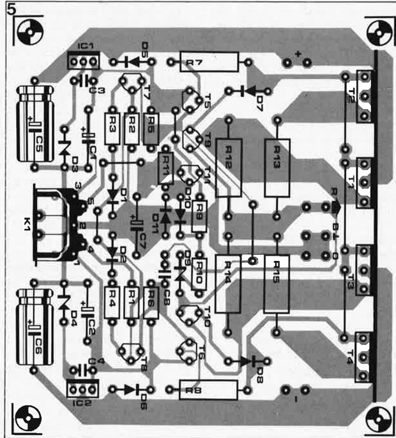
Figure 5. Sérigraphie de l'implantation des composants de la platine de l'amplificateur de puissance.
