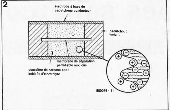
**Figure 2. Le carbone actif et l'électrolyte trouvent place à l'intérieur d'un boîtier étanche.**
