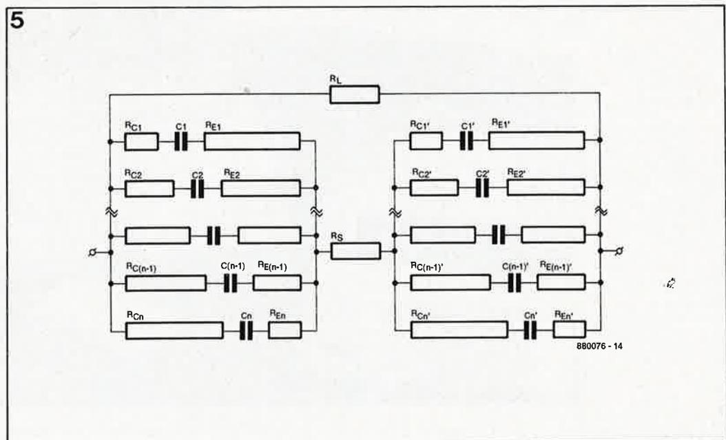
Figure 5. Ce schéma de substitution relativement complexe respecte la réalité d'assez près et permet ainsi le calcul des caractéristiques les plus importantes d'un supercondensateur, capacité et résistance-série équivalente.
