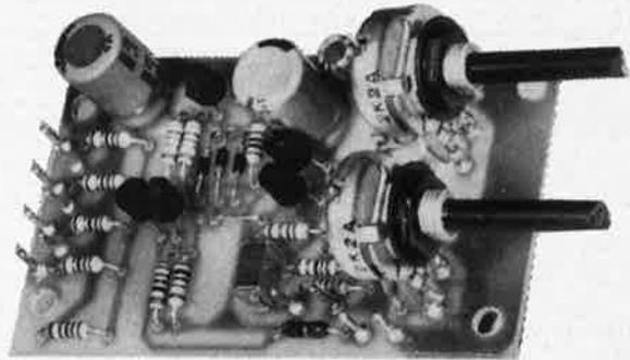
La copie de bandes vidéo entraîne une dégradation des signaux nettement perceptible. L'amplificateur-correcteur vidéo, avec ses quatre sorties parallèles, étend la plage de modulation et augmente ainsi le contraste des images copiées. Deux organes de réglage permettent d'agir sur le piqué des contours et sur le gain (contraste) en fonction des exigences individuelles.
