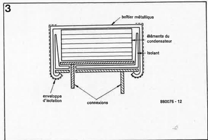
**Figure 3. La mise en série de plusieurs éléments permet une augmentation de la tension de service.**
