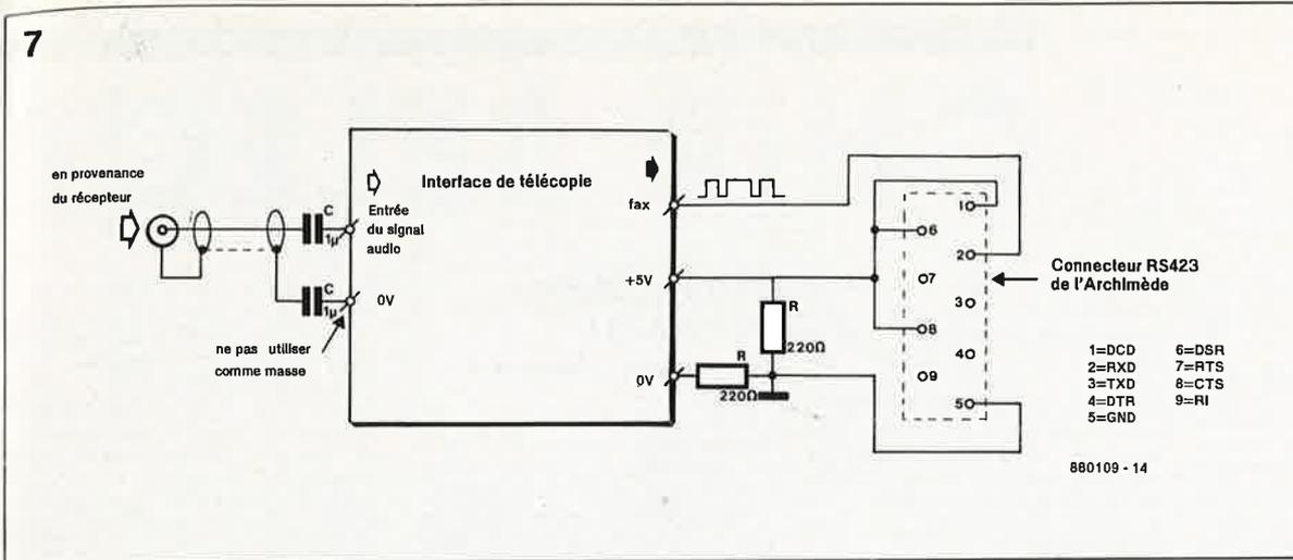
Figure 7. Plan de câblage de l'interface de télécopie à un Archimède.
