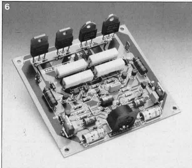
Figure 6. Un exemplaire pratiquement terminé de l'amplificateur de puissance d'EDITS (il ne manque que le radiateur).
