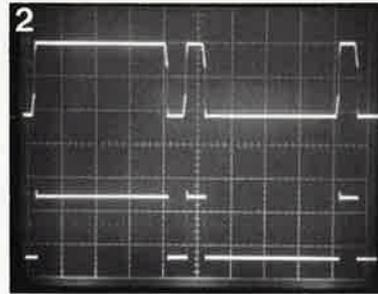
Figure 1. Transmission de données par commutation de la tension d'alimentation. On constate que la tension de sortie du booster de Märklin (trace du haut) n'est pas parfaitement stabilisée, contrairement à celle fournie par l'amplificateur de puissance EDITS (trace du bas).
