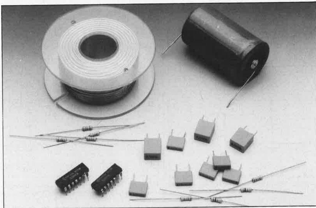
Lorsque l'on envisage la réalisation pratique d'un filtre, il existe plusieurs approches. La première, la solution passive, permet de faire un filtre à base de composants passifs uniquement, c'est-à-dire de selfs, de condensateurs et de résistances, d'où son nom. En faisant appel à des composants actifs, on arrive à réaliser des filtres sans utiliser de self, solution qui présente, pour certaines applications, des avantages décisifs.
