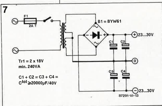
Figure 8. Si vous pouvez vous contenter (pour l'instant) d'un courant de sortie plus faible, le transformateur pour réseau miniature de Märklin (à un seul enroulement de 16 V) peut constituer une alimentation provisoire.
