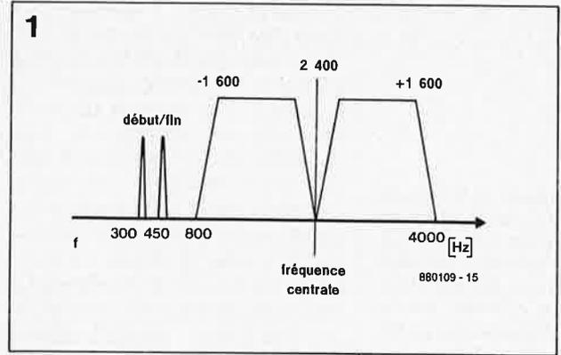
Figure 1. Structure d'un signal APT. La porteuse de 2 400 Hz est modulée en amplitude jusqu'à 80% à l'aide du signal de luminosité de 1 600 Hz de bande passante (fréquence) maximale.
