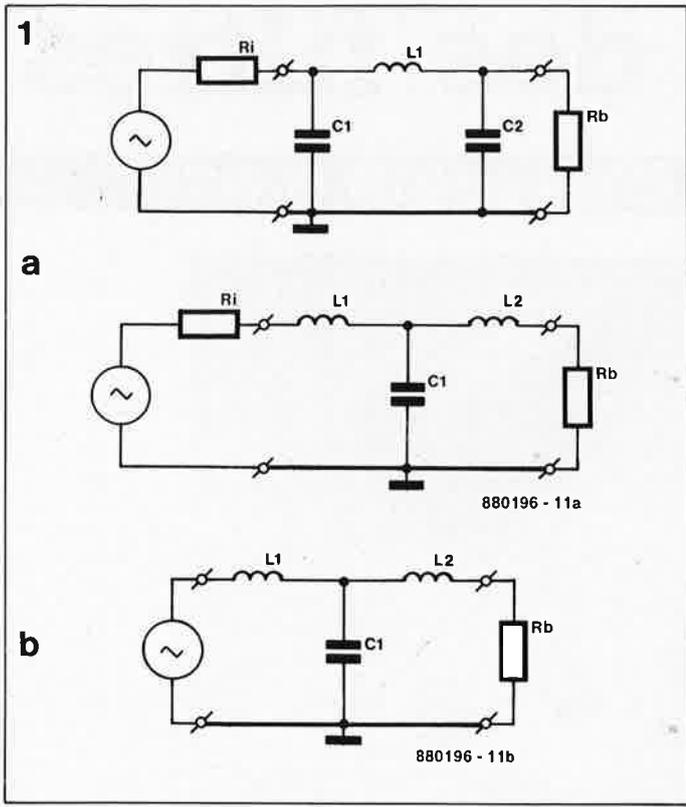
Figure 1. Filtrés passifs: a. filtré clos à ses deux extrémités par des résistances de valeur identique; b. filtré connecté à une source de tension à résistance interne nulle.
