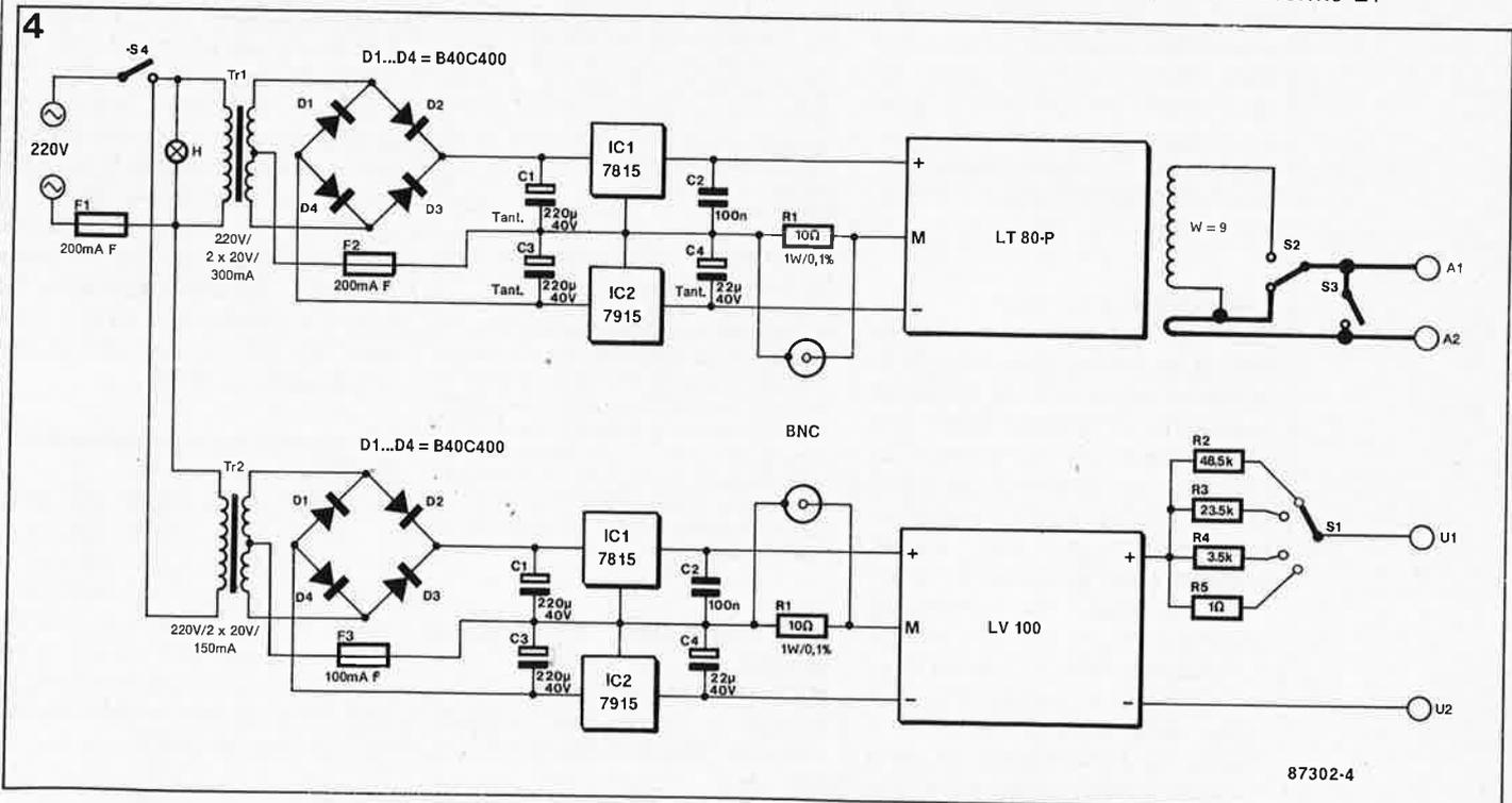
Figure 4. Association d'un LT 80-P et d'un LV 100.
