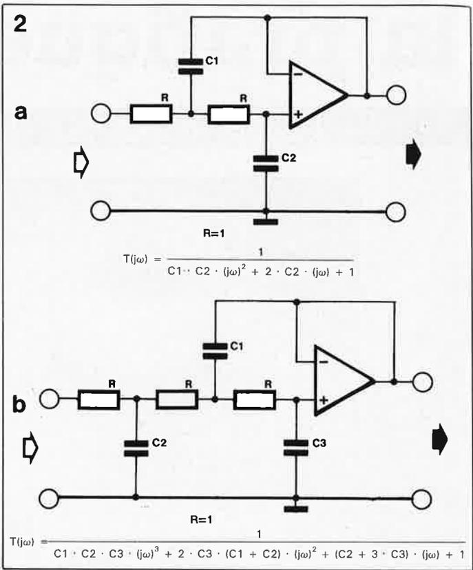
Figure 2. Filtré actif à amplificateur opérationnel monté en suiveur de tension: a. filtré bipolaire, b. filtré à trois pôles.
