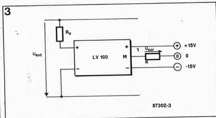
Figure 3. Détecteur de tension LV 100.
