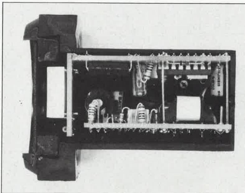
**Vue en coupe d'un exemplaire terminé du combimètre implanté dans le boîtier encastrable. Pour bien vous montrer la disposition en sandwich adoptée, nous avons procédé à un sciage latéral du boîtier.**
