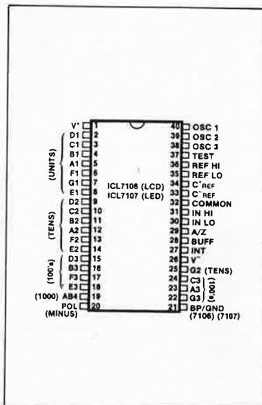
Brochage des ICL7106 et 7107. Leur seule différence se situe au niveau de la broche 21, qui est soit forcée à la masse dans le cas du 7107, soit utilisée pour la commande de l'arrière-plan (BP) d'un affichage à LCD (7106). Source Intersil
