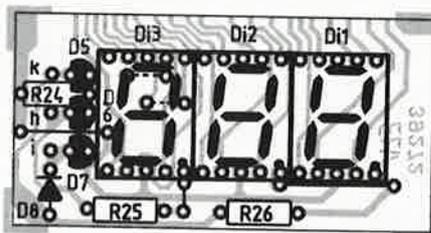
Figure 3. Représentation de la sérigraphie de l'implantation des composants et exemplaires terminés des 3 circuits imprimés nécessaires à la réalisation de notre triple indicateur; de haut en bas: - le commutateur de fonction - le circuit principal - le circuit d'affichage.
