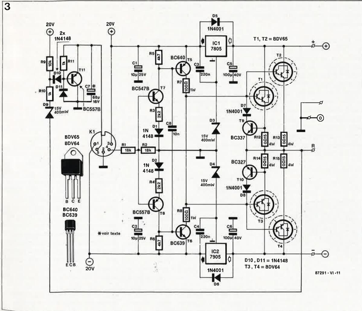
Figure 3. L'électronique de l'amplificateur de puissance.
