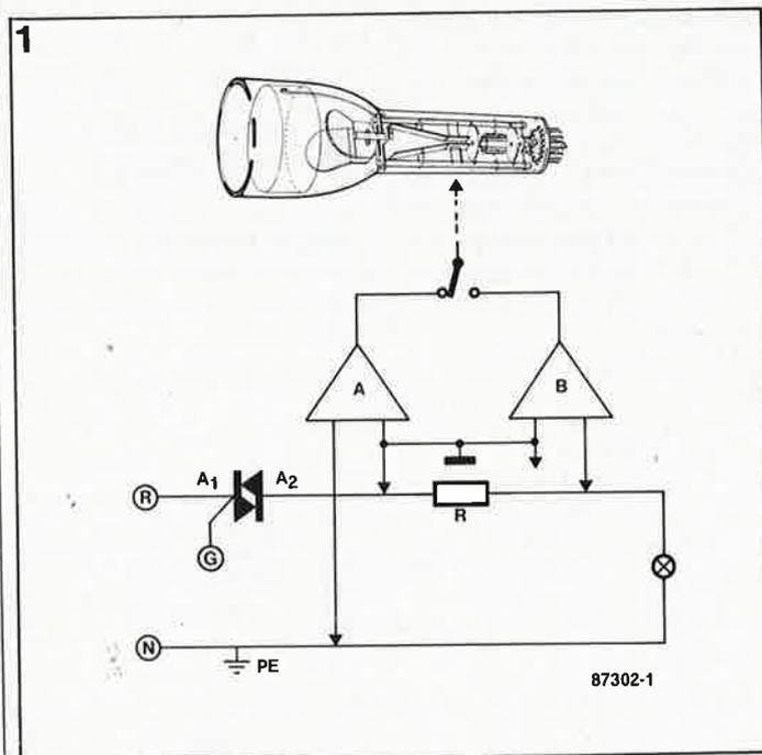
Figure 1. Mesure du courant et de la tension sur une ampoule à incandescence commandée par un gradateur.
