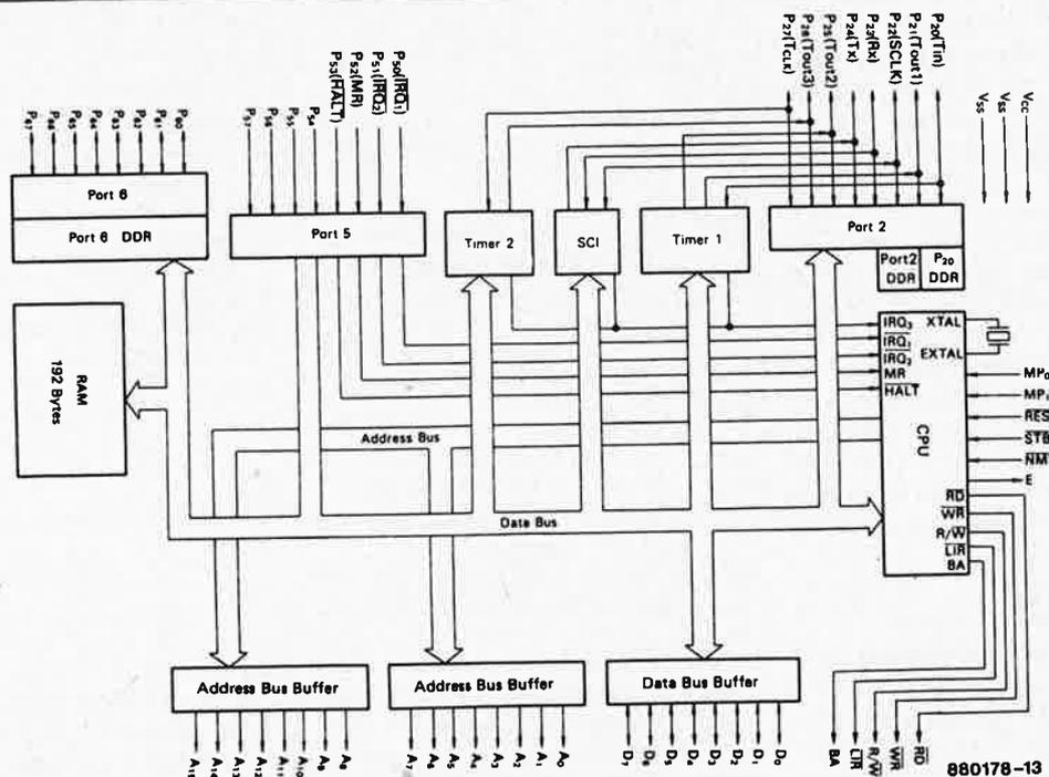
Figure 3. Structure du microprocesseur HD63B03X de Hitachi avec ses bus d'adresses et de données non multiplexés et sa très efficace quincaillerie périphérique. Les lignes P23 et P24 de son interface sérielle lui permettent de commander directement l'interface MIDI.
