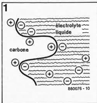
**Figure 1. De part et d'autre de la surface de séparation de deux matériaux conducteurs il naît une couche chargée, l'une positivement et l'autre chargée négativement (la couche électrochimique double). Cette couche peut servir au stockage de charges électriques.**
