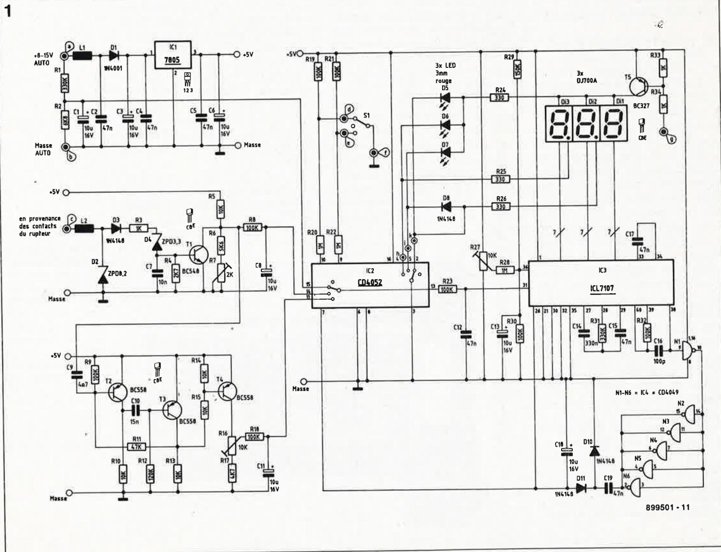
utilisé pour la mesure de l'angle de came, arrive aussi, par l'intermédiaire de C9, sur la base de T2. Associés aux composants connexes, les transistors T2 et T3 constituent un multivibrateur monostable qui en raison de la constance de sa durée d'impulsion, convient parfaitement à la mesure du régime du moteur.
