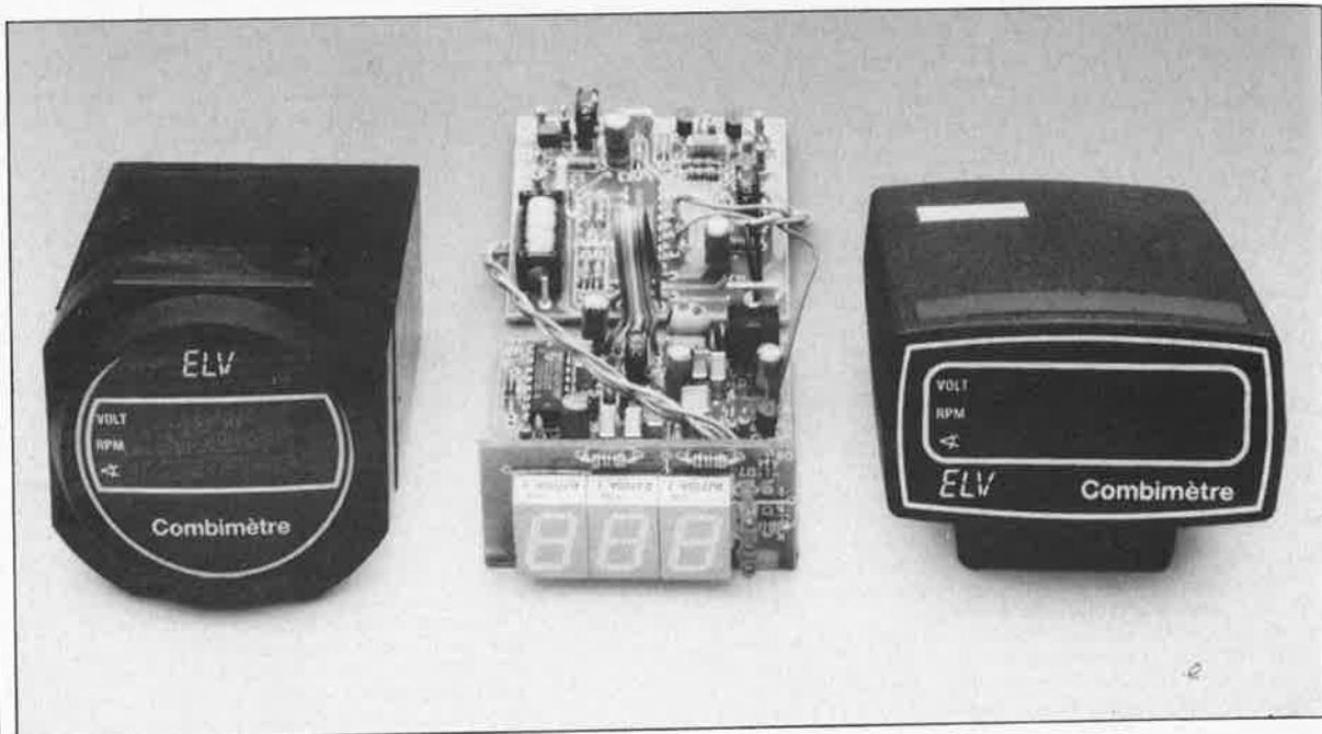
Drôle de titre !!! Combimètre, je n'ai jamais entendu parler de combimètre. Nous l'avons appelé ainsi parce qu'il mesure simultanément trois grandeurs différentes et visualise l'une d'entre elles, au gré de l'utilisateur, sur un affichage à afficheurs à 7 segments à LED, d'où son nom: **combi(né)mètre**.
