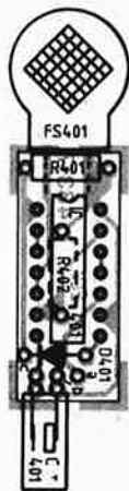
Figure 19. Dessin de la sérigraphie de l'implantation des composants du circuit imprimé du capteur d'humidité.
