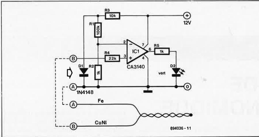
remplacer par un thermocouple. Le thermocouple résulte de la soudure de deux métaux différents. Il produit une tension vaguement proportionnelle à la température de la soudure. Dans l'application qui nous intéresse, la compensation de soudure froide nous est indifférente, tout comme la linéarisation de la courbe. Il nous suffit de savoir que la tension entre A et B est de 7 mV environ pour une température de 150° sur le thermocouple fer-constantan (ou cupro-nickel).
