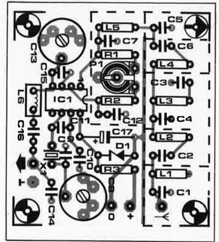
branché la sortie du convertisseur. On syntonise le récepteur à 10 MHz. Par action sur le condensateur ajustable C8 on règle la fréquence de l'oscillateur de façon à ce que le signal d'interférence ait une fréquence de 0 Hz (c'est ce que l'on appelle un réglage à battement zéro = *zero beat*). On
