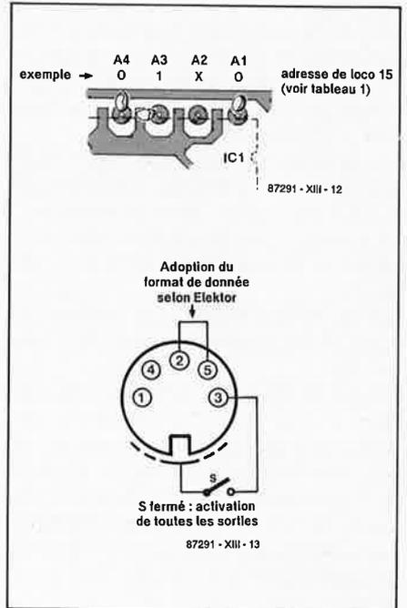
possible dans ce cas-là d'adresser le décodeur avec un bit de fonction actif ou comme une locomotive circulant en marche arrière. Cette option permet d'adresser deux fois plus de décodeurs de matériel roulant (162) que de décodeurs de locomotives.
