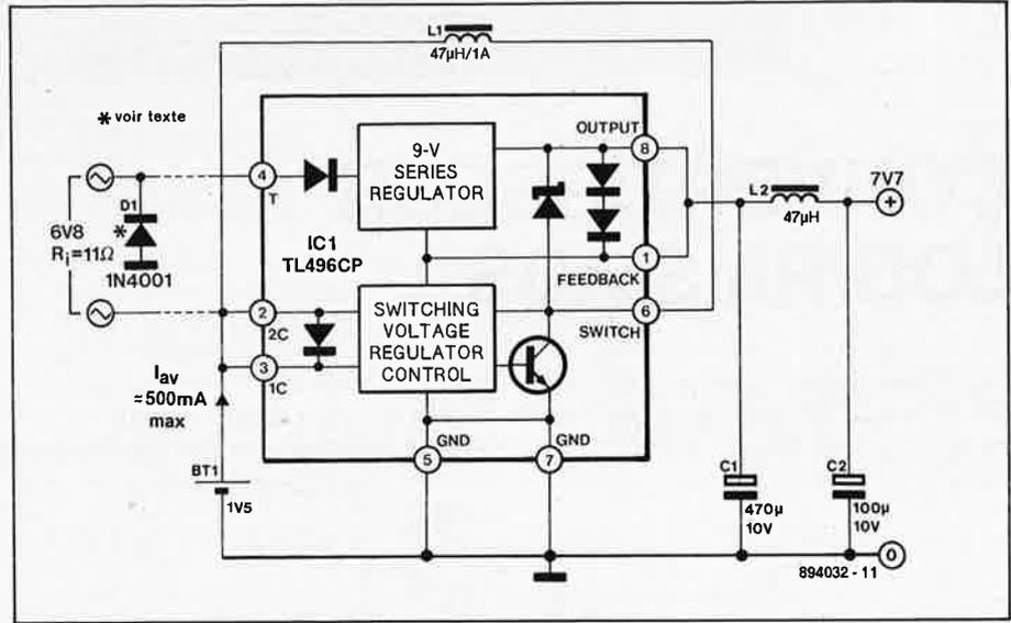
par IC1. Le courant de (re)charge des accus est fonction de la valeur de la résistance interne du transformateur (ici environ 11 Ω). Attention: il ne faut pas confondre cette résistance avec la résistance de l'enroulement secondaire du transformateur mesurée à
