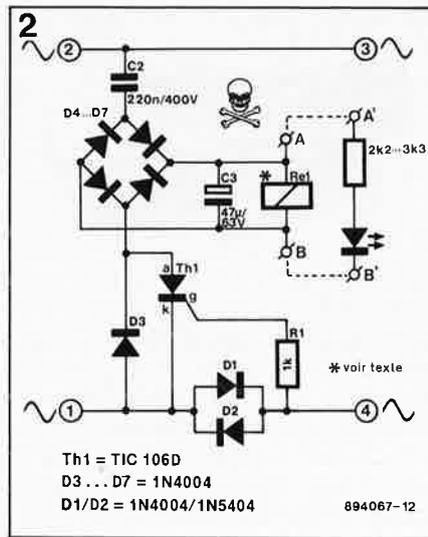
ainsi dire une fonction de surveillance et pourra servir à activer un signal d'alarme sous quelque forme que ce soit. Le relais utilisé sera un relais en-cartable du type 24 V/1 200 Ω, tel que par exemple le V23027 A6 A101 (Siemens). On peut également remplacer le relais par un dispositif de visualisation plus simple constitué par la mise en série d'une LED et d'une résistance de limitation implanté entre les points A et B du schéma.
