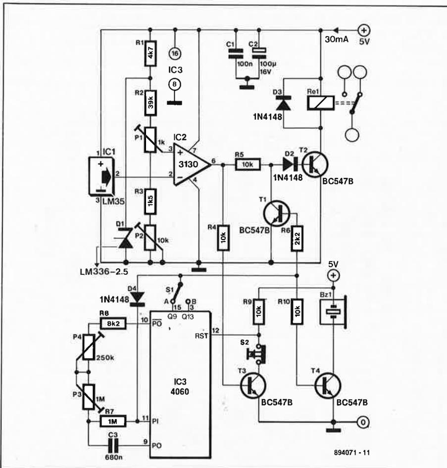
Ce temporisateur de chauffage comporte un réglage de température et un réglage de durée. La plage de température atteint 150 °C et la plage de durée 25 minutes.
