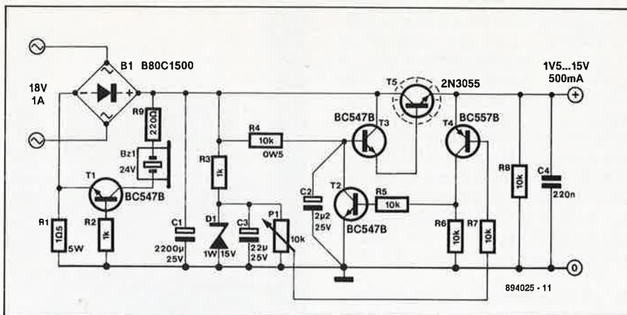
De par son principe, cette alimentation n'est pas protégée contre les courts-circuits. Cependant, si l'on donne au radiateur de T5 une taille suffisante, ce transistor est capable de supporter la dissipation maximale de 20 W pendant les quelques secondes nécessaires à la mise hors-fonction de l'alimentation. Il n'est pas difficile de trouver un radiateur de dimensions adéquates percé des orifices correspondants au
