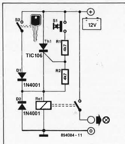
fournit alors la tension d'activation nécessaire au relais. Ceci ne peut être le cas qu'à condition que l'interrupteur S2 (la clé de contact) soit ouvert. En effet si cet interrupteur est fermé la
