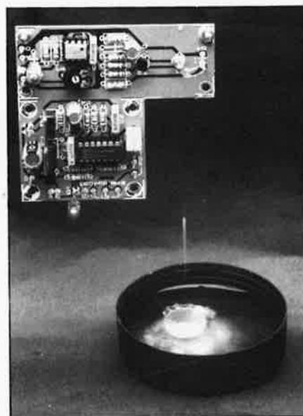
aussi montée en multivibrateur monostable. Dès réception de cette impulsion d'horloge, FF2 produit une impulsion de déclenchement transmise au flash par l'intermédiaire du transistor T2 et du thyristor Th1.
