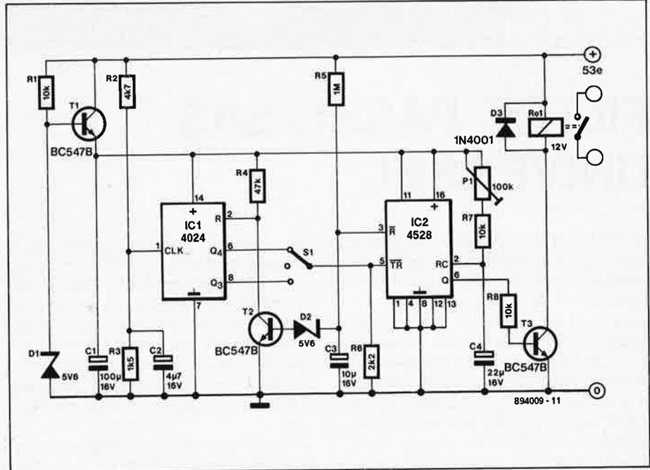
L'alimentation du montage est également fournie par la broche 53e. Lorsque cette broche véhicule 12 V, ce qui est le cas entre les impulsions de déclenchement, le transistor T1 est conducteur ce qui permet au condensateur C1 de se charger. Pendant les im-
