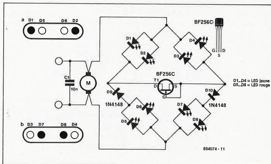
que faire de feux arrière, vous pourrez purement et simplement les supprimer (ceci ne signifie pas qu'il suffit de ne pas les implanter dans le pont; il faudra aussi veiller à remplacer chacune de ces diodes par un pont de câblage).
