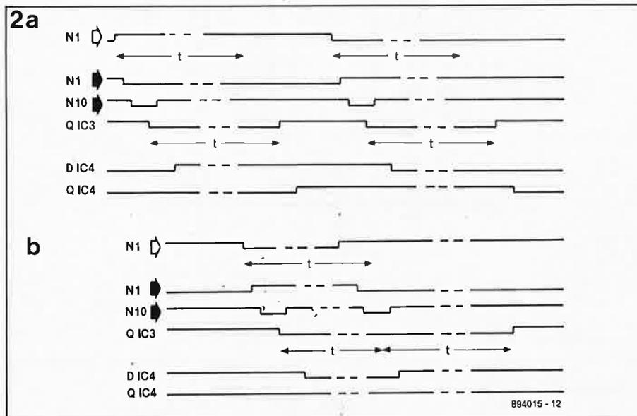
Figure 2a. L'intervalle entre les transitions est supérieur à la durée du monostable. Le seul effet du montage est d'introduire un retard.
