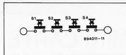
Le circuit de ce montage, si l'on peut ainsi dire, ne comprend rien de plus que les touches S1, S2, S3 et S4 que l'on monte en série et qui remplacent le poussoir de remise à zéro d'origine que comporte l'ordinateur.
