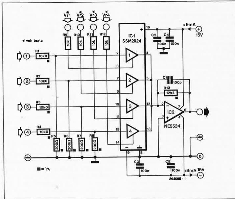
ment par le condensateur C1 dont la présence est indispensable pour assurer la stabilité de l'étage amplificateur centré sur IC2. Le circuit intégré SSM2024 nécessite une tension d'alimentation comprise entre ±9 V et ±18 V. Nous avons obtenu les meilleurs résultats avec une tension symétrique de ±15 V.
