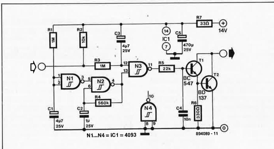
transmis à l'étage darlington de commande de l'ampoule de signalisation que constituent les transistors T1 et T2. Après écoulement du délai introduit par le réseau R1/C1, la porte N1 inhibe l'oscillateur N2 provoquant l'extinction de l'ampoule.
