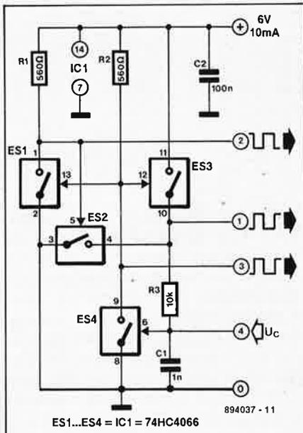
Quatre interrupteurs électroniques bidirectionnels intégrés dans un circuit du type 74HC4066 constituent le générateur. Le fonctionnement du circuit repose sur la constatation que le seuil de déclenchement présenté par une entrée HCMOS est relativement bien défini. Le point de basculement des niveaux bas et haut se situe approximativement à la moitié de la tension d'alimentation, 1/2 U<sub>b</sub>, valeur utilisée ici pour obtenir le rapport cyclique de 0,5 (signal de sortie carré).
