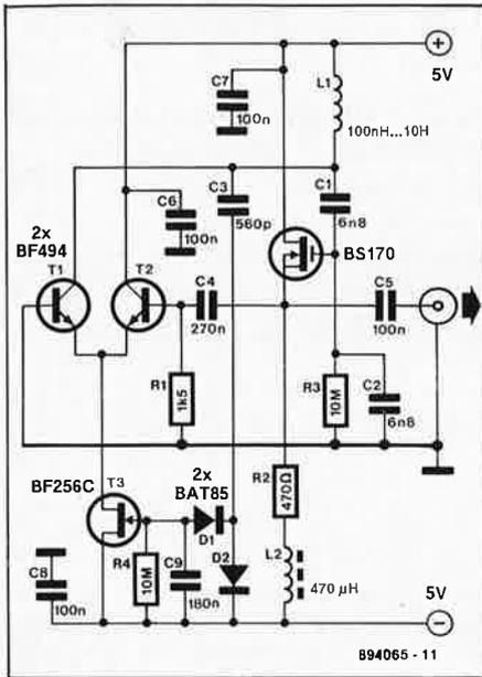
un oscillateur de Colpitts. Le signal fourni par le FET T4 est transmis à la sortie après découplage par le condensateur C5.
