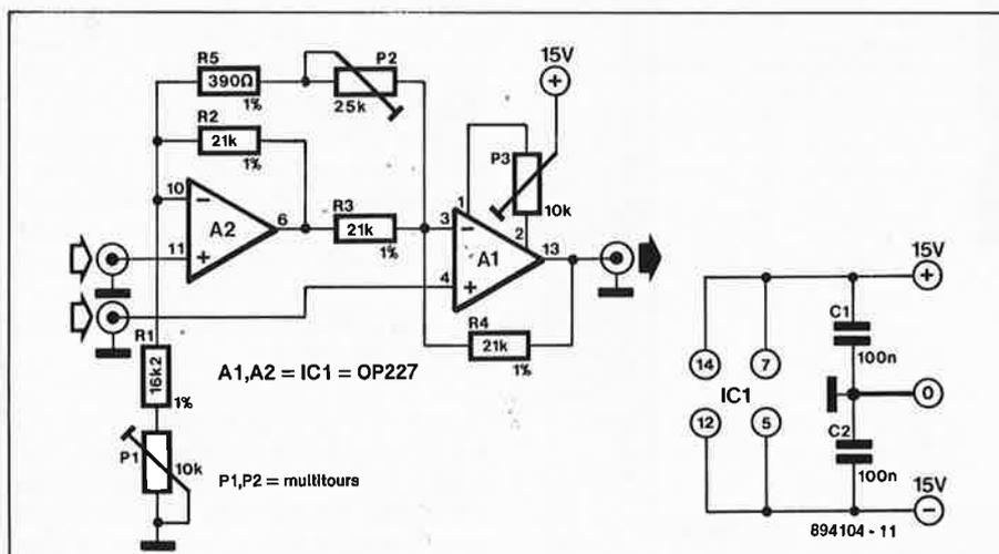
Pour ce circuit nous avons choisi un amplificateur opérationnel performant, l'OP227 de PMI (Precision Monolithics Incorporation). Non seulement chacun des deux amplificateurs opérationnels intégrés dans ce circuit possède d'excellentes caractéristiques mais celles-ci sont en outre pratiquement identiques; on comprend mieux que ce soit très précisément le type de circuit intégré convenant à ce genre d'applications.
