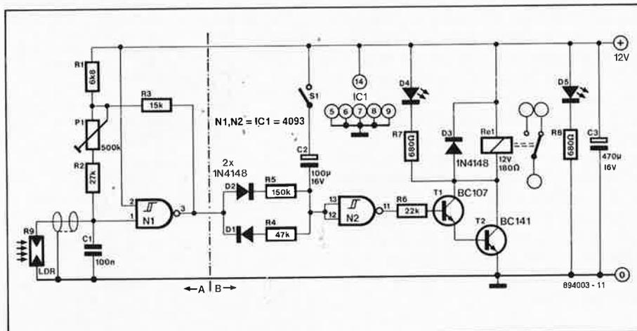
La sortie de cette porte attaque deux circuits de base de temps: C2/R4/D1 pour l'état "marche" et la combinaison C2/R5/D2 pour l'état "arrêt". Ces réseaux mettent la sortie de la porte N2 en et hors-fonction après écoulement des temporisations requises. Le relais de commutation de l'ampoule et la LED de visualisation de l'état du circuit sont attaqués par un étage darlington composé des transistors T1 et T2, qui commande la sortie de la porte N2.
