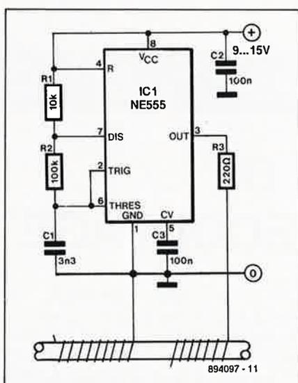
La méthode n°2 fait appel à l'électronique, comment pourrait-il en être autrement? Des mesures effectuées sur un détartreur "du commerce" nous ont permis de constater la présence d'un signal rectangulaire ayant une fréquence de quelque 2 kHz et dont l'amplitude atteignait près de 15 V.
