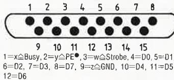
■ doit être relié à GND=z sur le connecteur, c'est-à-dire qu'il faut interconnecter les broches 2 et 9 du connecteur.
