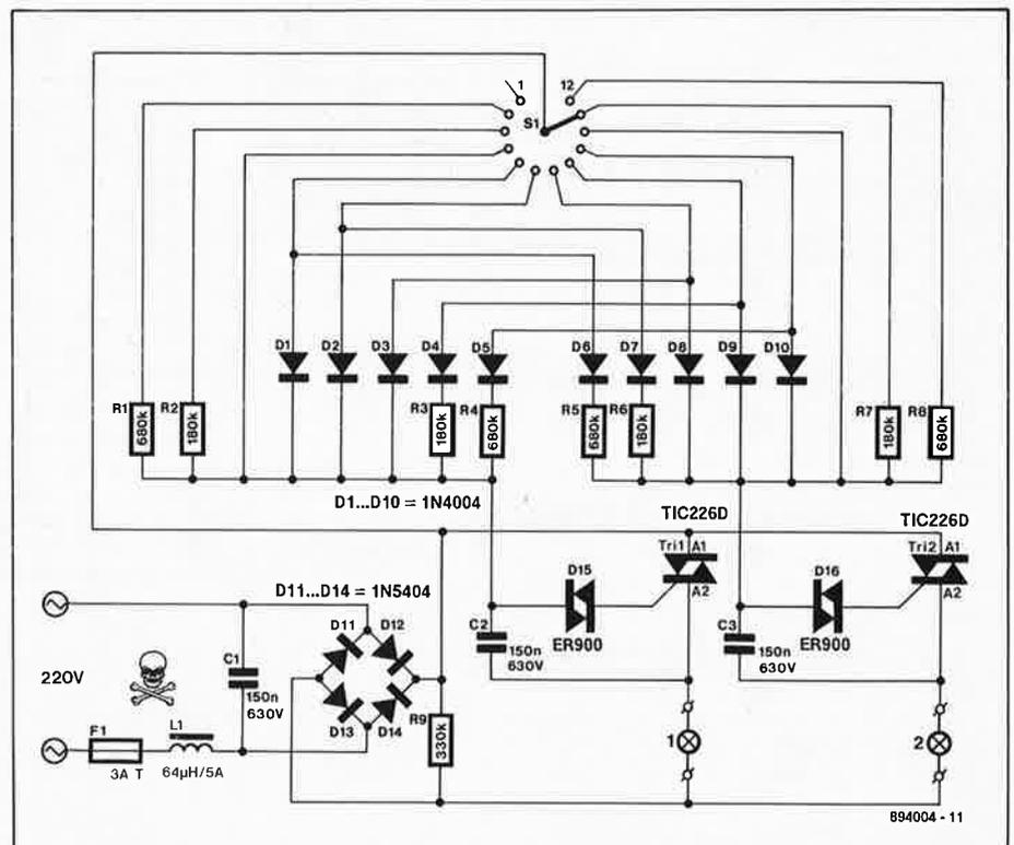
sistance du réseau et donc de modifier le régime de la lampe. La position sans résistance correspond à l'extinction des deux lampes, le court-circuit à l'allumage "à fond", les résistances de 180 k $\Omega$  et de 680 k $\Omega$  correspondent aux régimes intermédiaires. Les diodes empêchent un groupe d'influer sur l'autre.
