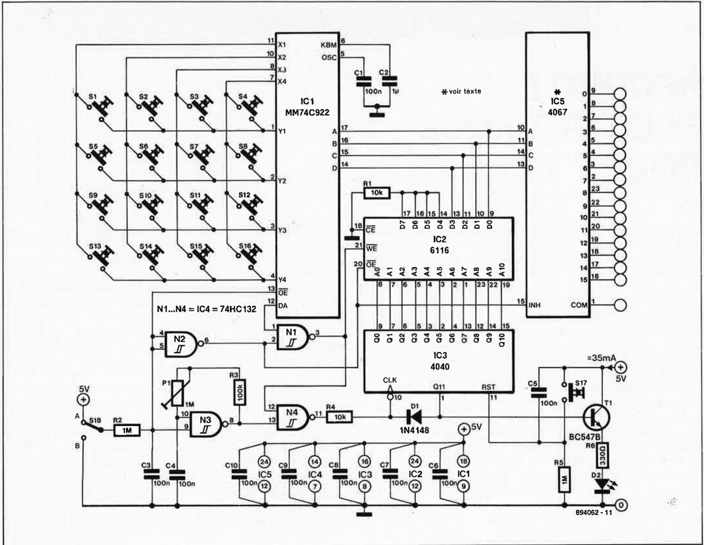
est impossible d'utiliser tel quel le signal DA original sous peine de compromettre la synchronisation car le risque de provoquer des états aléatoires est loin d'être négligeable. Le retard introduit par le fonctionnement des opérateurs logiques a pour effet de "remettre les montres à l'heure". Le retard supplémentaire provoqué par la résistance R4 et par la capacité d'entrée y contribue également.
