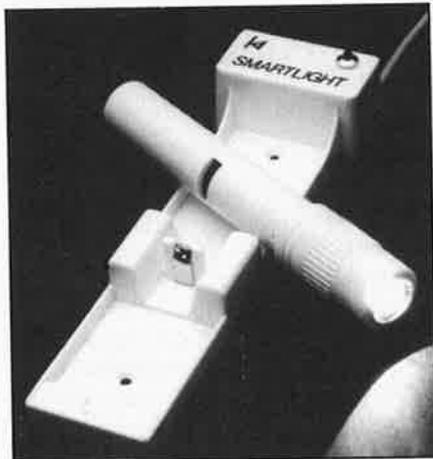
On remplace tout simplement les deux piles par deux accus au CdNi et on transforme le support d'origine en chargeur pour accus CdNi.
