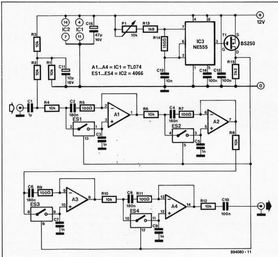
appel au condensateur de couplage C1 de sorte que les amplificateurs opérationnels puissent être réglés quasi-symétriquement bien que l'on ne dispose que d'une unique tension d'alimentation. A la sortie, on débar-
