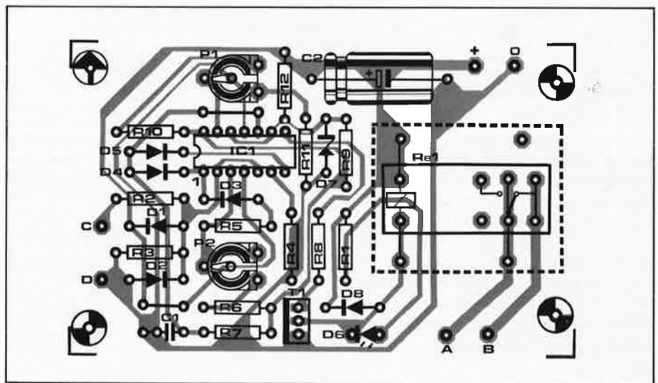
ple). Quand la tension aux bornes de la batterie atteint 13,8 V, la sortie de A1 devient basse : le contact du relais s'ouvre et la charge est interrompue.
