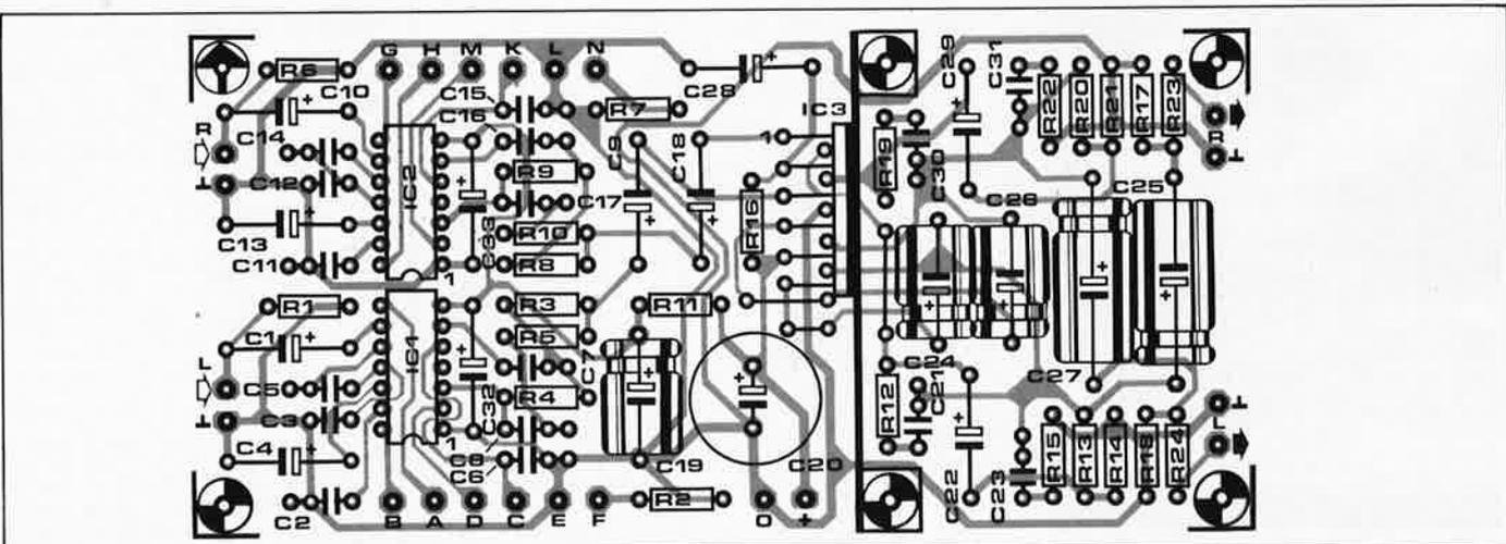
Le TDA 2004 aussi se contente de quelques composants pour la définition du gain en tension (R13/R14 et R20/R21: gain de 40 dB environ), pour la limitation de la bande passante (R12 et R19: largeur de la bande passante de 22 kHz approximativement), pour la protection contre les court-circuits et les charges inductives.
