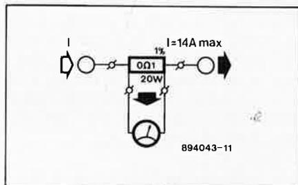
Attention, lors du montage, à ce que les bornes de mesure entre les contacts de prise de courant soient parfaitement soudées pour éviter la prise en compte d'une résistance parasite introduite par les bornes de connexion.
