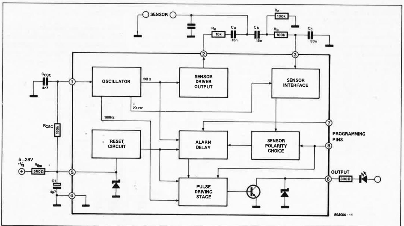
filtre passe-bande rudimentaire mais efficace centré sur 50 Hz. Ce filtre n'est nécessaire que dans les cas difficiles. Dans la plupart des applications, il suffit de remplacer les condensateurs  $C_a$  et  $C_b$  par un pont en fil de câblage.
