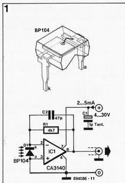
Comme l'appareil en question se devait d'être transportable puisque l'afficheur à tester se trouvait dans le tableau de bord d'un Boeing 737, il fut décidé de concevoir un montage à connecter à un lecteur de cassettes: c'est ainsi que naquit un microphone bizarre capable de capter des rayons IR au lieu de sons. Nous avons poussé la miniaturisation de ce microphone à un point tel que l'ensemble terminé a finalement trouvé place à l'intérieur (!) d'une fiche DIN métallique (figure 2).
