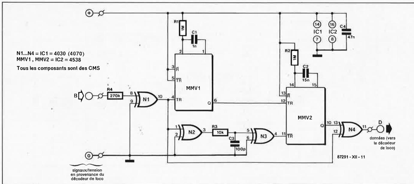
47  $\mu$ F/6 V du mini-circuit imprimé du décodeur de locomotive de Märklin. L'entrée est reliée au conducteur marron de ce décodeur (voire au conducteur rouge, cela n'a plus la moindre importance maintenant) et la sortie est connectée à la broche 15 du circuit intégré à 16 broches présent sur le décodeur. Ce circuit porte le sigle de Märklin ou de Zymos.
