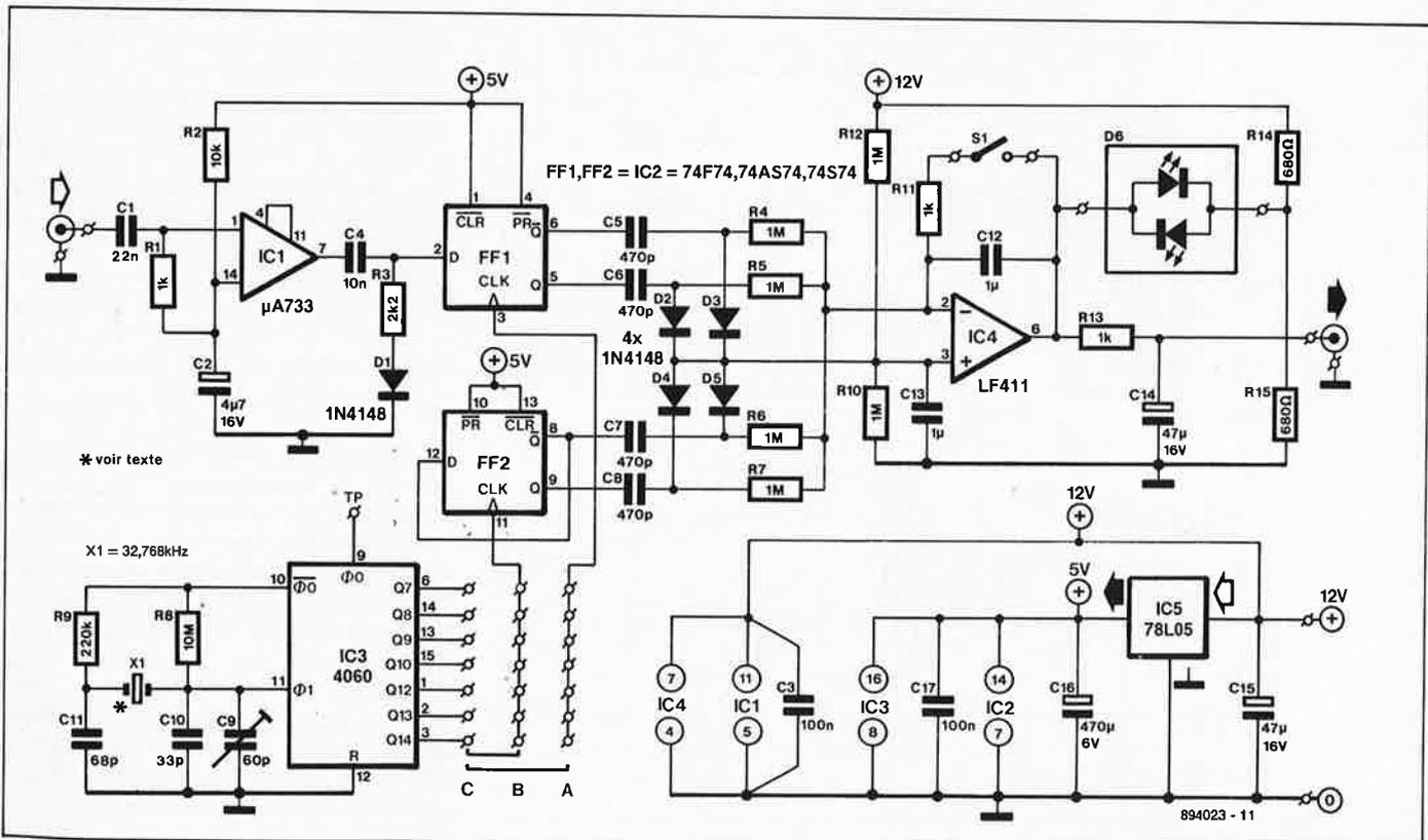
En cas d'instabilité de la fréquence d'entrée (celle de l'oscillateur à stabiliser), les sautes d'amplitude de la tension de commande permettront de corriger la dérive de l'oscillateur à stabiliser.
