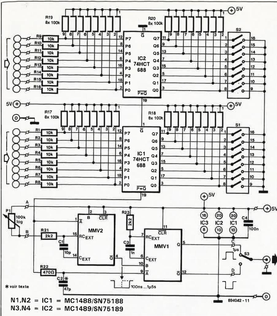
que le monostable MMV1. La remontée de la sortie Q de MMV2 autorise le déclenchement de MMV1 si la sortie des comparateurs est toujours à zéro. Le choix d'un potentiomètre logarithmique pour P1 permet de régler précisément les durées d'impulsion les plus courtes. L'impulsion de MMV1 servant au déclenchement de l'oscilloscope est de durée fixe : 1  $\mu$ s, déterminée par R23 et C3.
