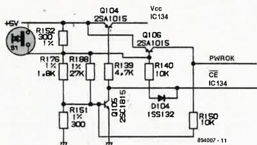
veau logique bas ce qui produit une remise à zéro du microprocesseur. Ce n'est qu'une fois que la ligne PWROK a retrouvé un niveau haut que le microprocesseur débute son cycle de remise à zéro, processus parfaitement identique à celui qu'entraîne une remise sous tension de l'ordinateur. On le voit, notre touche de RAZ n'a pas d'autre fonction à remplir que de court-circuiter la résistance R152.
