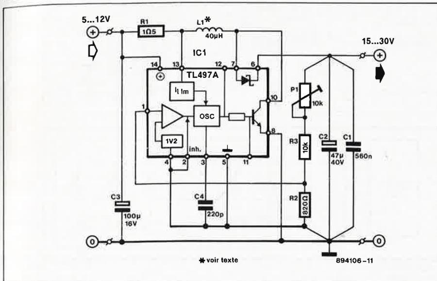
visueur de tension de sortie. Une connexion ira directement de ce point à la broche 4 (masse de la tension de référence interne) et à la broche 5 du circuit intégré. L'émetteur du transistor de commutation interne est raccordé directement au pôle négatif du condensateur de sortie. Veillez à ne pas faire circuler le courant de l'émetteur par les pistes utilisées par la référence de tension interne.
