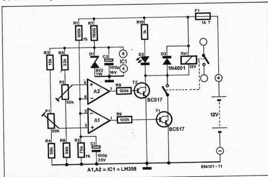
contact K1 maintient le relais excité et donc le chargeur alimenté même lorsque la tension de batterie a dépassé le seuil inférieur et que T2 a cessé de conduire.
