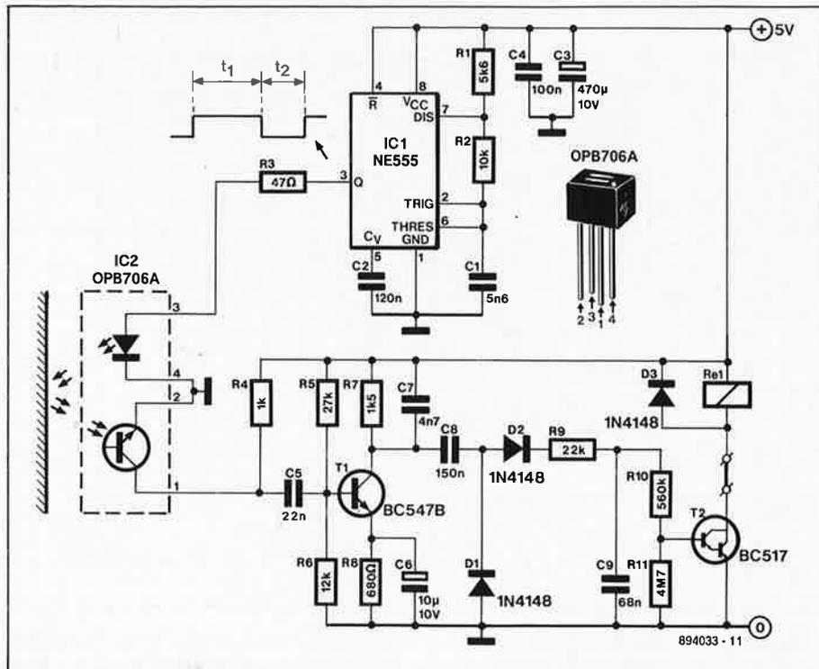
ificateur classique dont le gain est de 80. Le réseau de polarisation d'entrée et le condensateur C5 constituent un filtre passe-haut. Le point de fonctionnement choisi détermine sur le collecteur de T1 une tension de 3 V. Le détecteur constitué par C8 et la diode D1 présente à R9 des impulsions positives de 60  $\mu$ s de durée. Le condensateur de l'intégrateur R9/C9 se charge lorsque des impulsions se présentent. Si la quantité de lumière réfléchiée est
