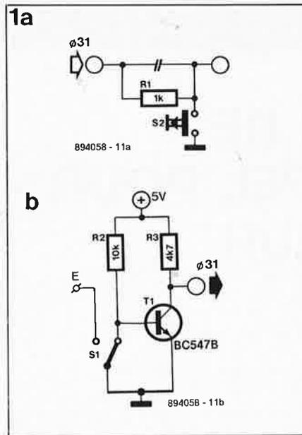
la mémoire tampon. Nous pouvons gaillardement utiliser cette entrée pour y raccorder un bouton-poussoir de RAZ. Le schéma de la figure 1a nous montre un montage ultra-simple. La résistance de 1 k $\Omega$  évite une mise à la masse directe de la sortie de l'ordinateur lors de la fermeture des contacts de S2.
