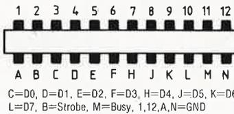
WS 7000, embase de l'interface de sortie parallèle à 8 bits (côté soudures)
