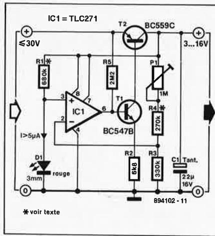
teur peut, pour la régulation, se contenter d'une faible excursion en tension. Cette caractéristique est indispensable en raison du taux de montée (*slew-rate*) très médiocre que présente cet amplificateur opérationnel CMOS lorsqu'il se trouve en mode de polarisation réduite.
