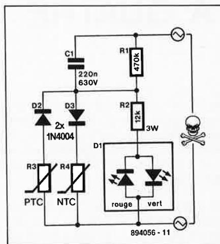
re reste à l'intérieur de la plage de sécurité. Au fur et à mesure que la température augmente et que, peu à peu, elle se rapproche de la limite supérieure de cette plage de sécurité, la couleur de la lampe-témoin vire au rouge pour nous avertir du danger de surcharge qui menace l'appareil si nous le laissons fonctionner.
