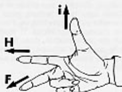
Fig. 1. Règle des 3 doigts de la main droite.
