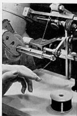
Fig. 7 bis. Préparation du bobinage à grande vitesse d'un cadre mobile, en fil cuivre de 25 microns.
