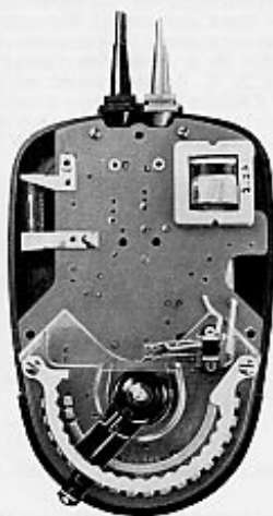
Fig. 14. La platine du MONOC, vue avant. On reconnaît, en bas, le commutateur, et à droite, les contacts "Continu-Alternatif".
