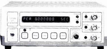
Ce fréquencesmètre en kit, unique sur le marché, permet au technicien et à l'amateur d'accéder enfin à des performances et un agrément d'utilisation dignes d'un matériel professionnel bien plus onéreux. Son câblage, simplifié à l'extrême, ne présente aucune difficulté. (Utilisation de circuits double-face à trous métallisés). Ce kit bénéficie du nouveau prescaler très sensible.
