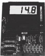
**NOUVELLE VERSION GRANDE AUTONOMIE.** -50 à +150 °C. Résolution 0,1 °C (Sans boîtier).
