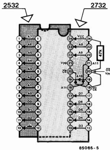
Figure 5. Une paire de supports à 24 broches enfichés l'un dans l'autre et interconnectés selon les indications données dans le texte, permet aussi le remplacement d'une 2532. Le support supérieur est celui de la 2732, le support inférieur simulant la 2532.
