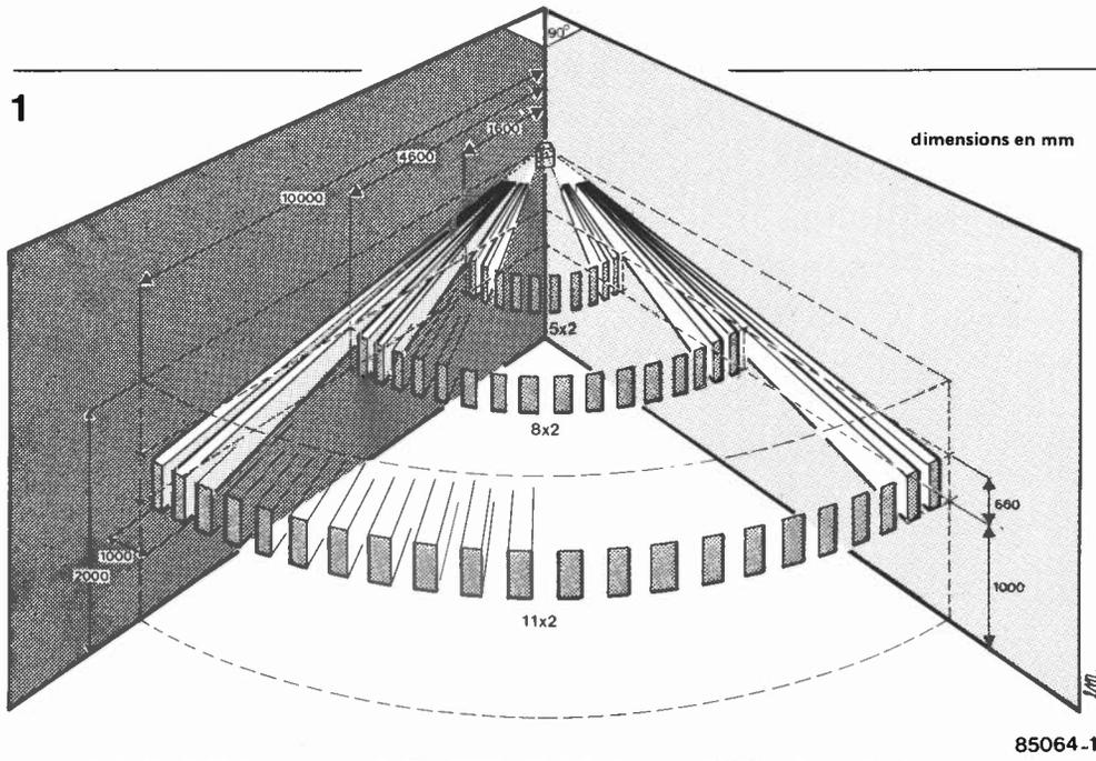
Figure 1. Ce croquis montre les domaines de balayage les plus favorables d'un détecteur IR. Le découpage en bandes est dû à la focalisation du rayonnement infrarouge réalisée à l'aide d'une lentille de Fresnel.
