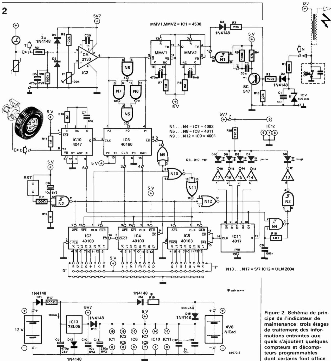
Figure 2. Schéma de principe de l'indicateur de maintenance: trois étages de traitement des informations entrantes auxquels s'ajoutent quelques compteurs et décompteurs programmables dont certains font office de diviseurs et l'étage de visualisation à LED.
