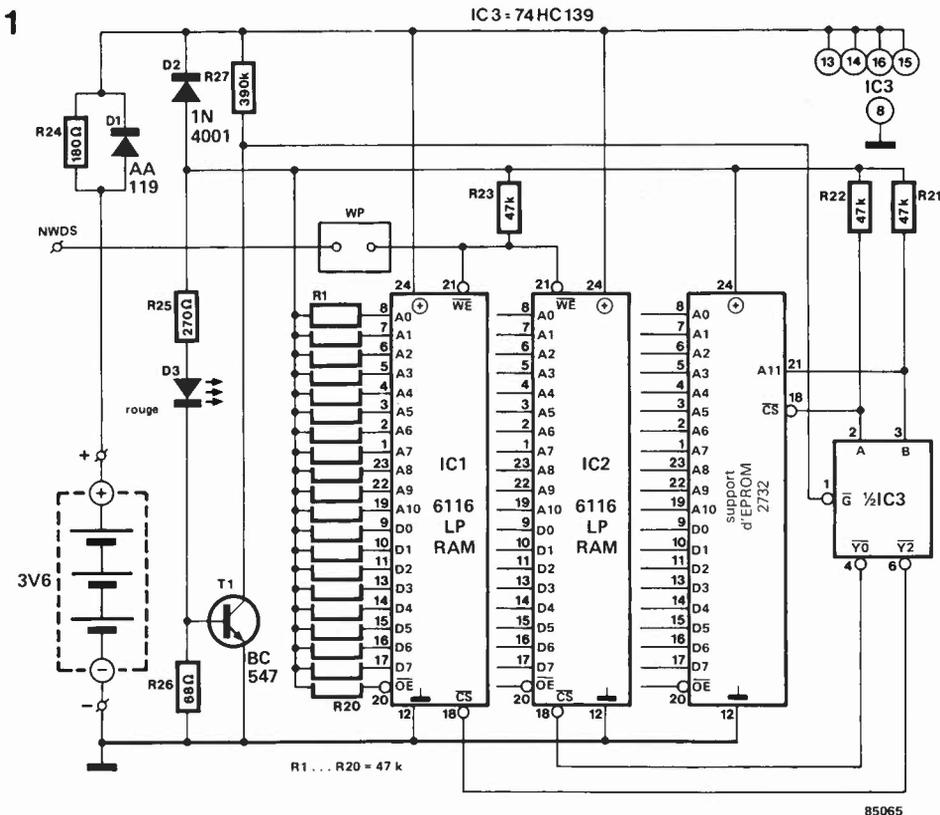
Figure 1. Le schéma de principe de la pseudo-2732 se caractérise principalement par une commutation de la tension d'alimentation aussi simple qu'efficace, la mettant ainsi à l'abri d'une perte de données accidentelle.
