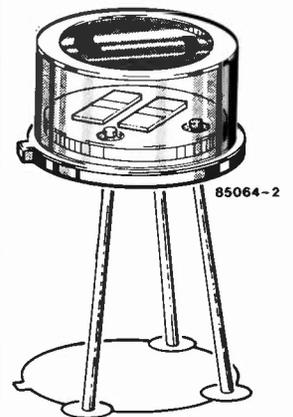
Figure 2. Pour ceux qui n'ont jamais vu un RPY94 de près, voici à quoi il ressemble. Il faut éviter d'entrer en contact avec la surface supérieure de ce capteur, la présence de poussière ou d'empreintes grasses en dégradant sensiblement les performances.
