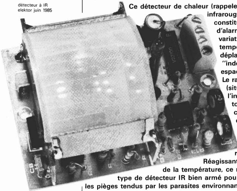
Ce détecteur de chaleur (rappelez-vous le chauffage par infrarouges) est partie constituante d'un système d'alarme et décèle des variations rapides de température nées du déplacement de sujets, "indésirés" ou non, dans un espace clos.
