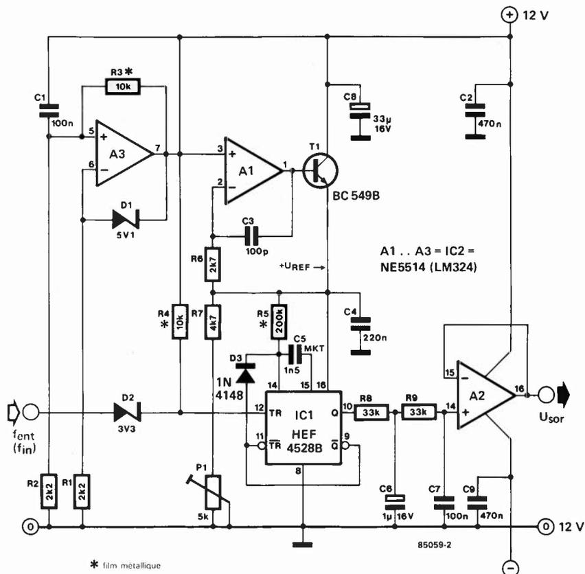
Figure 2. Schéma du convertisseur fréquence/tension (f/U).
