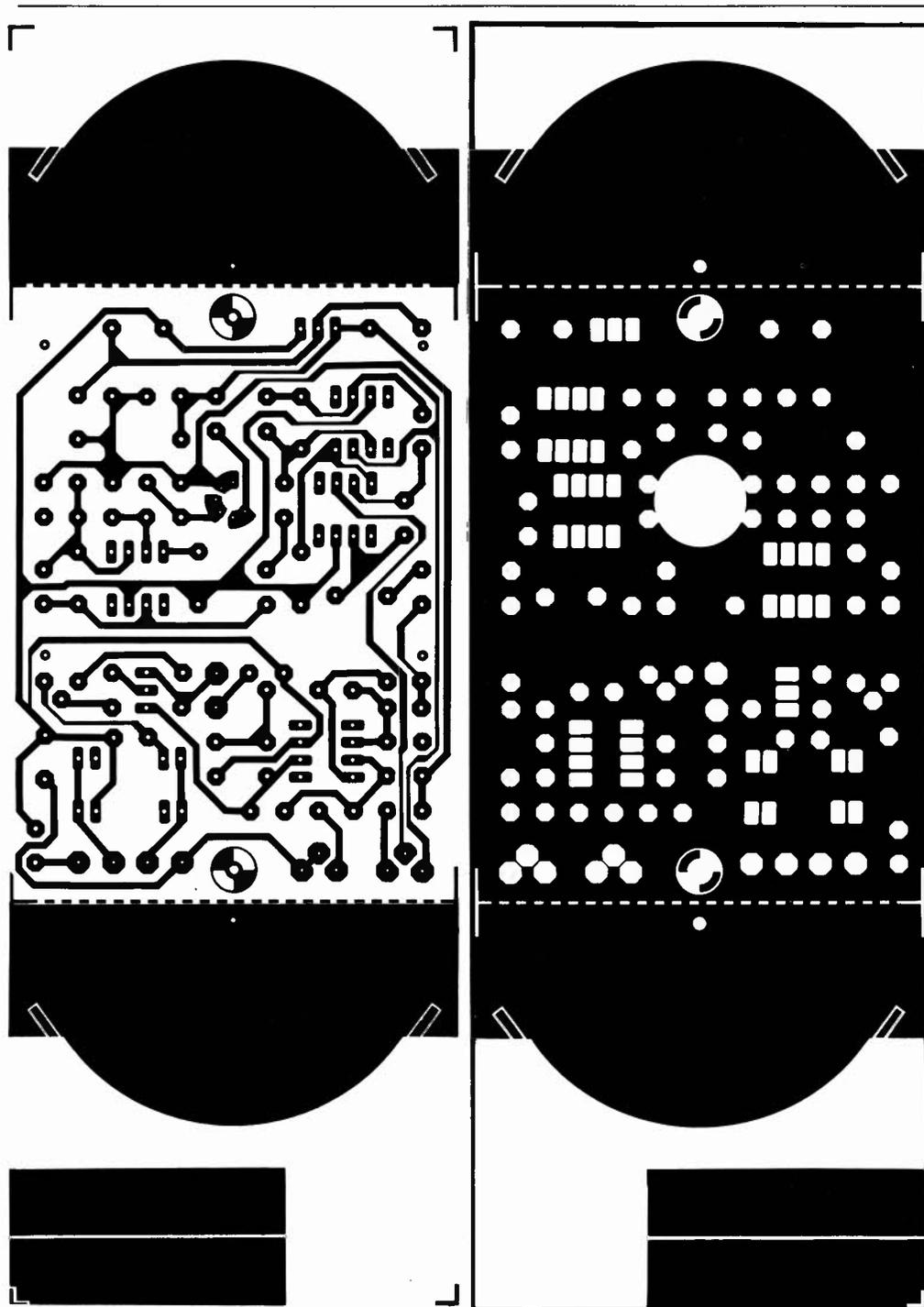
Figure 5. Représentation du dessin des pistes et de la sérigraphie de l'implantation des composants du détecteur IR. Bien que le plan de masse soit loin d'être une nécessité absolue, il améliore sensiblement le fonctionnement du montage.
