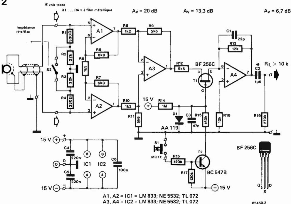
Figure 2. Le préamplificateur pour microphone à entrée symétrique.
