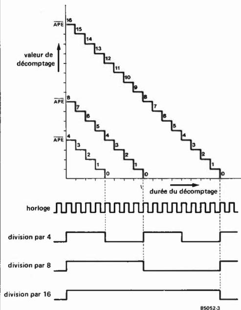
Figure 3. Le principe de la division de fréquence à l'aide d'un décodeur programmable est illustré ici par une courbe en marches d'escalier. Plus la valeur de décomptage (axe vertical) est élevée, plus le décomptage est long; la fréquence du signal de sortie du décompteur n'en est que plus basse.
