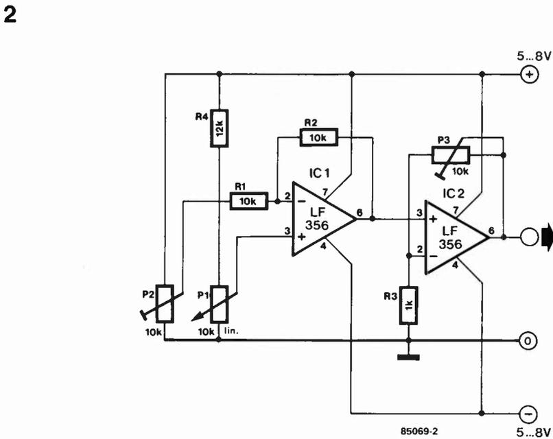
Figure 2. Pour chacun des deux potentiomètres, il faut un circuit permettant le réglage du zéro, indépendamment de la position mécanique et le réglage du gain en tension afin de couvrir toute la plage de conversion.
