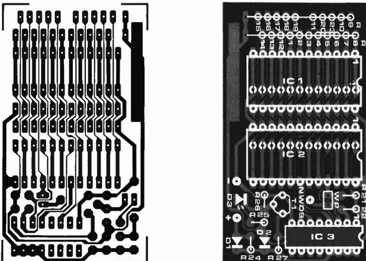
Figure 4. Représentation du dessin des pistes et de la sérigraphie de l'implantation des composants d'un circuit imprimé conçu à l'intention de la pseudo-2732. Grâce à ses faibles dimensions il ne devrait y avoir que peu de problèmes à lui trouver une place dans la plupart des ordinateurs personnels.
