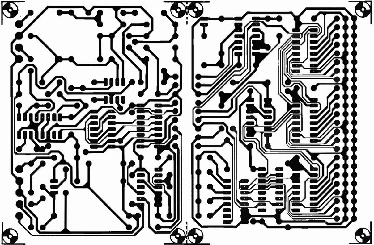
Figure 3. Représentation du dessin des pistes et de la sérigraphie de l'implantation des composants de l'indicateur de maintenance. Les deux platines séparées sont montées en sandwich.
