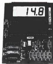
NOUVELLE VERSION GRANDE AUTONOMIE. - 55 à + 150 °C. Résolution 0,1 °C (Sans boîtier).
