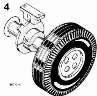
Figure 4. Pour les véhicules n'étant pas pourvus d'un compteur kilométrique VDO, il faut imaginer un dispositif fournissant une impulsion par tour de roue, basé sur un détecteur à effet Hall par exemple.
