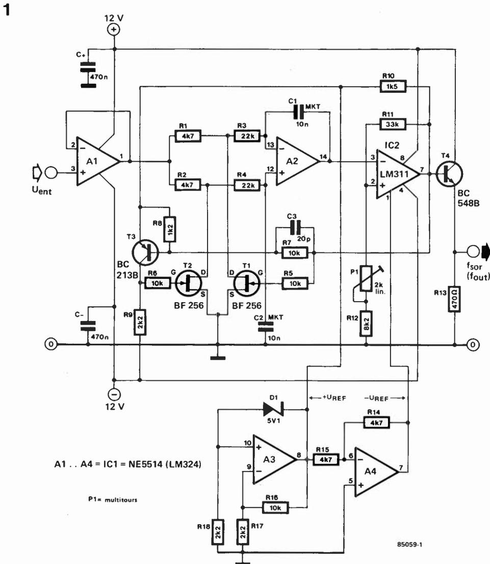
Figure 1. Schéma du convertisseur tension/fréquence (U/f).
