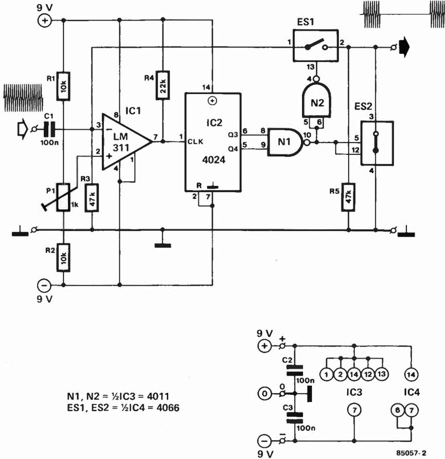
Figure 2. Le circuit du générateur de salves est un compteur de périodes couplé à deux interrupteurs analogiques. Simple comme bonjour!
