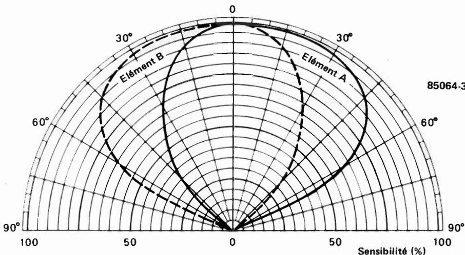
Figure 3. Ce diagramme montre la sensibilité d'un détecteur IR doté de deux éléments céramique (A et B) placés côte à côte, courbe établie en l'absence de lentille de Fresnel.
