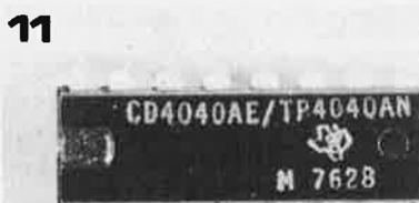
Figure 11. Texas Instruments utilise comme sigle le contour stylisé de l'état du Texas. La série CMOS de cette société porte l'appellation 'Ti CMOS'. Le numéro du type est précédé des lettres 'CD' ou 'TP'. Des modèles sans buffer (série 'A') et avec buffer (série 'B') sont disponibles.
