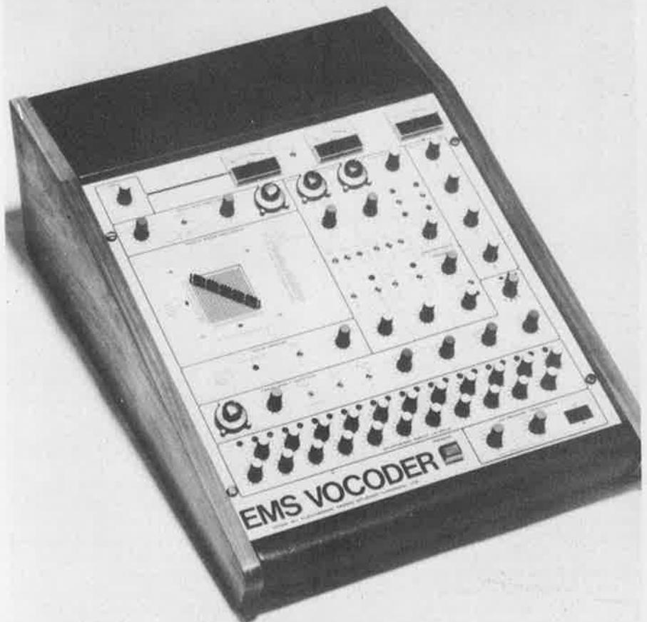
filtres. Ce sont en fait les tensions de commande qui vont régir le jeu de filtres du synthétiseur et représentent une analyse spectrale en temps réel du signal phonique.
