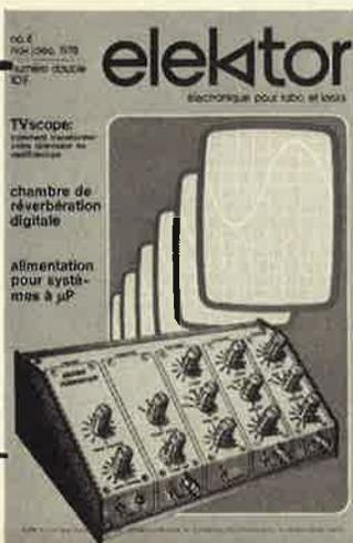
L'oscilloscope est, sans aucun doute, l'appareil le plus utile qui soit dans un équipement électronique de test, et il est, dans la plupart des cas, virtuellement indispensable. Utiliser un téléviseur classique comme écran de visualisation permet la construction d'un oscilloscope pour une dépense minime.
