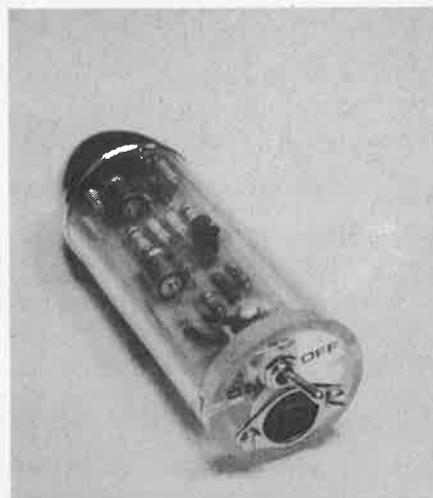
capsule du microphone, et fonctionnant en transformateur d'impédance avec une impédance de sortie de quelques centaines d'ohms.
