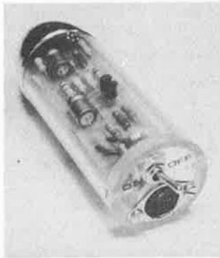
Ce préamplificateur à faible bruit, compact, alimenté par pile, augmente sensiblement le niveau du signal d'un microphone à électret, ou d'un microphone dynamique à faible impédance.
