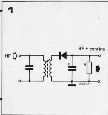
citée de la réception. En effet, il suffit de redresser une alternance du signal modulé en amplitude pour le détecter (le démoduler). Le signal BF est alors superposé au signal HF; il suffit ensuite de lui faire traverser un circuit passe-bas pour éliminer la composante HF, et l'on obtient le signal BF auquel s'ajoute une tension continue. La figure 1 montre le circuit utilisé.
