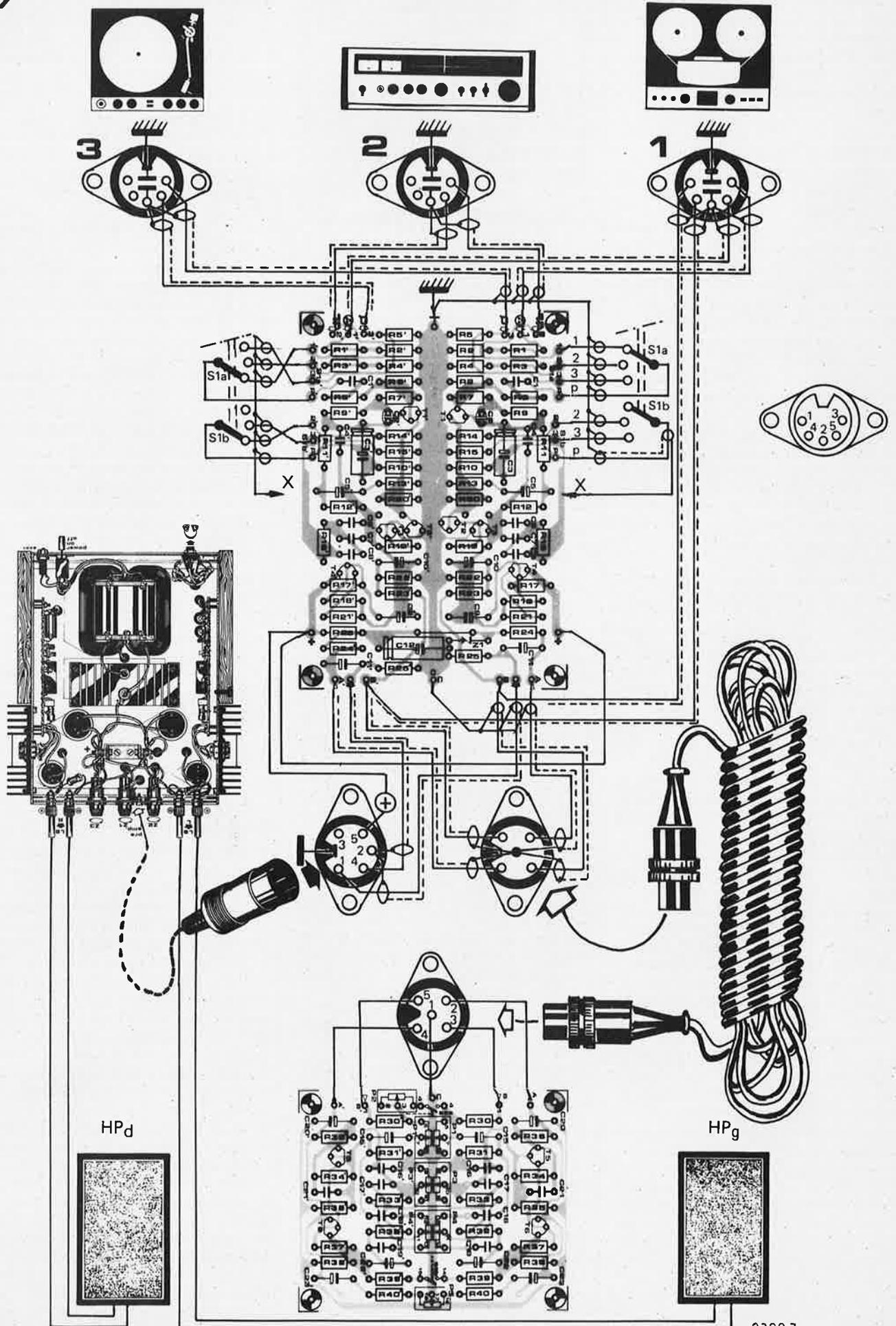
l'alimentation principale, alors que la masse "de sortie" est raccordée à l'entrée de l'amplificateur de puissance. La figure 7 montre un câblage recommandé en prenant le cas le plus compliqué comme exemple (préampli, correcteur et ampli de puissance séparés).
