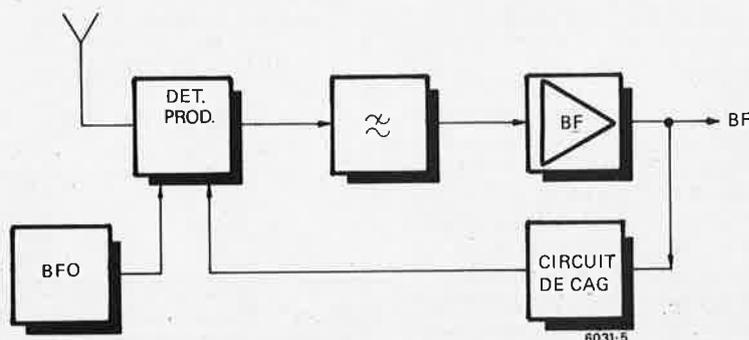
par L1B, la varicap D12 et le condensateur ajustable C30. Le signal passe alors via C2 et C3 sur la base de T1, qui constitue avec T2 et T3 le détecteur de produit. BFO est équipé de T6, il est accordé par L2 et la varicap D13.
