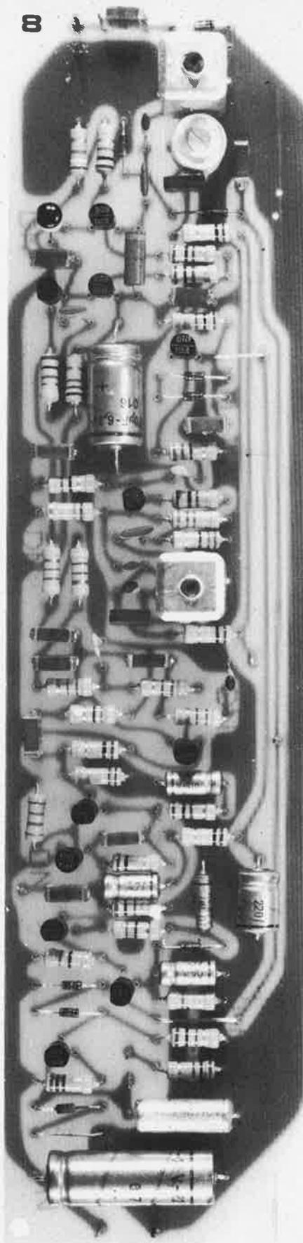
Figure 7. Câblage du circuit imprimé du récepteur (EPS 6031).
