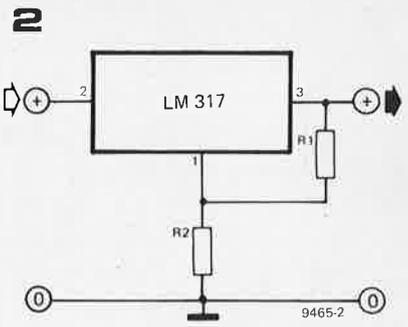
Figure 2. Détermination de la valeur de la tension régulée au moyen de deux résistances.
