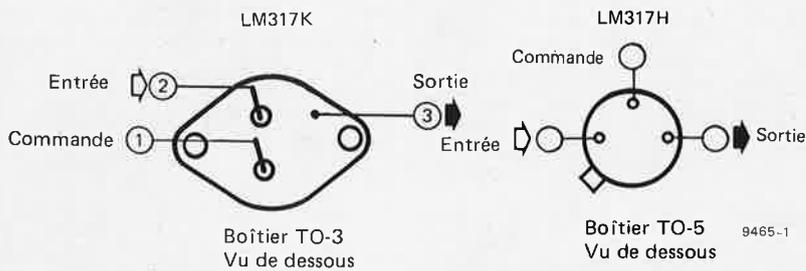
Figure 1. Brochage des LM 317 H et LM 317 K.
