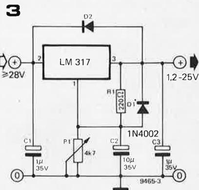
Figure 3. La réjection d'ondulation et la régulation ligne du LM 317 peuvent être améliorées en ajoutant des condensateurs de découplage; des diodes de protection sont alors indispensables.
