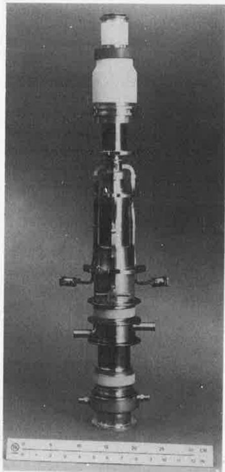
Il faut alimenter le composant par 8 A et 80 kV pour obtenir la puissance de sortie totale. Jusqu'à présent l'oscillateur-gyatron expérimentale n'a pas encore travaillé en continu, mais il n'a fourni que des puissances par impulsions. Ce faisant, même des puissances de crête dans l'ordre de 248 kW ont été réalisés.
