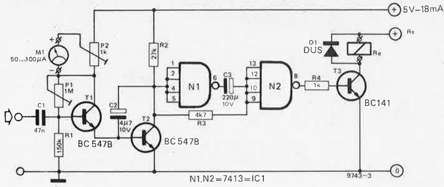
Le circuit du changeur automatique est décrit à la figure 1. En l'absence d'un signal BF à l'entrée, T1 et T2 sont bloqués. Quand un signal dépassant un certain niveau (déterminé par P1) apparaît à l'entrée, T1 se met à conduire lors des alternances positives. Le signal en sortie de l'émetteur de T1 est alors intégré par C2 et T2.
