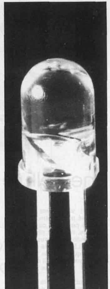
**Figure 6 - Par transparence on reconnaît la cathode à son électrode plus massive que celle de l'anode. La broche de la cathode est plus courte et le boîtier est aplati de ce côté là. Une inversion de polarité («juste pour voir») reste sans conséquences à condition que la tension appliquée ne dépasse pas la tension de service normale.**
