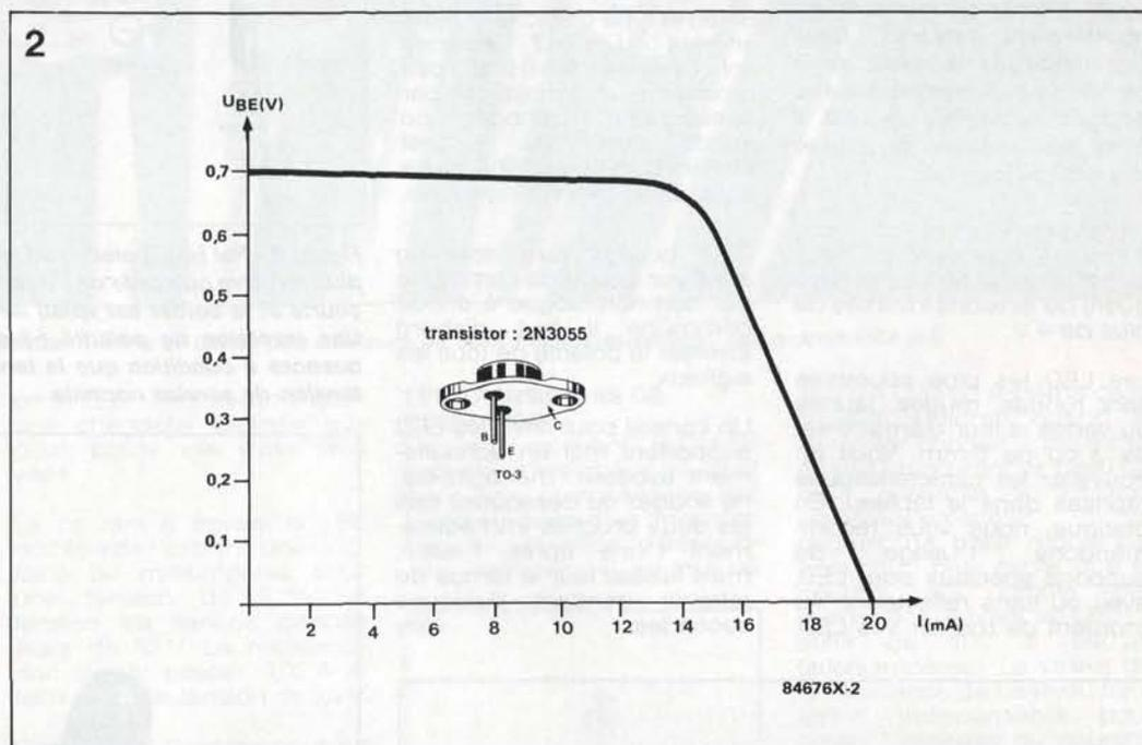
Figure 2 - Dans les conditions idéales, le 2N3055 TL (topless) peut fournir 10 milliwatts.
