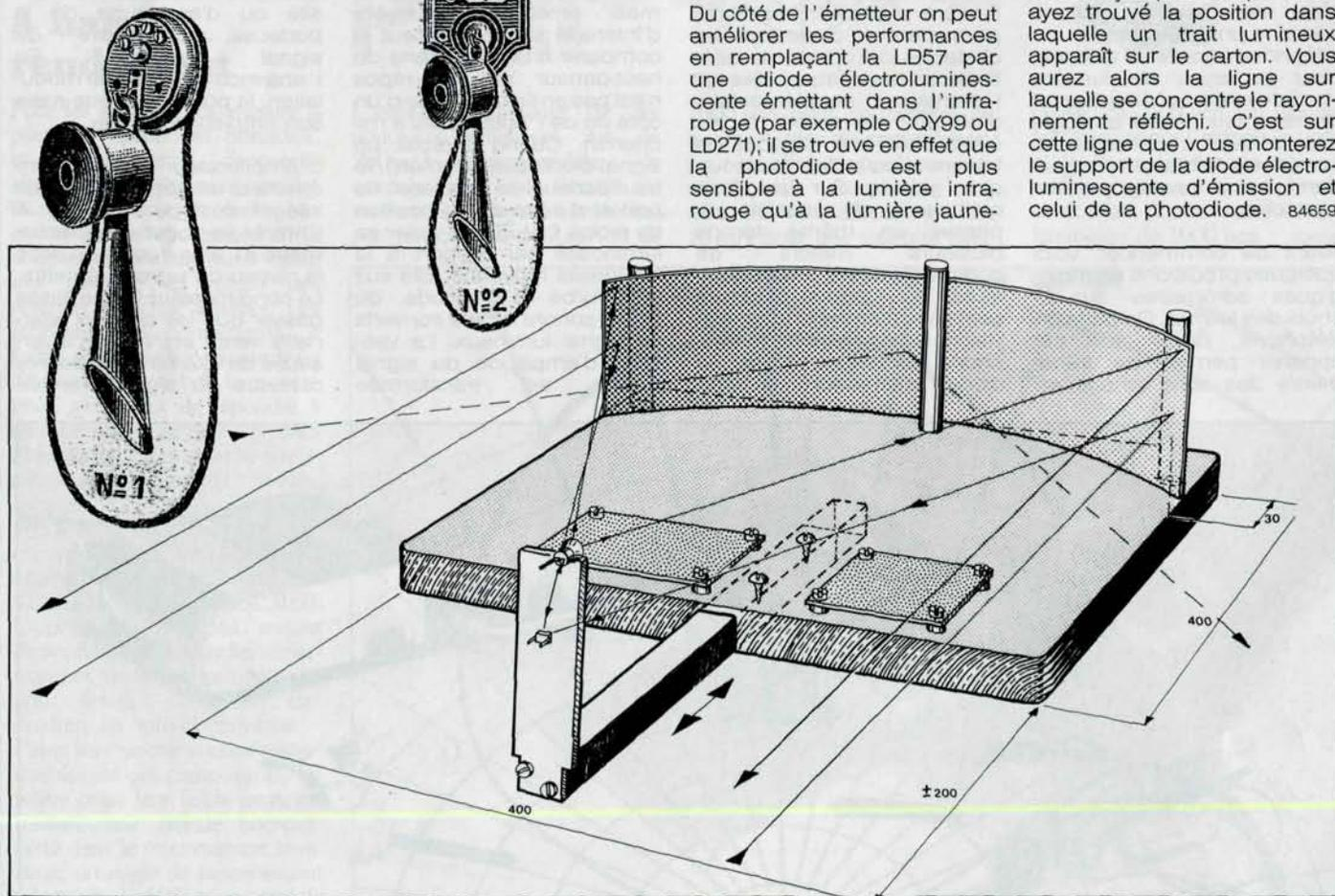
Figure 4 - Réflecteur expérimental pour le téléphone optique. Si vous voulez vous livrer à des expériences intéressantes sur la portée de votre téléphone optique, vous pourrez doter l'émetteur et le récepteur chacun d'un réflecteur confectionné avec quelques bouts de bois et une rectange de tôle polie.
