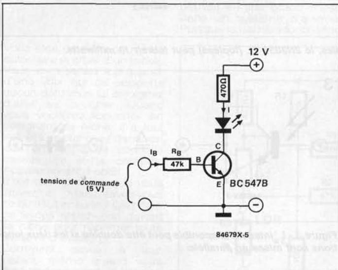
**Figure 5 - Le circuit de commande classique de la LED comporte outre sa résistance de limitation un transistor avec sa résistance de limitation du courant de base. Le circuit de commande n'a à fournir qu'un courant d'intensité minuscule pour qu'une (ou plusieurs) LED s'allume(nt).**
