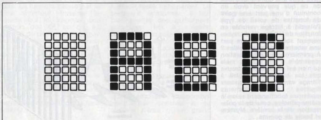
**Figure 4 -** Avec les matrices de points la fragmentation est poussée encore un peu plus loin, et l'on obtient une définition améliorée. C'est également sur une matrice de points qu'apparaissent les caractères sur les écrans d'ordinateurs et sur les imprimantes matricielles, comme leur nom l'indique.
