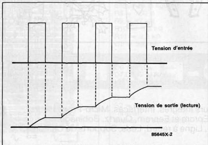
La courbe supérieure représente les impulsions, la courbe inférieure la tension aux bornes du condensateur. L'indication du voltmètre croît au fur et à mesure que des impulsions sont appliquées. En quelque sorte le voltmètre **compte** les impulsions.
