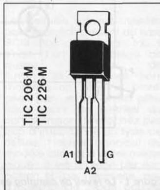
Figure 3 - Le brochage du triac. Il est important de respecter la disposition des anodes 1 et 2 sans les intervertir. L'anode 2 est reliée à la surface métallique du triac.
