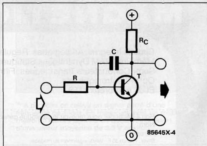
Les caractéristiques de notre circuit intégrateur sont loin d'être optimales. Plus la tension du condensateur augmente et moins le courant de charge est important, puisqu'il dépend de la tension aux bornes de la résistance. Un transistor permet d'améliorer le montage.
