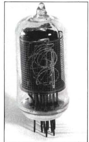
Figure 2 - Dans l'antiquité de l'électronique, c'est ce genre d'afficheurs que l'on utilisait. Un détail curieux : les chiffres n'apparaissent pas sur le même plan les uns que les autres.
