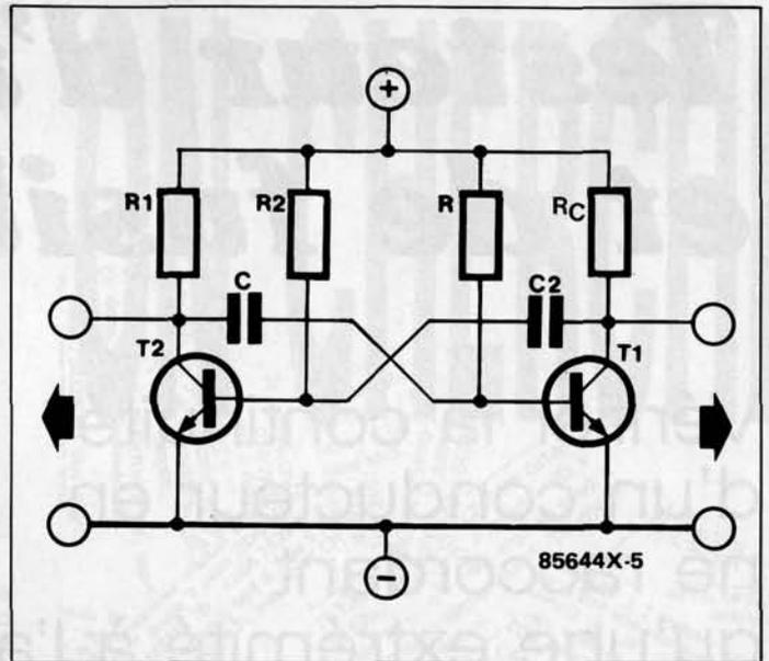
La tension qui règne entre les deux collecteurs est une tension alternative égale à la différence entre les deux tensions de sortie.
