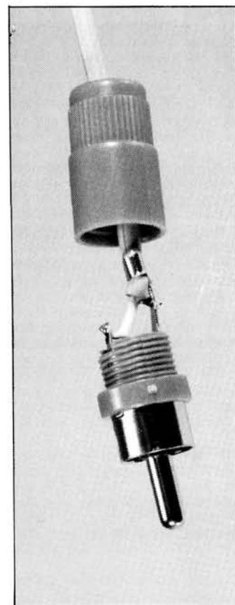
Figure 5 - La fiche «tulipe» est (assez) facile à utiliser. L'étrier doit immobiliser le câble sans le sectionner ! Ici la tresse de blindage entre en contact avec la partie métallique de la douille.
