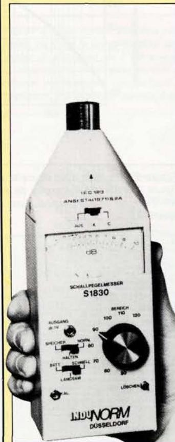
Figure 8 - Un appareil de mesure professionnel utilisé pour la protection contre le bruit. La plage de mesure s'étend de 35 à 130 dB(A). Pour ces derniers niveaux, il existe -heureusement- une sortie pour la lecture à distance.
