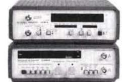
**UC10AE :** 2 entrées, gamme de fréquences de 5 Hz à 100 MHz. Affichage Led 8 digits.
