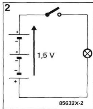
Figure 2 - L'une des trois cellules a été retournée; sa polarité est inversée par rapport à celle des deux autres. La tension, au lieu de venir s'additionner, vient se soustraire de celle du montage en série. Résultat : la lampe ne s'allume plus car la tension qui règne entre ses bornes ne suffit plus à faire circuler le courant qui échaufferait le filament.
