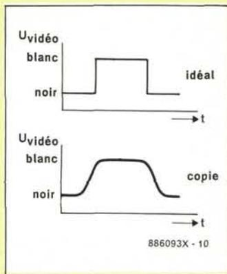
**Figure 1 - Les limites de la bande passante des magnétoscopes ne permettent pas de copier correctement sur la bande magnétique des signaux rectangulaires de fréquence supérieure à 3 MHz. Les harmoniques de fréquence élevée qui constituent le signal rectangulaire sont atténués ou supprimés, ce qui provoque un arrondissement des fronts du rectangle.**
