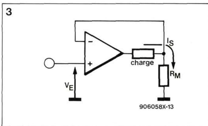
sortie, puisque le passage d'un courant dans une résistance provoque une chute de tension. Comme d'autre part les deux entrées sont au même potentiel, la tension de sortie est égale à la tension aux bornes de la résistance.
