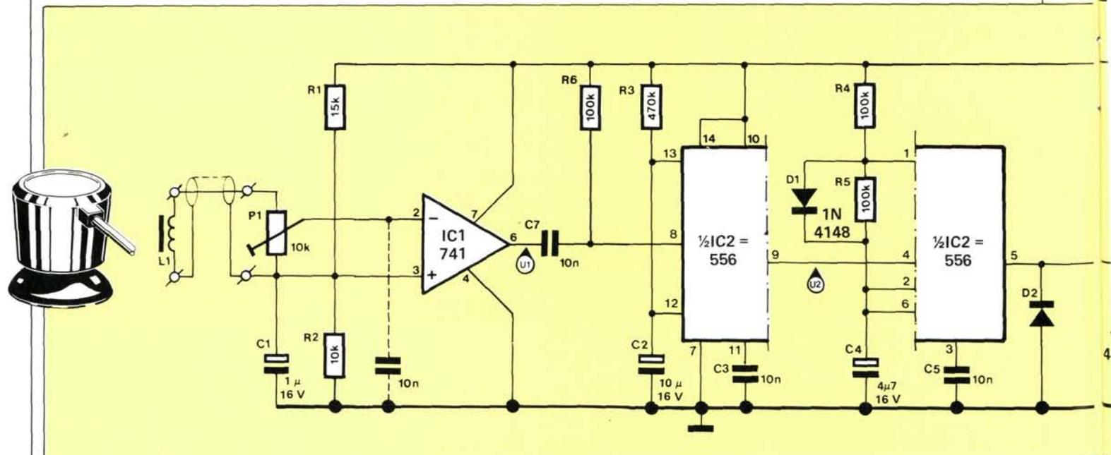
Figure 1 - La tension alternative de la sonnerie du téléphone donne naissance à un champ magnétique variable que le capteur L1 retransforme en tension alternative. Après amplification, ce signal attaque un monostable non redéclenchable qui à son tour permet à un multivibrateur de produire la séquence d'impulsions qui feront clignoter la lampe par l'intermédiaire du relais.
