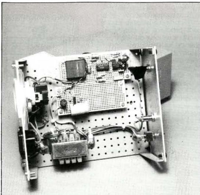
inductance L1 qui se charge de convertir en une tension électrique les variations du champ magnétique produit par la sonnerie du téléphone qui est elle-même un électro-aimant.
