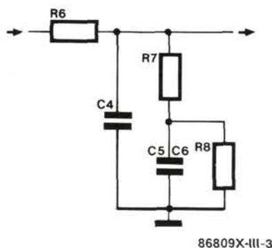
Figure 3 - Ces cinq composants forment le réseau atténuateur de correction RIAA. L'atténuation est plus forte dans l'aigu que dans le grave, de sorte qu'après l'amplification de toutes les fréquences opérée par ailleurs dans cet étage, on obtient un relèvement de l'amplitude des fréquences les plus basses. Sans cet étage, le préamplificateur peut être utilisé comme amplificateur pour microphone.
