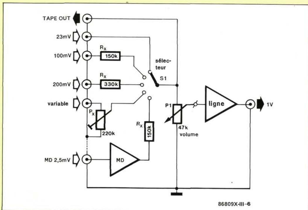
Figure 6 - Adaptation de la sensibilité d'entrée à différentes sources de signal d'amplitude variée. Les résistances fixes peuvent être remplacées au besoin par des résistances variables (cf. figure 7) et inversement.
