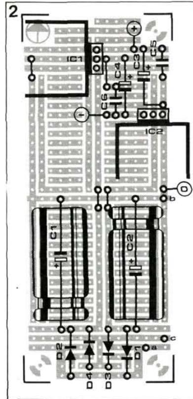
Figure 2 - Les composants de l'alimentation tiennent largement sur une platine d'expérimentation de petit format, à l'exception du transformateur, de l'interrupteur et du fusible. Avez-vous lu la légende de la figure 1 à propos du montage éventuel des régulateurs sur un même radiateur ?
