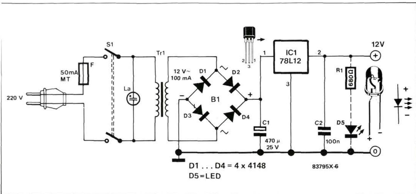
Figure 4 - Schéma d'une alimentation séparée, convenant au circuit de sonnerie « lumineuse » pour téléphone, en lieu et place d'une pile qui ne tiendrait pas le coup bien longtemps. Pour simplifier les choses, on peut également faire appel à un bloc d'alimentation tout fait.
