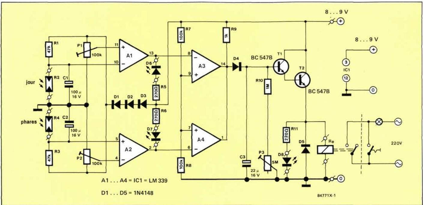
Figure 1 - Le schéma du circuit de commande automatique et temporisé d'éclairage de garage commandé par les phares de la voiture comporte deux capteurs ; l'un surveille la lumière ambiante (jour-nuit), l'autre détecte l'arrivée de la voiture. Il y a en outre deux comparateurs à seuil réglable (A1 et A2), deux inverseurs (A3 et A4), un opérateur ET câblé (A3, A4, R9 et D4), un étage de temporisation (C3, R10, P3) et enfin l'étage de commutation.
