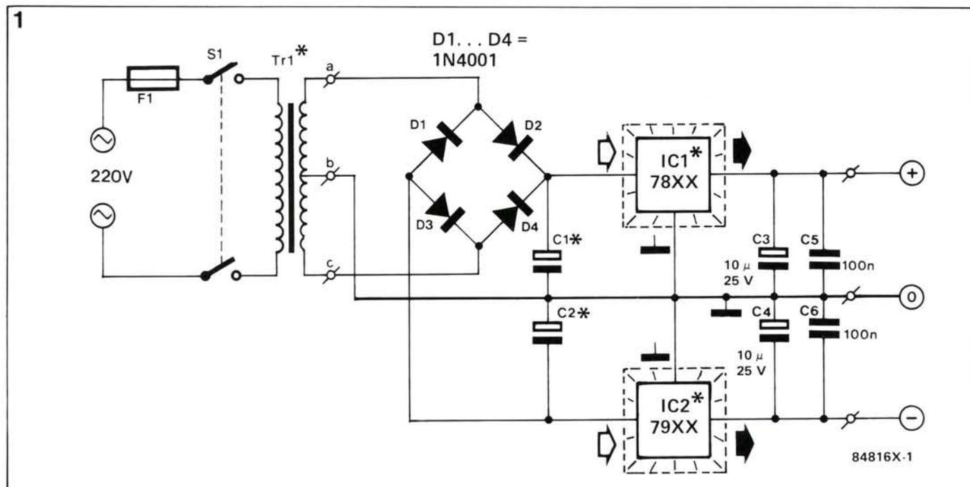
Figure 1 - Pour obtenir une alimentation symétrique, la solution la plus simple et la plus efficace consiste à faire appel à des régulateurs intégrés. Notez la différence de brochage entre les deux régulateurs. Si vous désirez les monter sur le même radiateur, il faut avoir recours impérativement à une plaquette isolante (mica) et une vis de fixation en plastique, ou isolée par un canon et une rondelle isolante si elle est métallique.
