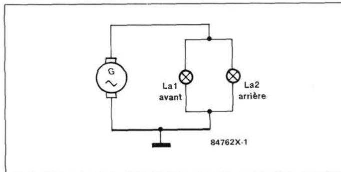
Figure 1 - Le circuit d'éclairage réglementaire pour un vélo est assez primitif en ce sens qu'il ne fonctionne que tant que la dynamo G tourne. À l'arrêt, plus rien !
