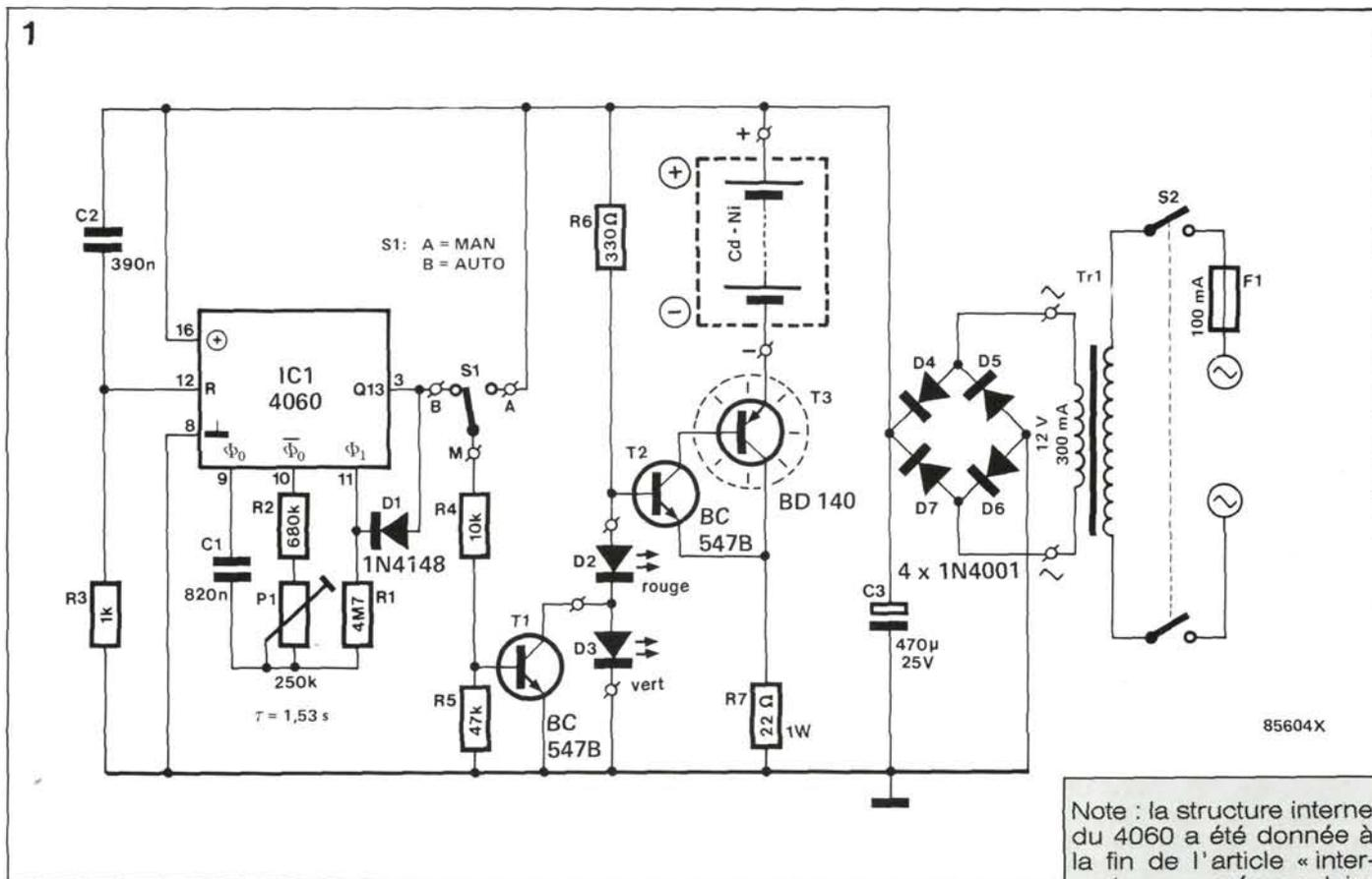
Figure 1 - Pas de mystère : un bon chargeur d'accumulateurs Cd-Ni, c'est une source de courant constant commandé par un temporisateur. Ici la source de courant limite le courant au triple de l'intensité de charge normale (I/10) pendant 3 heures et demie, puis repasse à l'intensité normale. Les accumulateurs doivent toujours être montés en série. Ne soumettre à une charge accélérée que des accumulateurs déchargés à au moins 80%.
