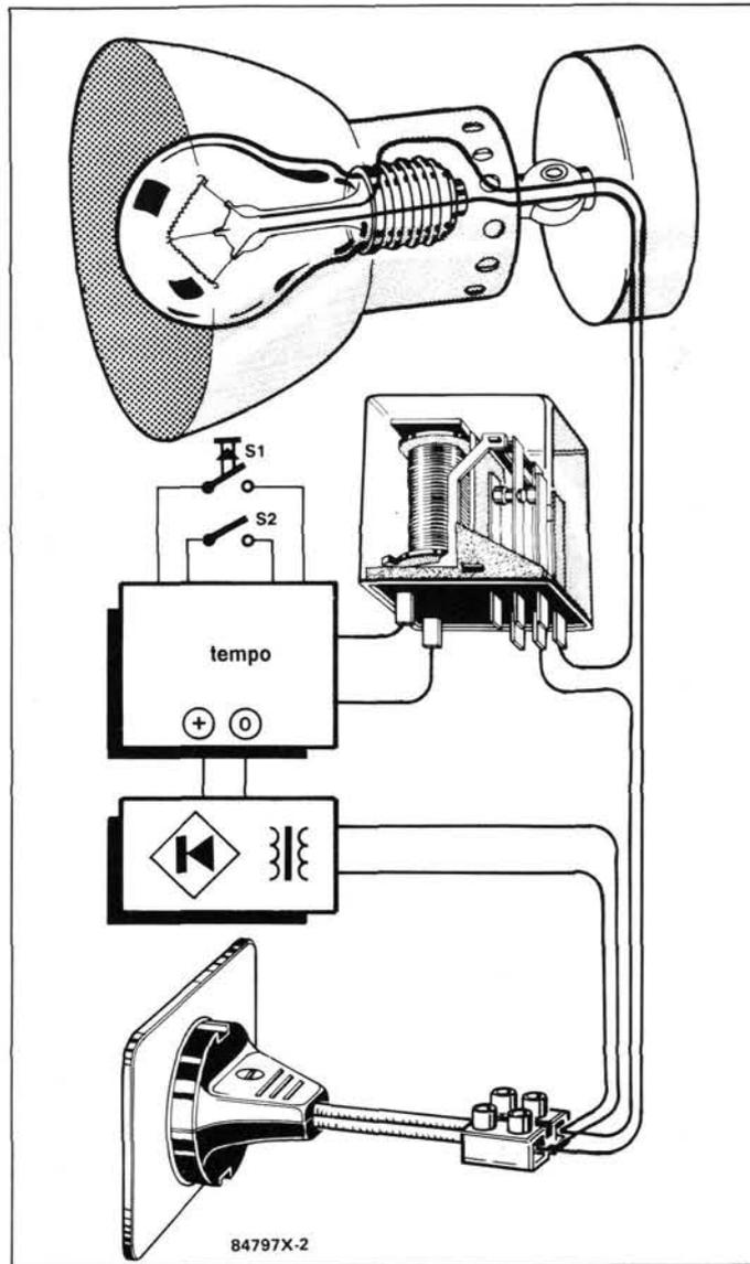
Figure 2 - Schéma de câblage du circuit de temporisation pour lampe de placard ou d'autre chose... En partant du bas, nous avons la prise électrique, le domino distributeur, l'alimentation basse tension (un transformateur et un redresseur non représentés sur la figure 1), le circuit de temporisation, avec le relais et les deux organes de commandes, et enfin la lampe (ici un spot d'éclairage).
