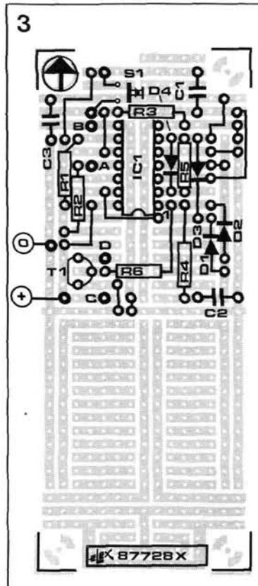
Figure 3 - Plan d'implantation des composants du circuit d'alarme sur la moitié d'une platine d'expérimentation. L'autre moitié pourrait servir par exemple un deuxième circuit qui doublerait le premier avec d'autres capteurs et/ou un autre signal d'alarme (jouer sur la valeur de R4 et R5 pour changer la fréquence de l'oscillateur).
