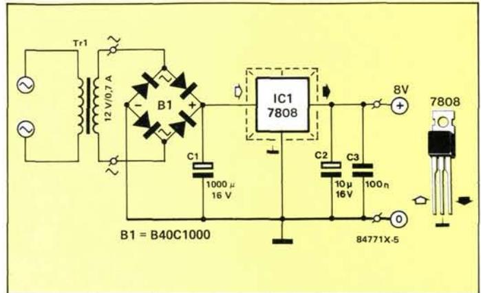
Figure 6 - Schéma d'une alimentation utilisable avec le circuit de commande d'éclairage.
