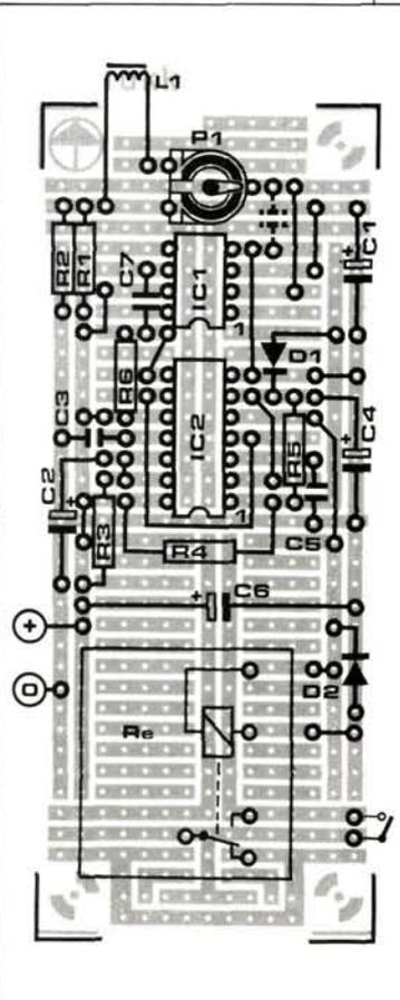
Figure 3 - Même le relais trouve sa place sur la platine d'expérimentation de petit format. La forte densité d'implantation demande un redoublement de votre vigilance.
