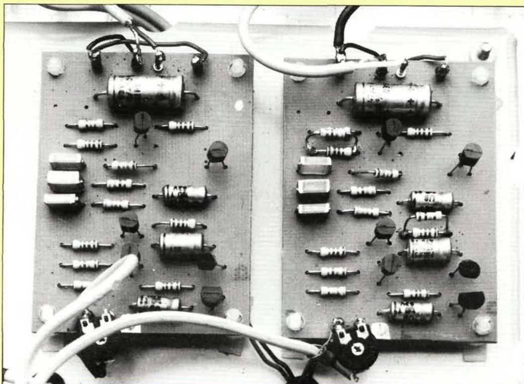
Figure 7 - Un préamplificateur pour cellule MD comporte deux platines dans sa version stéréophonique. Les deux potentiomètres montés en sortie des platines correspondent à la résistance fixe  $R_x$  de 150 k $\Omega$  sur la figure 6.
