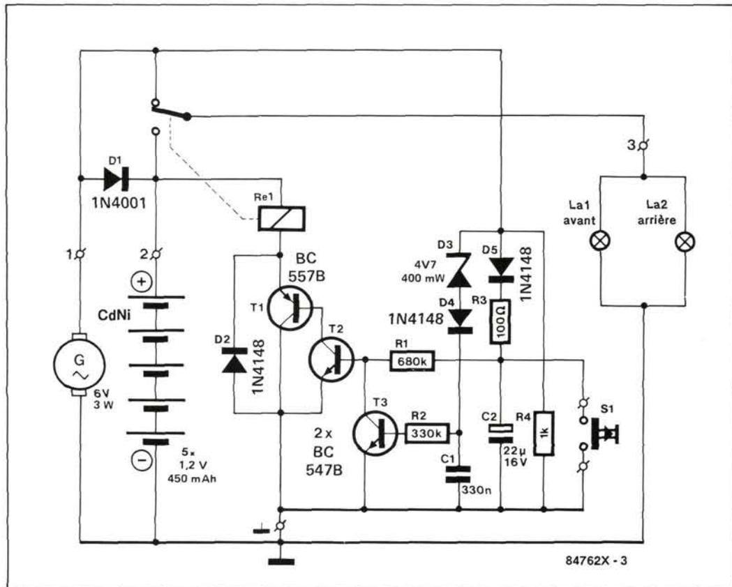
**Figure 3 - Le schéma du circuit d'éclairage automatisé pour bicyclette.** Vous souriez, mais ELEX pense au confort de ses lecteurs cyclistes ! Nous ne tarderons pas d'ailleurs à leur proposer un circuit d'indicateur de changement de direction (ça s'appelle aussi un clignotant) pour vélo.
