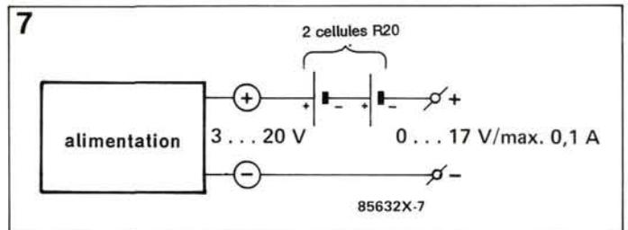
Figure 7 - Astuce pour réduire (passagèrement) jusqu'à 0 V la tension de sortie d'un bloc d'alimentation compact réglable normalement jusqu'à 3 V seulement. Ne laissez pas le débit de courant atteindre des intensités dangereuses pour les piles (dont il suffit de surveiller la température).
