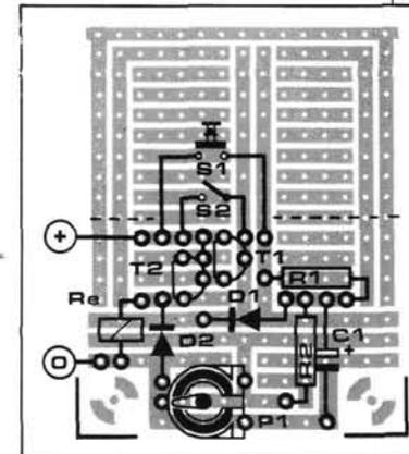
Figure 3 - Plan d'implantation des composants de la figure 1 - exception faite du relais, de l'alimentation et de la lampe elle-même - sur une platine d'expérimentation. L'écart entre les pistes de cette platine ne permet de l'utiliser pour monter le relais auquel il faut appliquer la tension de 220 V.
