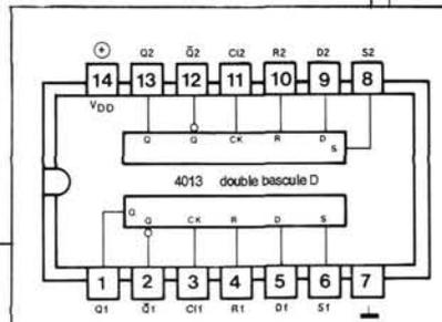
Figure 2 - Deux bascules intégrées dans un circuit intégré à 14 broches, voilà tout ce qu'il faut pour attaquer le transistor qui commande le résonateur qui donne le signal d'alarme ! Mini-circuit, répétons-le puisque c'est vrai. La première bascule détecte l'interruption de la boucle montée entre A et B, la deuxième produit un signal carré de 1 kHz que le résonateur transforme en vibrations sonores.
