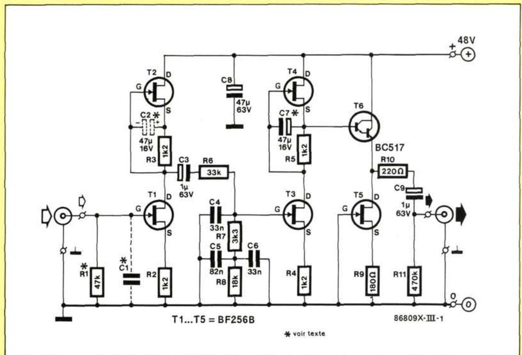
Figure 1 - Le schéma du préamplificateur MD ressemble fort à celui de l'amplificateur de ligne du mois dernier. Le réglage de tonalité variable de l'amplificateur de ligne cède ici la place à une espèce de réglage de tonalité fixe qui est le correcteur RIAA.
