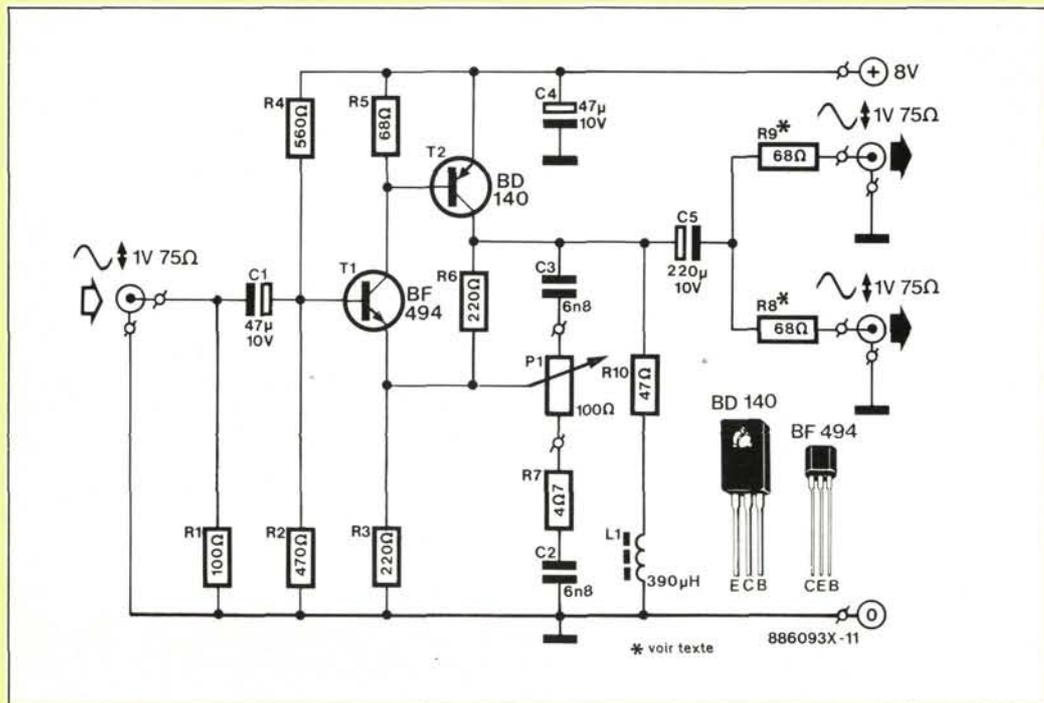
**Figure 2 - L'amplificateur de copie double d'abord l'amplitude du signal d'entrée. Après division pour l'alimentation des deux charges, l'amplitude est redevenue normale. Les transistors ne sont pas des types courants dans nos applications habituelles en basse fréquence.**
