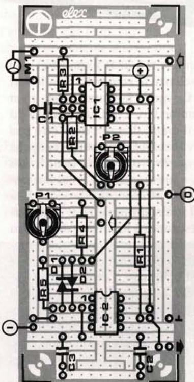
Nous avons parlé de M1 : ce sera un galvanomètre à cadre mobile, à zéro médian réglable mécaniquement. Les graduations du cadran, jouant le même rôle que le flacon dans l'ivresse : elles n'importent pas (mais n'exporteront pas non plus). Si vous disposez d'un galvanomètre d'un calibre différent, le circuit auxiliaire de la figure 2 vous permettra de
