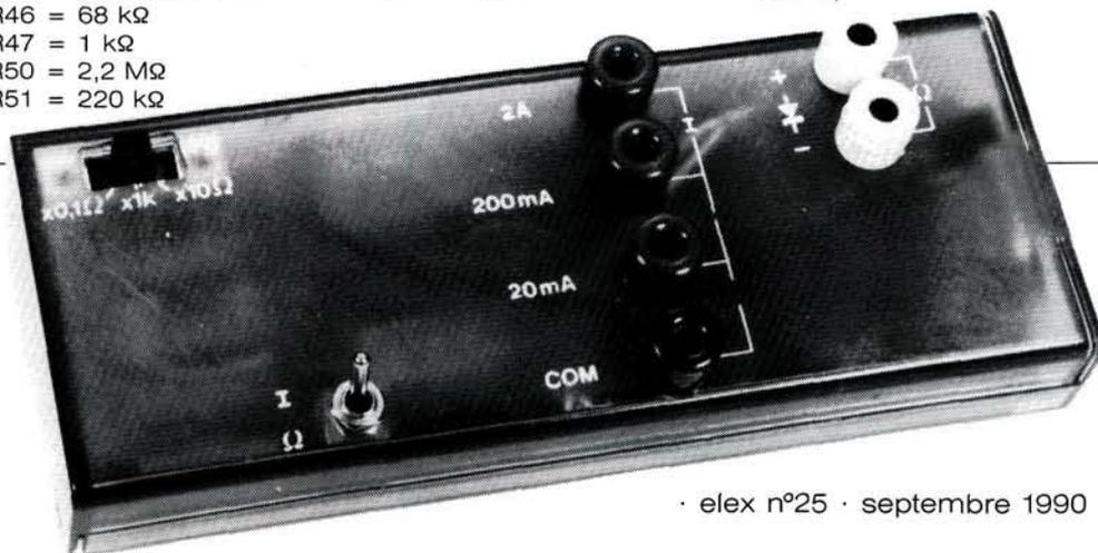
Commencez par mesurer leur valeur à l'aide du multimètre numérique et notez les tolérances éventuelles. Mettez l'ohmmètre dans le calibre  $\times 0,1$  et connectez la résistance de 150 ou 180  $\Omega$  aux douilles du voltmètre. C'est à P9 de vous permettre de compenser la différence éventuelle entre la valeur du multimètre de référence et votre ohmmètre.
