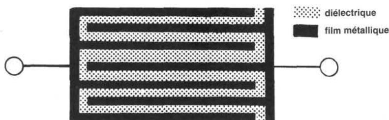
Figure 4 - Le diélectrique (c'est le nom de l'isolant des condensateurs) n'a pas comme seul rôle d'isoler les armatures, il joue un rôle important dans la détermination de la capacité.
