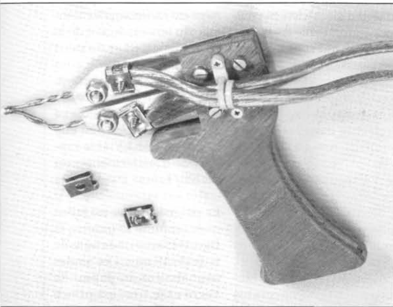
Figure 5 - Détail de la poignée du fer à souder maison. Les surfaces de contact entre la panne, la tôle d'aluminium les câbles est aussi grande que possible et le serrage énergique, tout cela pour limiter les pertes d'énergie. Les câbles sont serrés dans des cages pour vis à tôle. Si vous utilisez de l'aluminium anodisé, il faudra d'abord éliminer la couche d'alumine (hydroxyde d'aluminium) car elle est isolante. La panne chauffante est façonnée au marteau dans du fil de fer galvanisé.
