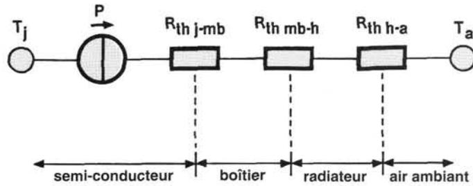
Figure 3 – Le transit de la chaleur depuis la source, le semi-conducteur, jusqu'à l'air ambiant se représente comme la circulation d'un courant électrique à travers des résistances.
