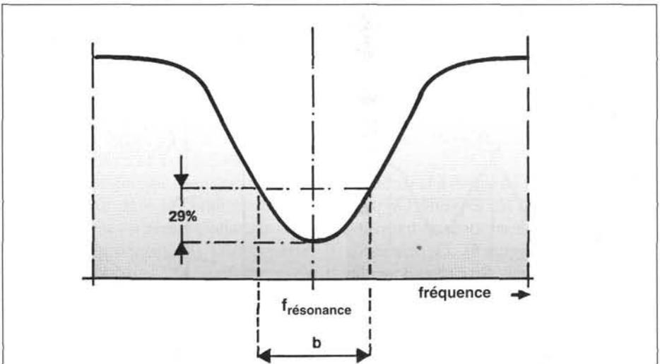
Figure 12 – Les composantes du signal de fréquence inférieure ou supérieure à la fréquence de résonance passent (presque) sans encombre. Le "marc" ici, ce sont les signaux proches de la fréquence de résonance.
