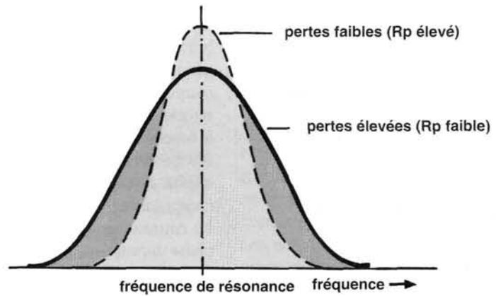
Figure 7 – La présence d'une résistance Rp, en parallèle avec la bobine et le condensateur, amortit la réponse du filtre qui est d'autant moins sélectif que cette résistance est moins élevée. On doit la prendre en compte dans tous les filtres LC parallèle où elle est d'autant plus petite (plus elle est petite, plus la courbe s'écrase) que la résistance ohmique de la bobine est plus grande.
