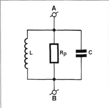
Figure 6 – Le circuit LC parallèle, tel qu'il est en réalité. La résistance est due aux imperfections des composants.
