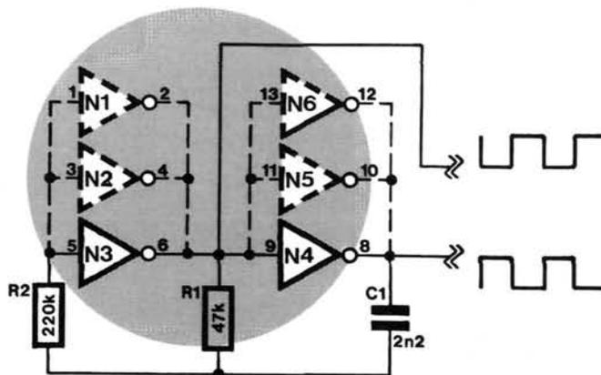
Figure 2 – Cette présentation permet de mieux distinguer le générateur de signaux rectangulaires et les deux sorties que nous en utilisons.
