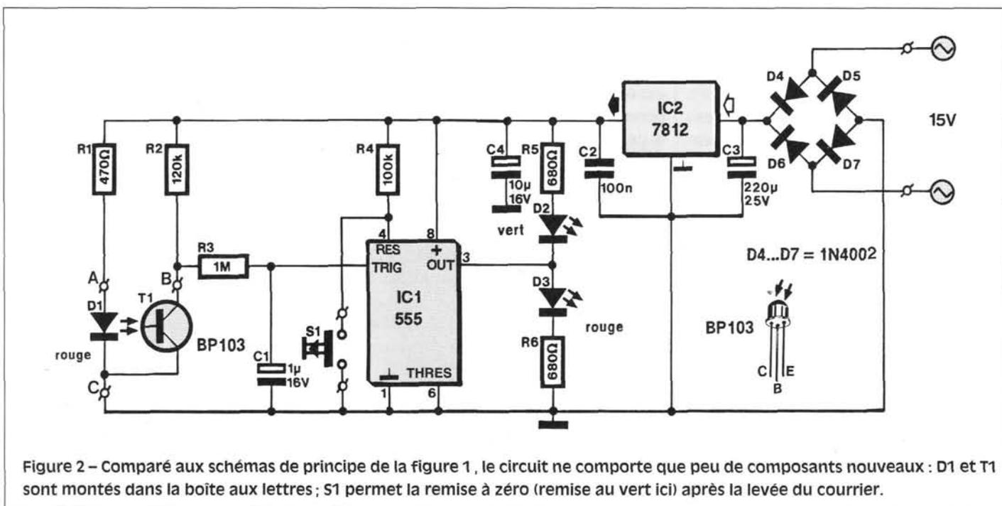
Figure 2 – Comparé aux schémas de principe de la figure 1, le circuit ne comporte que peu de composants nouveaux : D1 et T1 sont montés dans la boîte aux lettres ; S1 permet la remise à zéro (remise au vert ici) après la levée du courrier.
