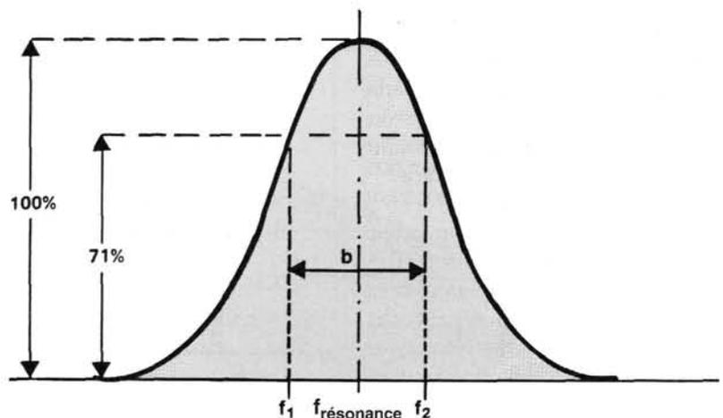
Figure 9 – La différence entre les fréquences de coupure haute (f2) et basse (f1) s'appelle bande passante à -3 dB. Une bande passante b étroite correspond à un dispositif sélectif. Les 3 dB correspondent à une division de la puissance par 2, soit à une division de la tension par la racine de 2. (Diviser par  $\sqrt{2}$  c'est multiplier par 0,71 à 1pp.)
