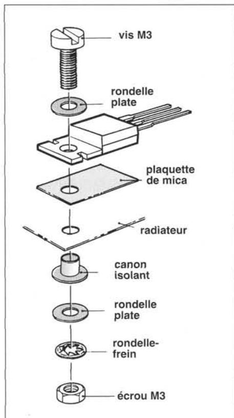
Figure 2 - Les boîtiers plats TO-126 et TO-220 sont plus simples à monter, parce qu'un seul trou suffit. La vis est portée au potentiel du collecteur; vous pouvez l'éviter en montant le canon isolant de l'autre côté.
