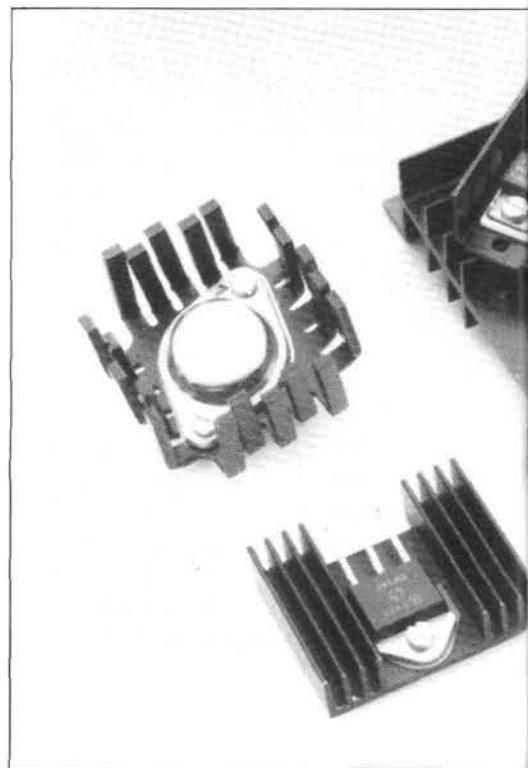
Nous relevons la valeur de  $R_{th\ j-mb}$  dans le tableau 1. Le symbole  $R_{th\ mb-h}$  représente la résistance thermique entre le boîtier et le radiateur (*heatsink*). Elle dépend de la façon dont le transistor est monté, isolé ou non, avec ou sans graisse conductrice de la chaleur. Le tableau 2 donne les résistances thermiques  $R_{th\ mb-h}$  boîtier-radiateur pour un transistor TO-3. Elles sont utilisables aussi, à peu de chose près, pour d'autres types de boîtiers.
