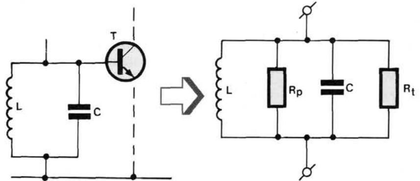
Figure 8 – Il ne faut pas négliger les dispositifs situés en aval du filtre qui introduisent des résistances en parallèle à celui-ci et atténuent sa réponse en fréquence.
