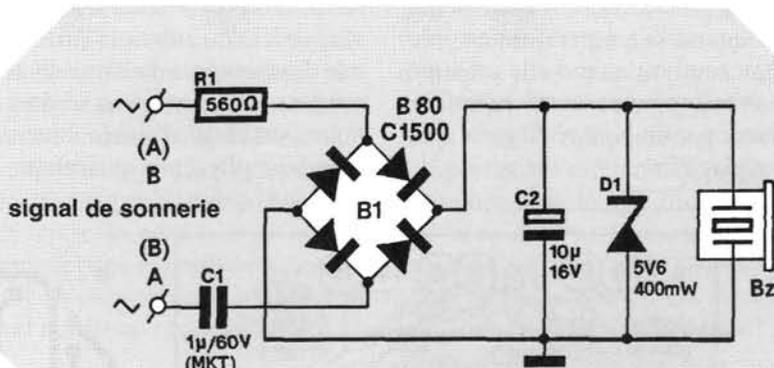
Figure 1 - Un condensateur pour limiter le courant et supprimer la composante continue du signal, un pont redresseur, un condensateur de lissage, une zener pour stabiliser la tension aux bornes d'un résonateur piézoélectrique à oscillateur intégré) : il n'en faut pas plus pour exploiter le signal de sonnerie du téléphone.
