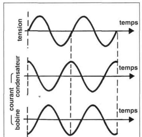
**Figure 5** – Tension aux bornes du circuit LC parallèle et courant circulant dans chaque branche, en fonction du temps.
