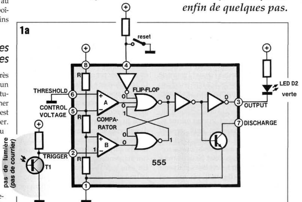
Figure 1 – Un détour par l'intérieur du 555 permet d'en comprendre le fonctionnement. En 1a, le circuit est en position d'attente, la LED rouge est allumée ; en 1b, elle est éteinte et la LED verte signale une ouverture de la boîte aux lettres, correspondant à un éclairage même transitoire du phototransistor. Le 555 "enregistre" ici le dépôt du courrier.
