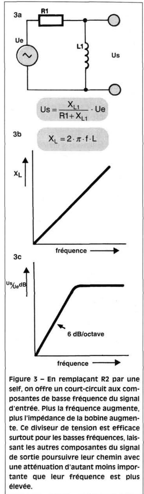
Figure 3 - En remplaçant R2 par une self, on offre un court-circuit aux composantes de basse fréquence du signal d'entrée. Plus la fréquence augmente, plus l'impédance de la bobine augmente. Ce diviseur de tension est efficace surtout pour les basses fréquences, laissant les autres composantes du signal de sortie poursuivre leur chemin avec une atténuation d'autant moins importante que leur fréquence est plus élevée.
