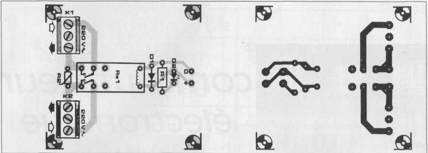
Figure 3 – Si vous ne gravez pas ce circuit imprimé, respectez les distances d'isolement entre les conducteurs, entre commande et puissance surtout (6 mm est un minimum). Ne laissez accessible aucune partie active et trouvez-lui un coffret convenable : en matériau isolant, jamais en métal.
