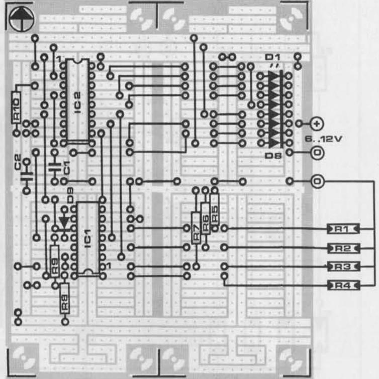
Figure 2 – L'implantation des composants sur une platine d'expérimentation de format 2. Les photo-résistances ne sont pas installées sur la même platine ; elles sont disposées sous le disque codeur, au grand air.
