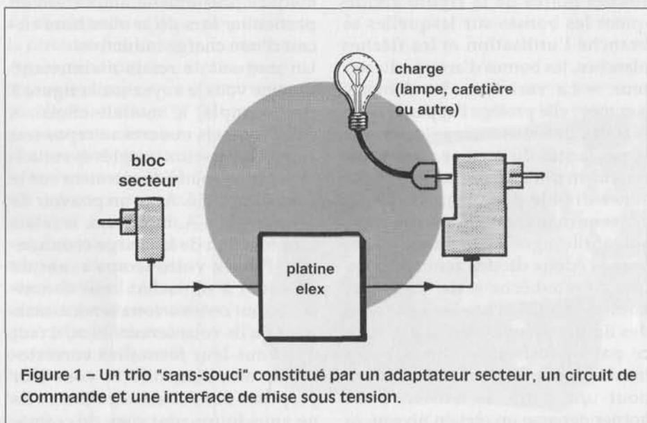
Figure 1 – Un trio "sans-souci" constitué par un adaptateur secteur, un circuit de commande et une interface de mise sous tension.
