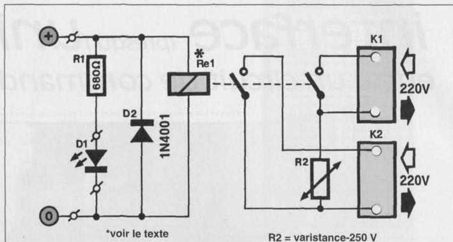
Figure 2 – La séparation galvanique est ici manifeste, de même que la liaison mécanique (en pointillés). La résistance R2 est une varistance, composant dont la résistance varie quand la tension à ses bornes dépasse une limite caractéristique : sa tension d'écrêtage. Elle protège, à la coupure en particulier, les contacts du relais contre les surtensions qui pourraient les détruire prématurément, de même que les appareils alimentés.
