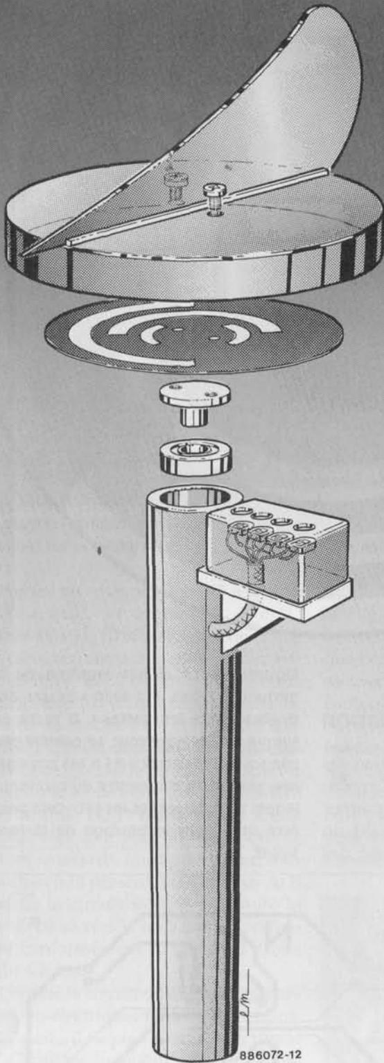
vents, soit en les raccordant par des fils sur une face avant séparée, soit en utilisant le circuit imprimé de la figure 4. Les photo-résistances seront montées sur une plaquette pastillée ordinaire de dimensions correspondant à celles du disque codeur.
