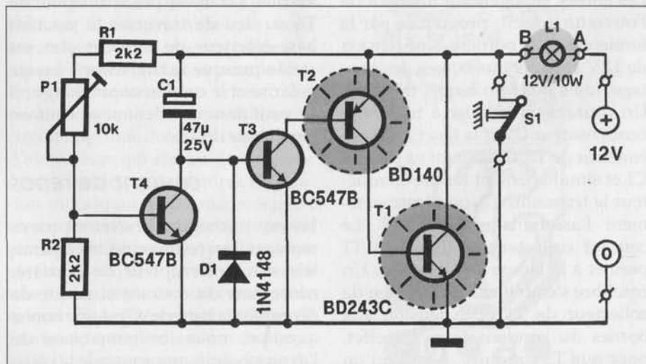
Figure 1 - Quatre transistors, dont trois jouent le rôle d'un seul, permettent de réaliser un temporisateur sans autre alimentation que celle que fournit la lampe à allumer.
