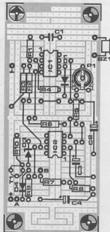
Figure 3 - Le circuit fonctionnera sans problème s'il est monté suivant le dessin ci-dessus. Il y a un piège pour le câbleur aussi : il faut utiliser du fil isolé pour réaliser certains des ponts, sous peine de court-circuit.
