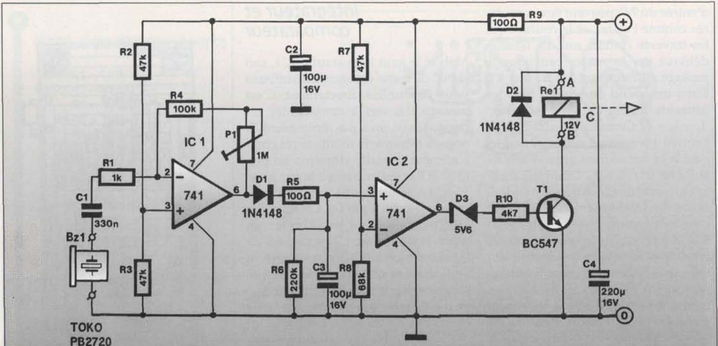
Figure 1 – La partie électronique du piège comporte un amplificateur inverseur (IC1) suivi par un intégrateur (D1/R5/R6/C3) et un comparateur (IC2). Le relais est détourné de sa fonction initiale: c'est seulement le mouvement de la palette mobile qui est utilisé.
