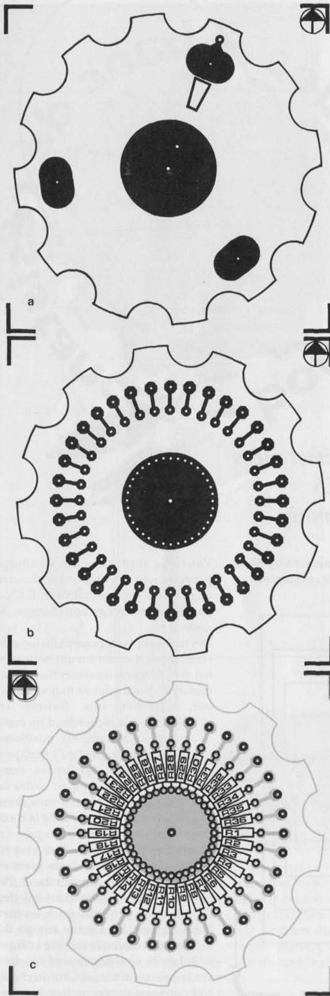
Figure 2 – Les deux circuits imprimés (a) et (b) forment les galettes du commutateur. Les résistances sont soudées sur la galette inférieure (b), dans l'ordre proposé en (c), qui permet d'utiliser le cadran de la figure 5. Il est aussi possible d'implanter ces composants du côté du cuivre, auquel cas la valeur de la résistance sélectionnée sera déchiffrée (code des couleurs), par la fenêtre de (a) qu'il faut évidemment percer.
