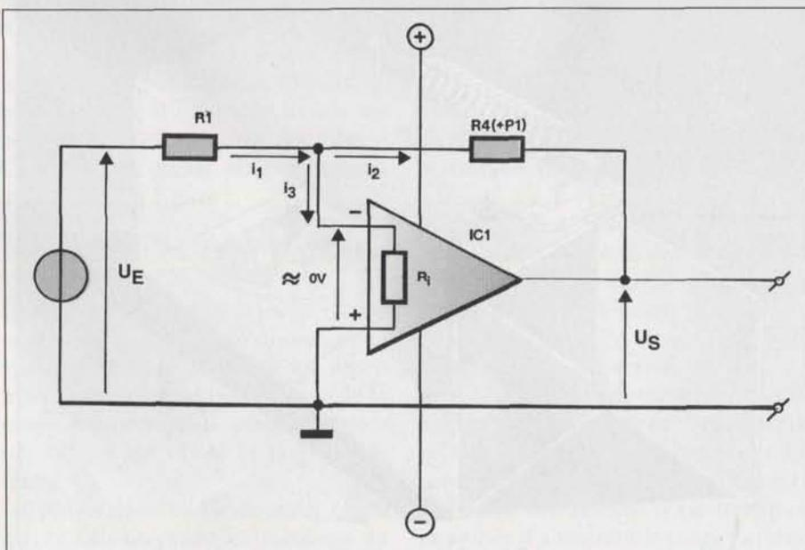
Figure 2 – Les courants et les tensions dans un amplificateur opérationnel monté en inverseur.
