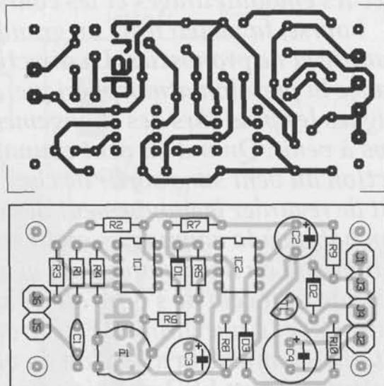
Figure 5 - Le circuit imprimé que vous pourrez graver si le perchlore ne vous rebute pas trop. Il ne comporte ni pont ni piège pour le câbleur.
