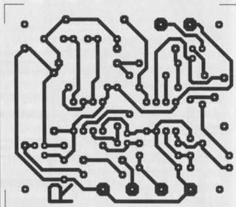
Figure 4 - Le circuit imprimé est, naturellement, moins encombrant que la platine d'expérimentation. Les réseaux de filtrage R9/C6 et R10/C7 ne sont nécessaires que si l'afficheur choisi est de type numérique.
