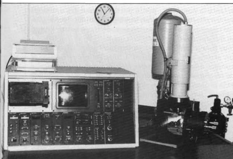
Figure 5 - Vue d'ensemble du microscope électronique. Sur la droite le microscope à proprement parler dont la porte est ouverte. Le tableau de commande, sur la gauche, permet de régler le grossissement, la qualité de l'image, la pompe à vide, les modes de balayage etc... C'est un peu différent d'un microscope optique.
