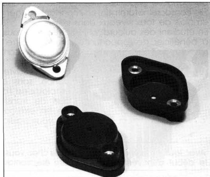
**Figure 11 - L'isolement total du boîtier peut être nécessaire lorsque le transistor est monté à l'extérieur d'un coffret comme c'est le cas par exemple sur certains amplificateurs de puissance. C'est possible grâce à ces capots en matière plastique.**
