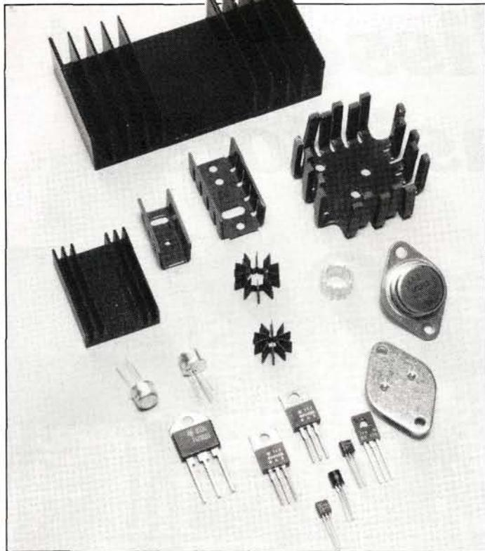
Figure 4 - Pour évacuer rapidement la chaleur, un transistor de puissance ne dispose pas d'une superficie de rayonnement suffisante; c'est pourquoi on le monte sur un radiateur à ailettes conçu pour activer l'échange thermique. Le choix du radiateur est traité ailleurs dans ce numéro. En règle générale on peut dire que plus la dissipation de puissance dans le transistor est forte, plus la superficie du radiateur doit être grande.
