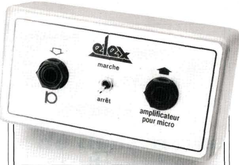
Figure 5. Les ronflements ne sont supprimés que si la platine est logée dans un boîtier métallique formant blindage . La photo montre le prototype.
