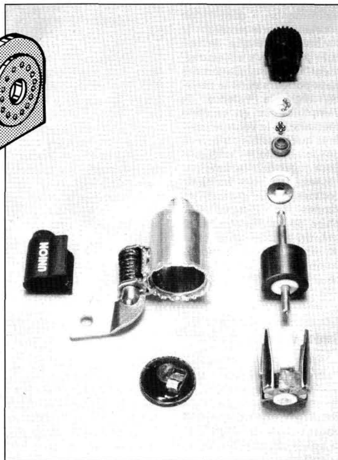
Figure 1 - Les constituants (pluviôse 1989 oblige) de la dynamo. Le cylindre aimanté est entraîné par le pneu. Il tourne entre les deux groupes d'ailettes de la bobine. Ces révolutions provoquent des variations de champ magnétique, nécessaires et suffisantes pour faire naître une tension électrique aux bornes de la bobine.
