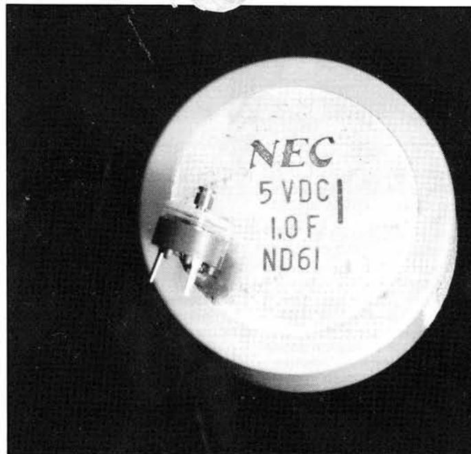
Figure 10 - La pièce de 20 centimes permet de se faire une idée de la taille du condensateur-bouton ultra-plat, conçu notamment pour les circuits alimentés par cellules solaires. Le nombre de cycles charge-décharge annoncé par le fabricant dépasse les 100 000; sa plage de température est remarquablement vaste puisqu'elle s'étend de -25 °C à +70 °C. La tension de service maximale est de 2,4 V. Les pointes de tension jusqu'à 2,8 V sont admises. Et la capacité? direz-vous...
