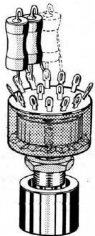
Figure 6 - Inutile de monter le réglage de balance sur un circuit imprimé: les résistances peuvent être soudées directement sur les commutateurs. Cela fera un excellent exercice de soudage et de câblage.
