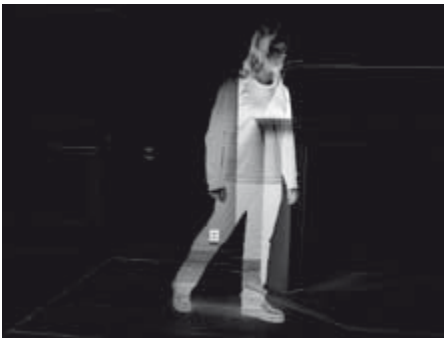
Figure 3. L'image différentielle est engendrée en soustrayant les valeurs de gris. Les valeurs négatives sont rejetées.
