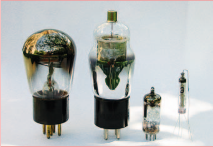
Figure 1. Quatre pentodes : RES164, 34, EF97 et 1Ж18Б (de gauche à droite). Le modèle EF97 à basse tension fonctionne avec seulement 6 V sur sa « plaque ».
