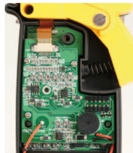
Figure 4. Une pince ampèremétrique est un instrument compliqué avec de nombreux points de réglage. Dans ce modèle, nous avons compté une quinzaine de potentiomètres ajustables !
