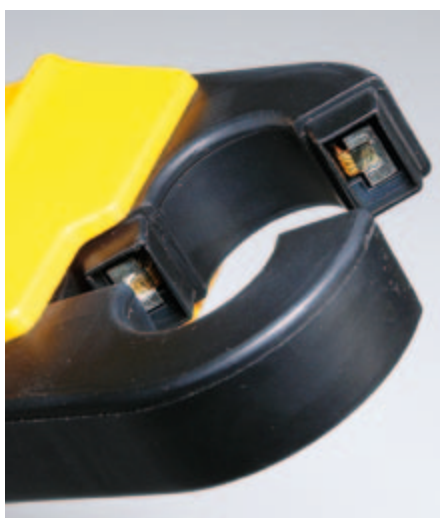
Figure 2. Dans cette pince ampèremétrique Fluke, les deux capteurs à effet Hall sont visibles dans les entrefers du noyau.
