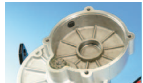
Figure 9. Position correcte du trou de montage du capteur de roue dentée sur l'Elektor-Wheelie.
