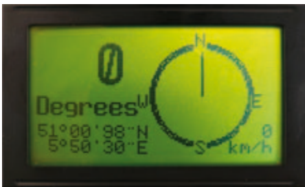
Figure 7. Affichage « boussole » de la direction du mouvement.
