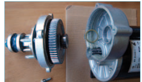
Figure 8. Après avoir retiré les quatre vis du couvercle du motoréducteur, écartez le couvercle avec l'arbre et la roue dentée du moteur.
