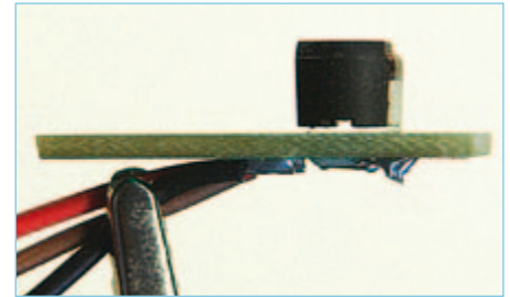
Figure 7. Montage du capteur sur sa platine.
