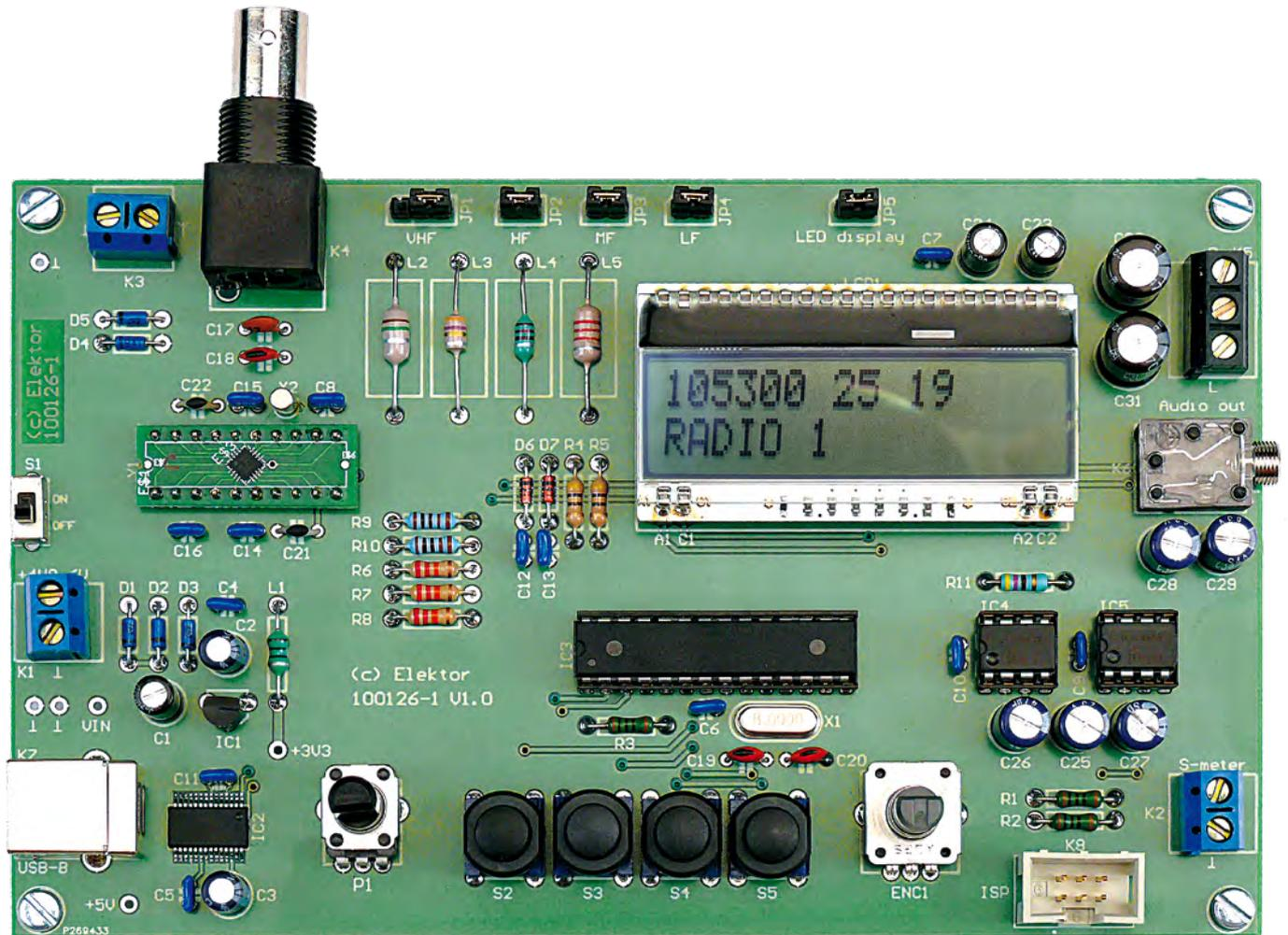
Un récepteur de radio mondial qu'il ne faut pas aligner ? Oui, le traitement numérique du signal (DSP, *digital signal processing* outre-Manche) le permet ! Tout le nécessaire est fondu dans une puce radio DSP, elle s'appelle Si4735 et ne mesure que 3 mm x 3 mm. Ajoutons-y une interface de commande avec écran LCD, un amplificateur stéréo à BF et l'interface USB désormais inéluctable pour ceux qui préfèrent piloter le récepteur par leur PC.
