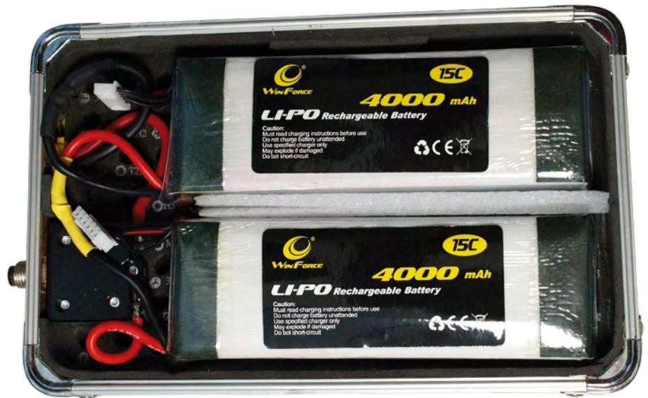
Figure 1. Deux accumulateurs Li-Po chinois 5s en série avec un fusible dans un boîtier d'aluminium et fournissant l'énergie nécessaire à l'assistance électrique d'un vélo.
