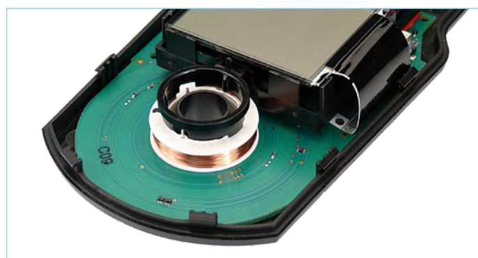
Figure 2 – Les détecteurs de conduites Bosch et Skil ont recours à une bobine orientée vers le mur pour détecter plus exactement les métaux. Les pistes imprimées autour constituent le capteur capacitif pour la détection du bois.
