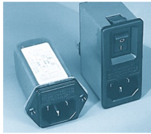
Un filtre secteur standard avec une entrée secteur euro, un interrupteur marche/arrêt et un filtre efficace. Son enveloppe en métal doit être reliée au métal du boîtier.
