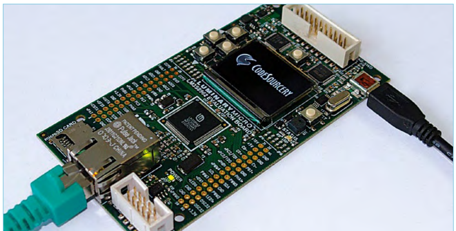
Figure 4. FreeRTOS, qui est soumis à la GPL, est aussi offert (en sus des systèmes d'exploitation commerciaux) avec le kit d'évaluation Ethernet LM3S8962 de l'entreprise Luminary.
