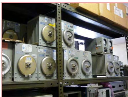
Ils étaient donc par là (2)... des wattmètres RF de différents modèles et de marque Bird, leader du marché.
