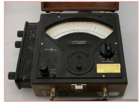
Rare et « vintage » à souhait : milliampèremètre CC, The Sensitive Research Instrument Corporation (La Rochelle, NY).
