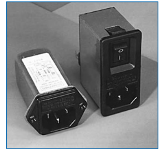
Exemple de filtre secteur standard. Il comporte une entrée secteur euro, un interrupteur marche/arrêt et un filtre efficace. Son enveloppe en métal doit être reliée au métal du boîtier.
