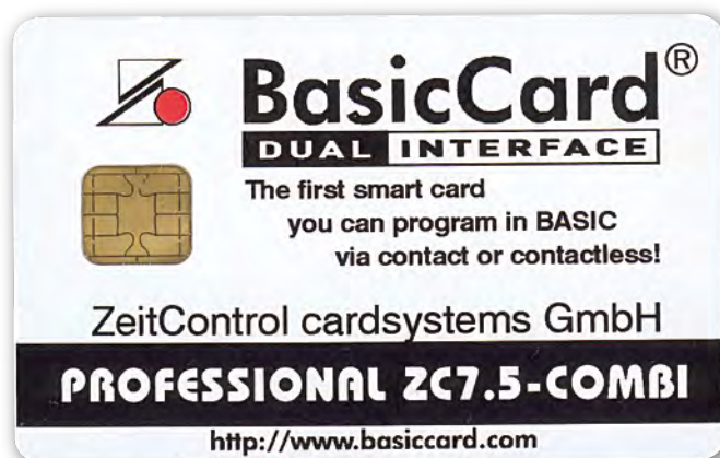
Figure 1. La BasicCard à double interface, à la fois à contacts et contactless .
