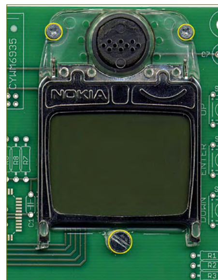
Figure 6. L'afficheur se fixe par deux boulons M2 et un boulon M3 sur le circuit imprimé.
