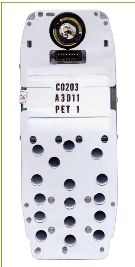
Figure 4. Le module d'affichage se compose de l'afficheur proprement dit et de touches.
